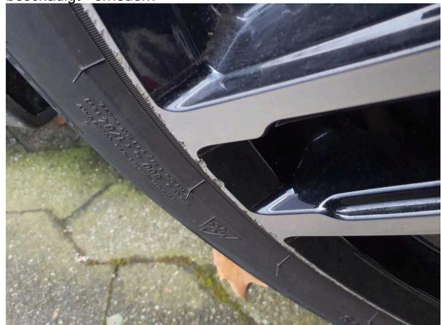
**Beschädigung #5:** Rad/Reifen: Leichtmetallfelge vorn rechts - beschädigt - erneuern
