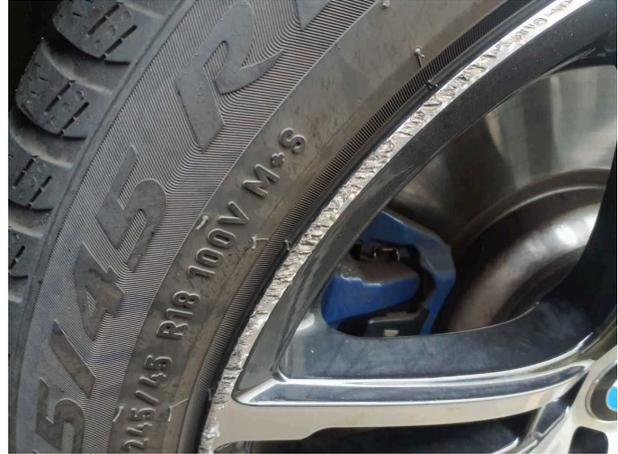
**Beschädigung #4:** Rad/Reifen: Leichtmetallfelge hinten links - beschädigt - erneuern
