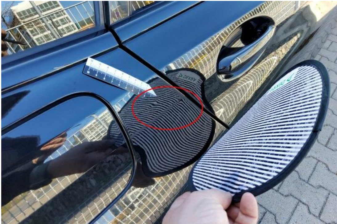
Bild 11 : Seitenteil hinten rechts, mehrfach eingedellt, drücken
