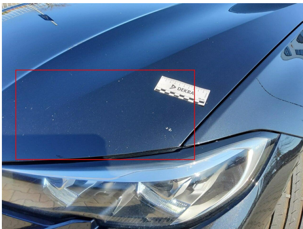
Bild 8 : Motorhaube Lackierung, Steinschlag, lackieren mit Lackaufbau
