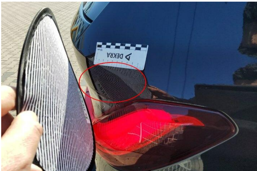
Bild 10 : Seitenteil hinten rechts, mehrfach eingedellt, drücken
