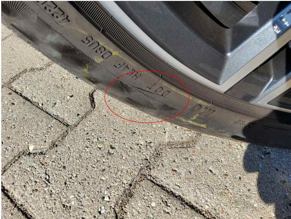
Bild 25 : Reifen vorn links mit zusätzlicher Beschädigung an der Reifenflanke
