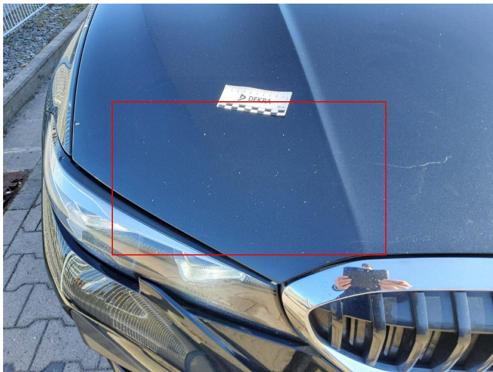
Bild 6 : Motorhaube Lackierung, Steinschlag, lackieren mit Lackaufbau
