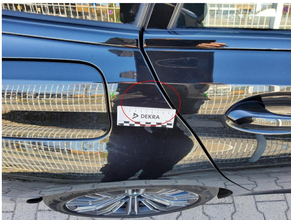
Bild 14 : Seitenteil hinten rechts Lackierung unterhalb, zerkratzt, smart repair
