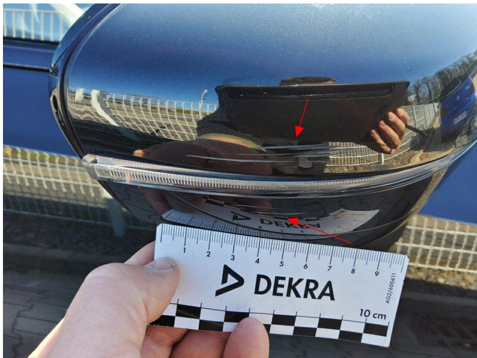
Bild 16 : Außenspiegel rechts Lackierung, zerkratzt, lackieren
