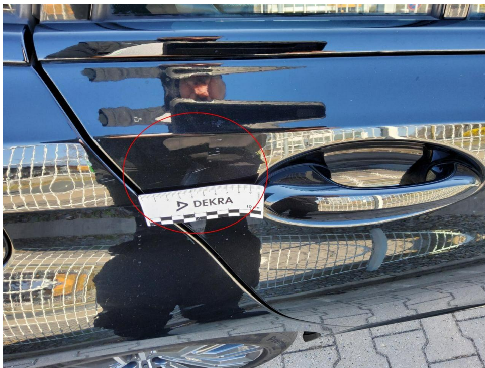
Bild 20 : Tür hinten rechts Lackierung, zerkratzt, smart repair
