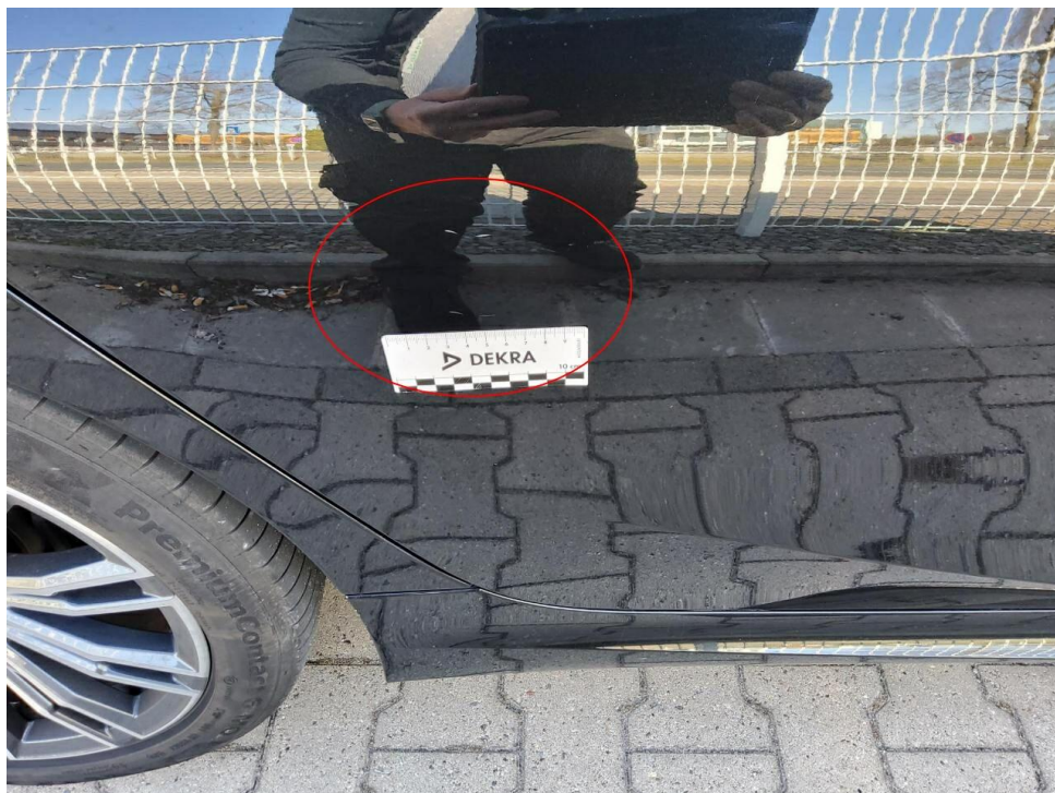
Bild 18 : Tür hinten rechts Lackierung, zerkratzt, smart repair
