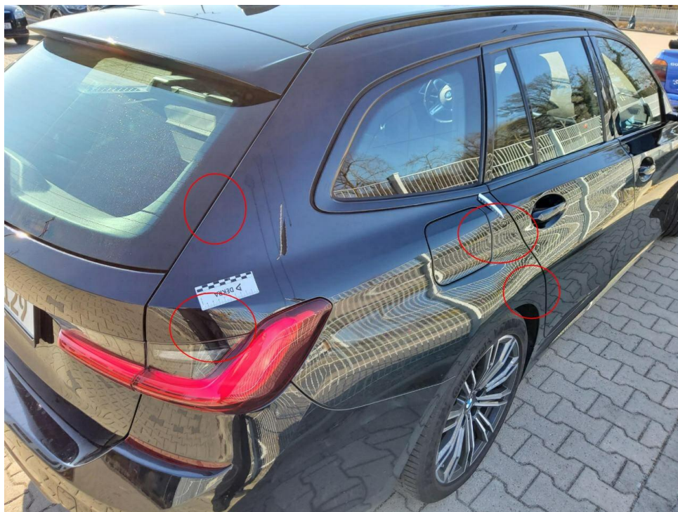
Bild 9 : Seitenteil hinten rechts, mehrfach eingedellt, drücken
