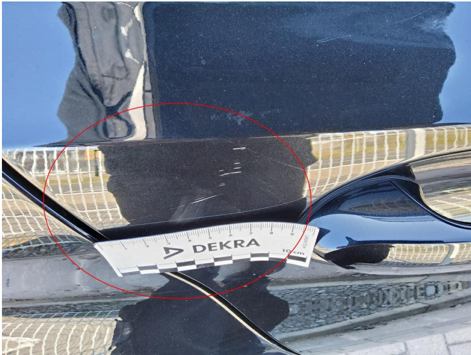
Bild 21 : Tür hinten rechts Lackierung, zerkratzt, smart repair
