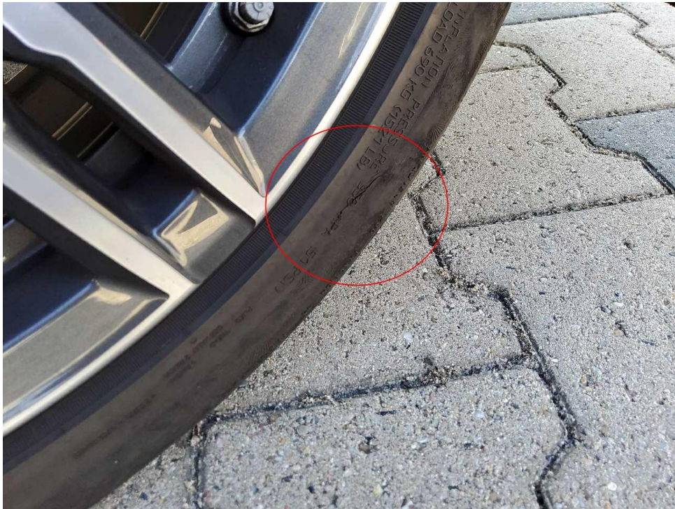
Bild 27 : Reifen vorn rechts mit zusätzlicher Beschädigung an der Reifenflanke
