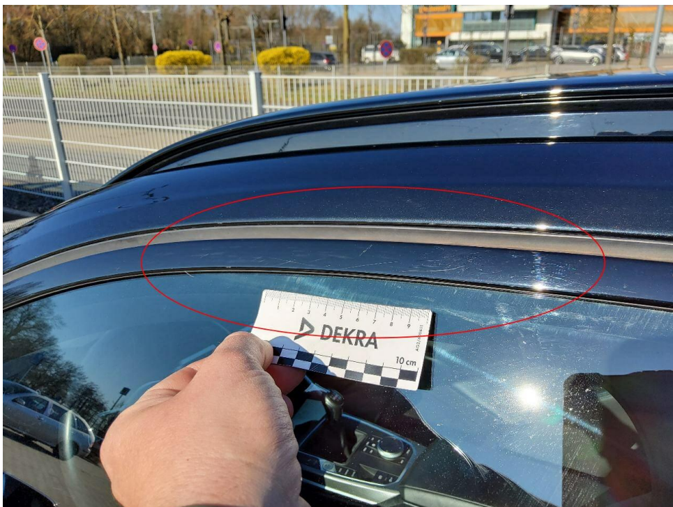
Bild 22 : Tür vorn links, Rahmenzierleiste, verkratzt
