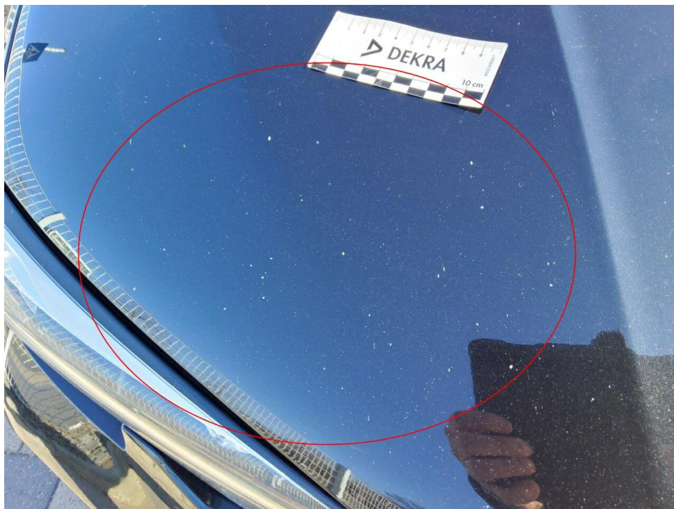
Bild 7 : Motorhaube Lackierung, Steinschlag, lackieren mit Lackaufbau
