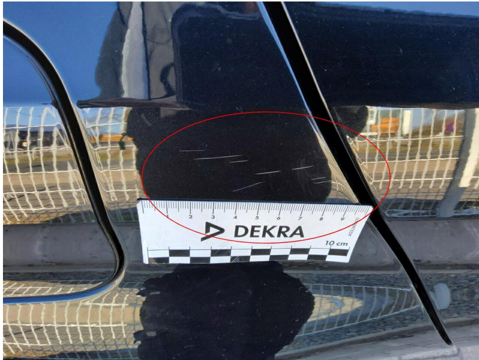
Bild 15 : Seitenteil hinten rechts Lackierung unterhalb, zerkratzt, smart repair
