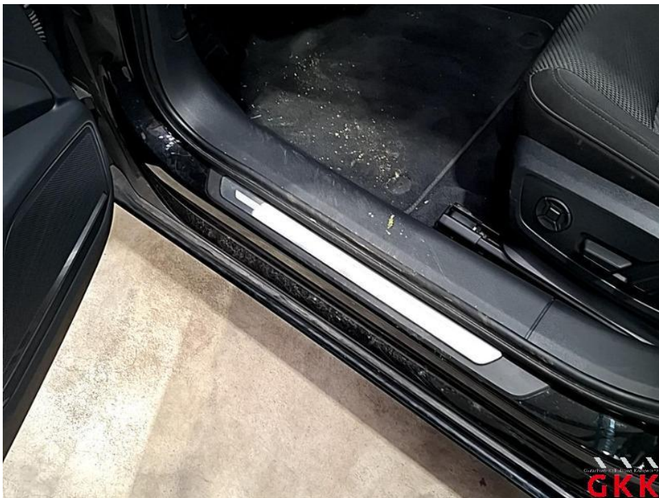
Bild 22. Tür vorne links, Einstieg, verkratzt, Smartrepair
