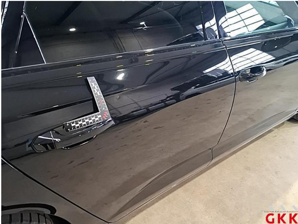
Bild 46. Tür hinten rechts, beschädigt, instand setzen - lackieren
