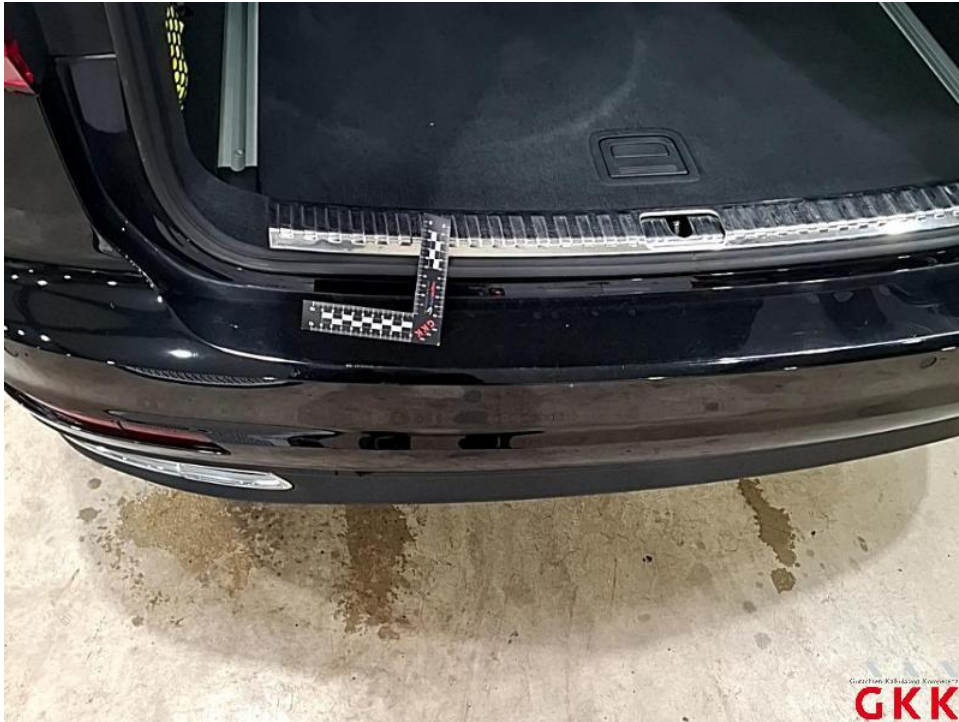
Bild 31. Stoßfänger hinten, Verkleidung -lackiert-, beschädigt, lackieren
