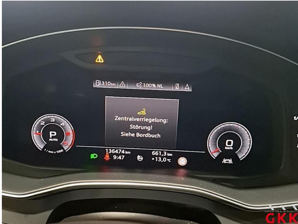
Bild 13. Schließanlage, funktionsuntüchtig, prüfen
