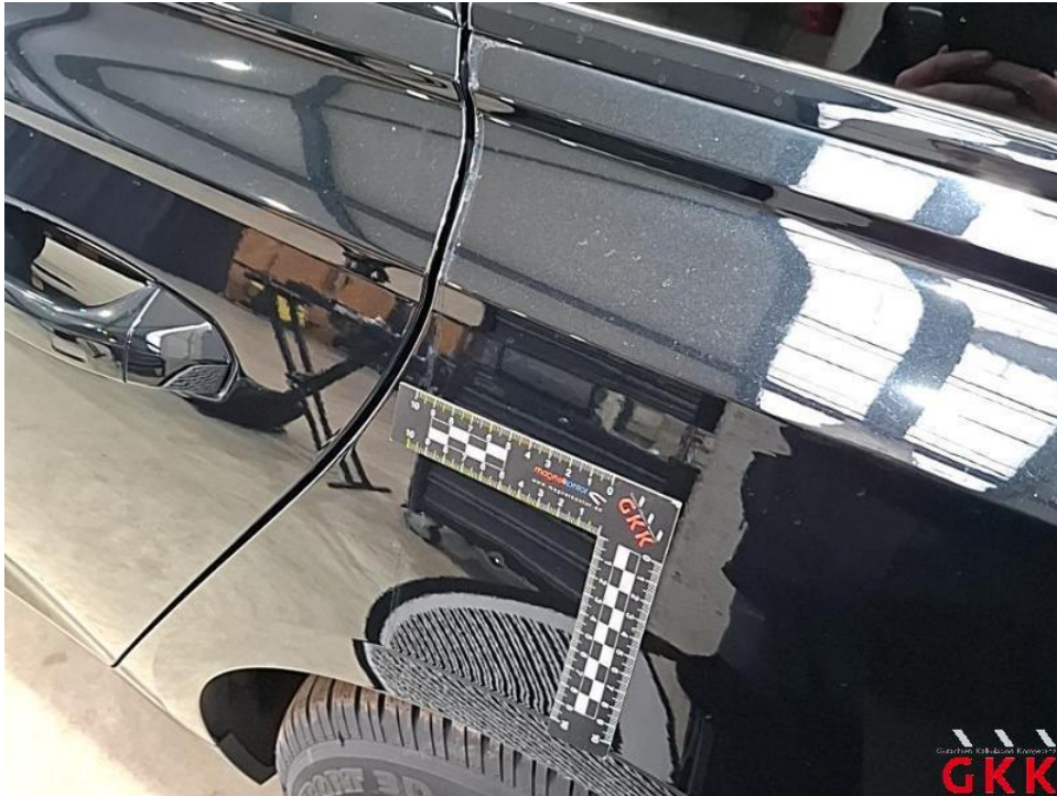
Bild 29. Seitenwand links, bis 3 Dellen / Bauteil, kalt drücken
