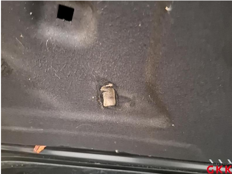
Bild 15. Motorhaube, Dämmmatte, beschädigt, ersetzen
