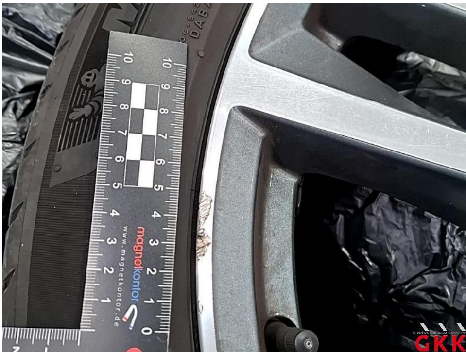
Bild 36. LM-Rad, 1 x beiliegend, Materialabtrag, ersetzen
