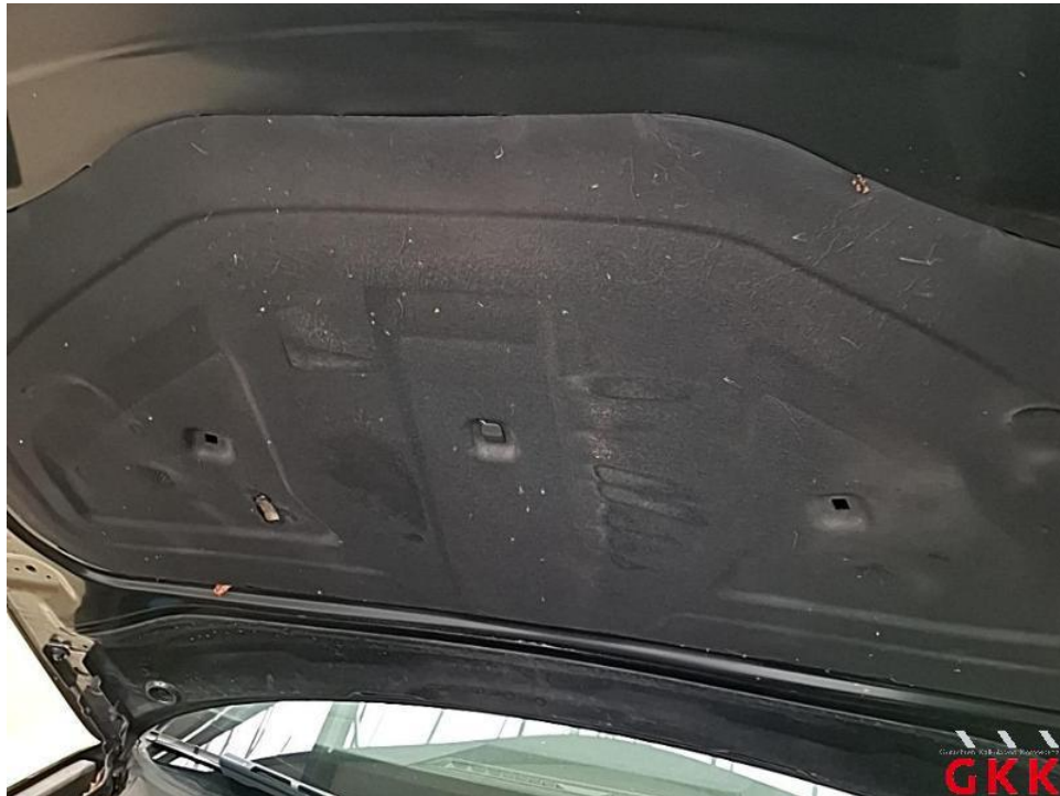
Bild 14. Motorhaube, Dämmmatte, beschädigt, ersetzen
