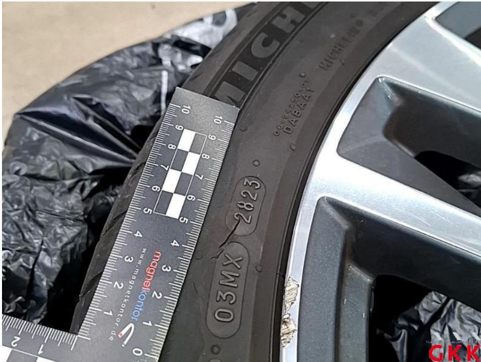
Bild 38. Reifen, 1 x beiliegend, beschädigt, ersetzen
