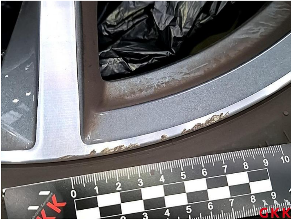
Bild 45. LM-Rad, 1 x beiliegend, Materialabtrag, ersetzen
