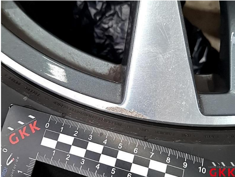
Bild 43. LM-Rad, 1 x beiliegend, Materialabtrag, ersetzen
