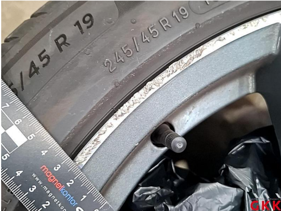
Bild 41. LM-Rad, 1 x beiliegend, Materialabtrag, ersetzen
