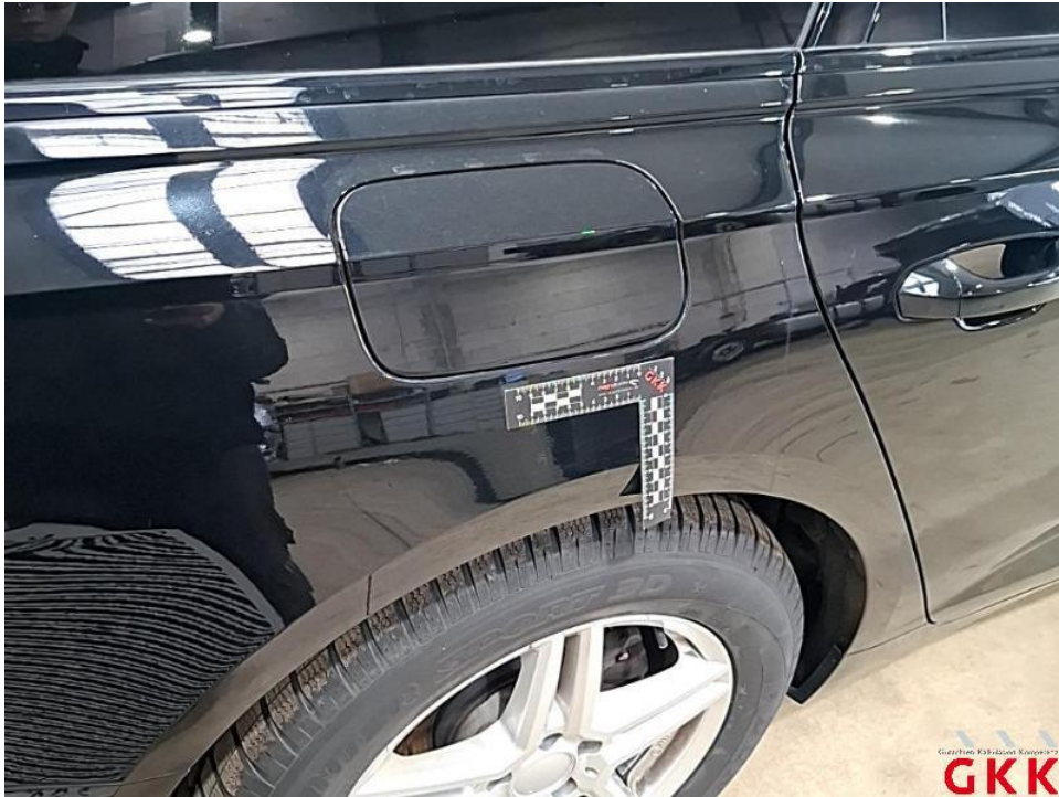
Bild 33. Seitenwand rechts, bis 3 Dellen / Bauteil, kalt drücken
