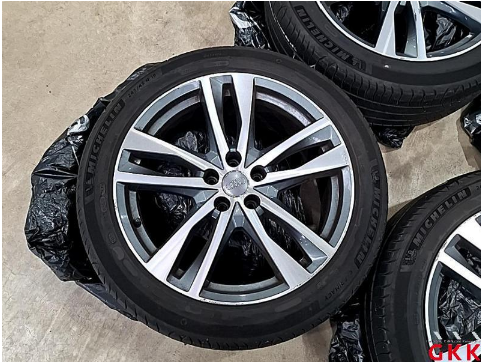
Bild 35. LM-Rad, 1 x beiliegend, Materialabtrag, ersetzen
