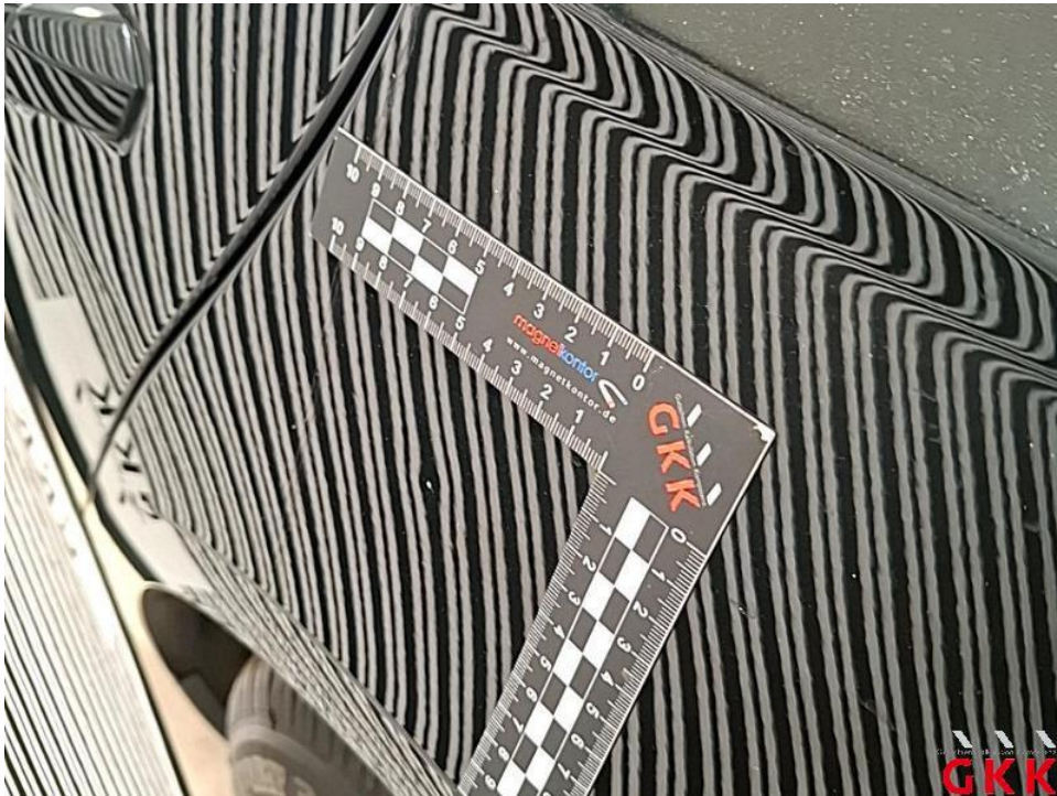
Bild 30. Seitenwand links, bis 3 Dellen / Bauteil, kalt drücken
