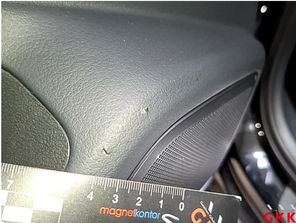
Bild 28. Tür hinten links, Innenverkleidung -Leder-, beschädigt, Smartrepair
