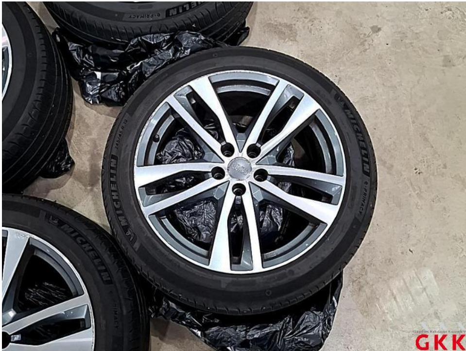
Bild 40. LM-Rad, 1 x beiliegend, Materialabtrag, ersetzen
