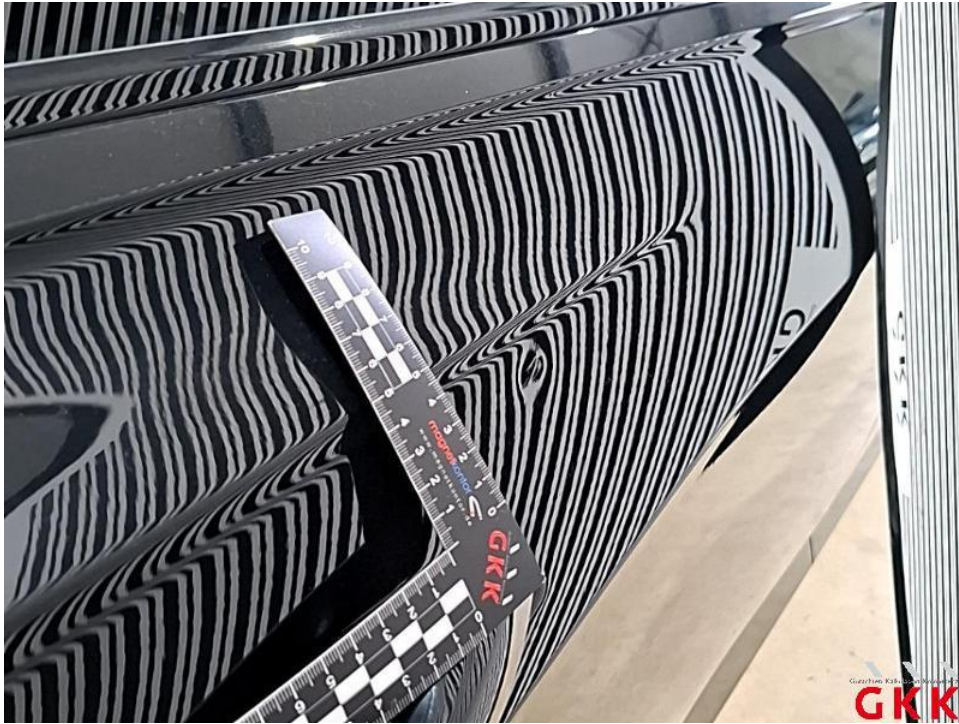
Bild 47. Tür hinten rechts, beschädigt, instand setzen - lackieren
