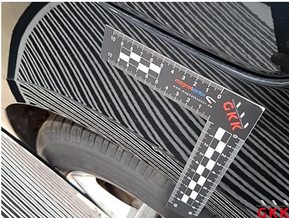
Bild 34. Seitenwand rechts, bis 3 Dellen / Bauteil, kalt drücken
