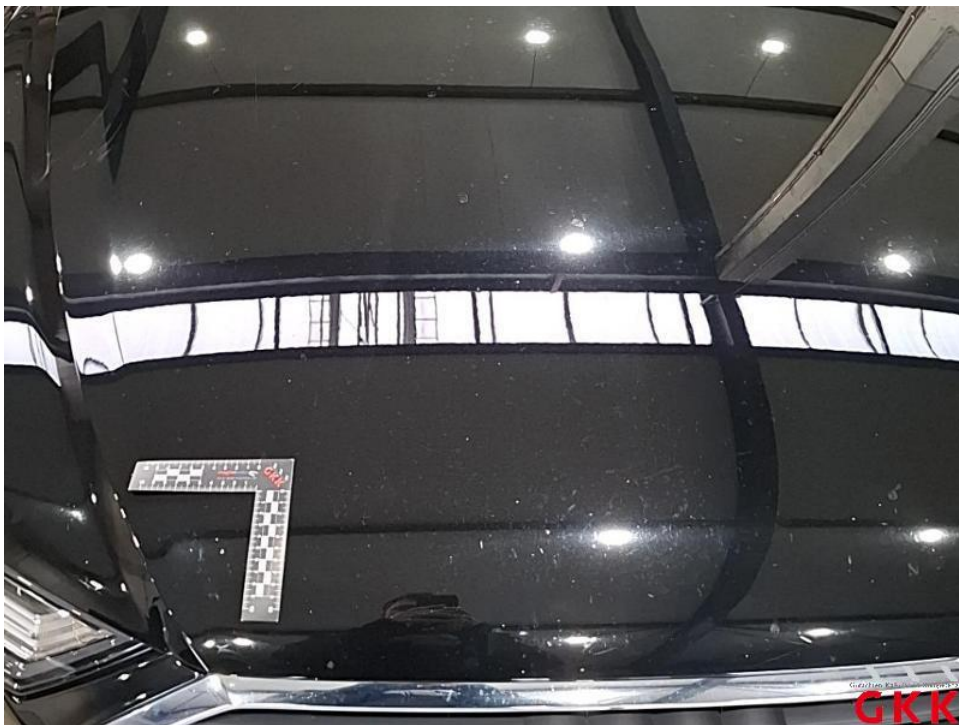
Bild 16. Motorhaube, Steinschlag und Kratzer, lackieren
