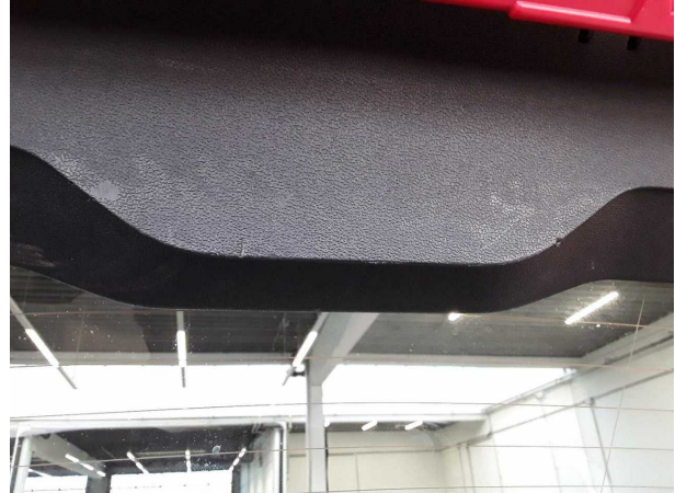
Beschädigung #8: Verkleidungen/Abdeckungen: Kofferraumverkleidung - verkratzt / verschürft - Wertminderung
