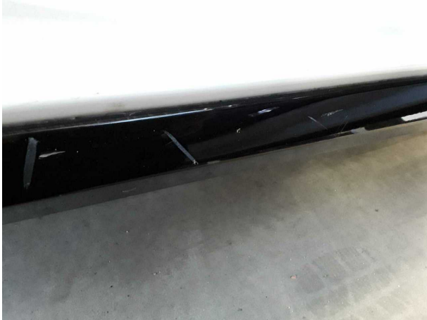
Beschädigung #2: Schweller rechts: Verkleidung - Kratzer - Smart Repair
