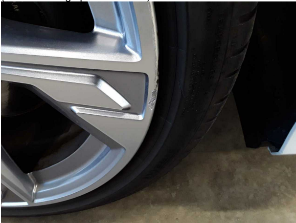
Beschädigung #12: Rad/Reifen: Leichtmetallfelge vorn rechts (Materialabtrag optisch zu hoch) - verkratzt / verschürft - erneuern
