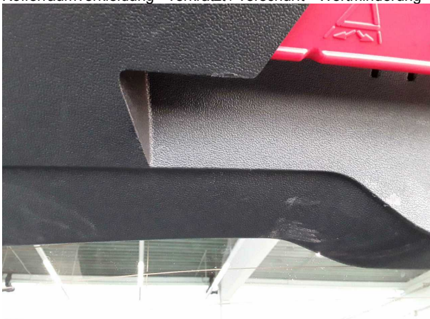
Beschädigung #8: Verkleidungen/Abdeckungen: Kofferraumverkleidung - verkratzt / verschürft - Wertminderung
