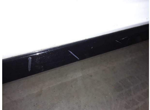
Beschädigung #2: Schweller rechts: Verkleidung - Kratzer - Smart Repair
