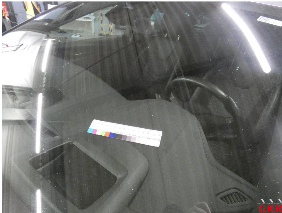
Bild 18 Frontscheibe, beheizt mit Regensensor und Frontkamera, Steinschlag im Sichtfeld, ersetzen
