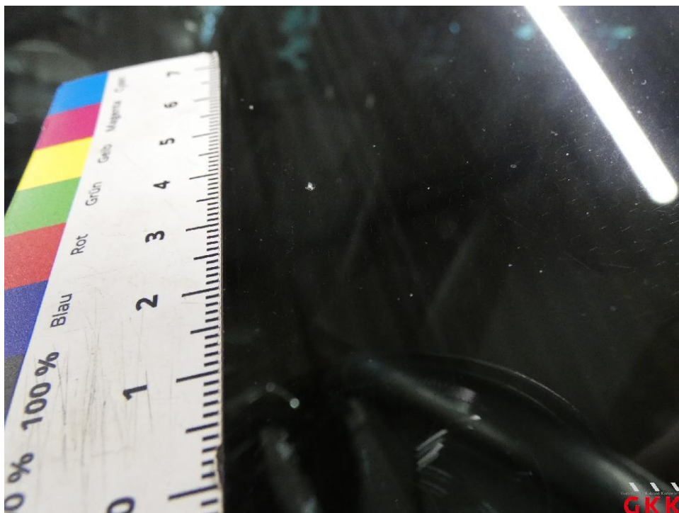
Bild 20 Frontscheibe, beheizt mit Regensensor und Frontkamera, Steinschlag im Sichtfeld, ersetzen
