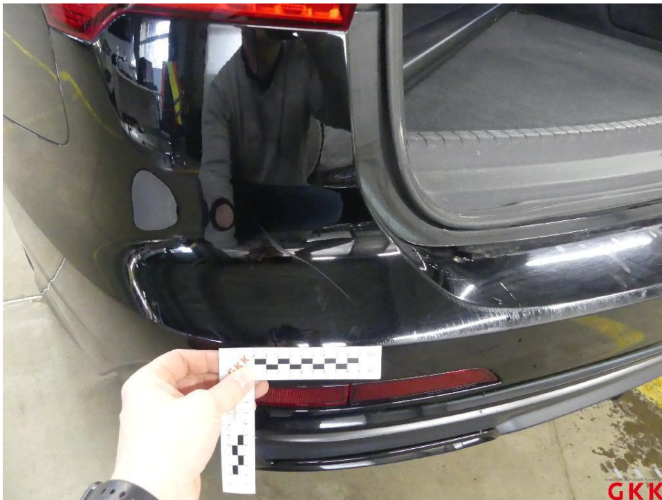
Bild 30 Stoßfänger hinten, Verkleidung -lackiert-, verkratzt, lackieren
