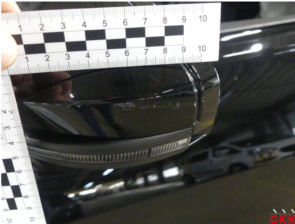
Bild 22 Spiegelgehäuse links, Kappe -lackiert-, verkratzt, lackieren ohne LV
