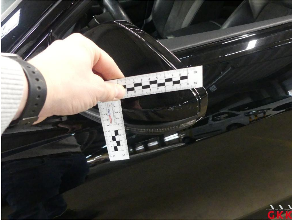
Bild 21 Spiegelgehäuse links, Kappe -lackiert-, verkratzt, lackieren ohne LV
