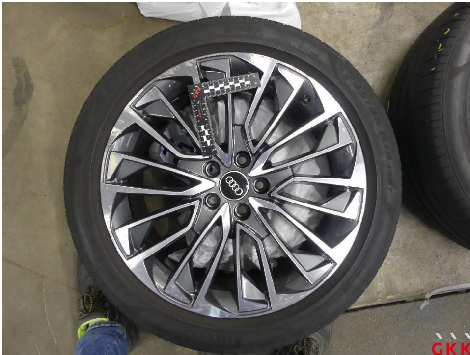
Bild 18 LM-Rad, 1 x beiliegend, verkratzt, ersetzen
