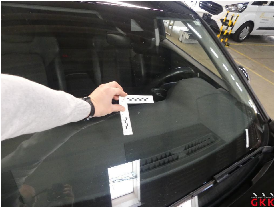
Bild 15 Frontscheibe, mit Regensensor und Frontkamera, Steinschlag mit Rissbildung, ersetzen
