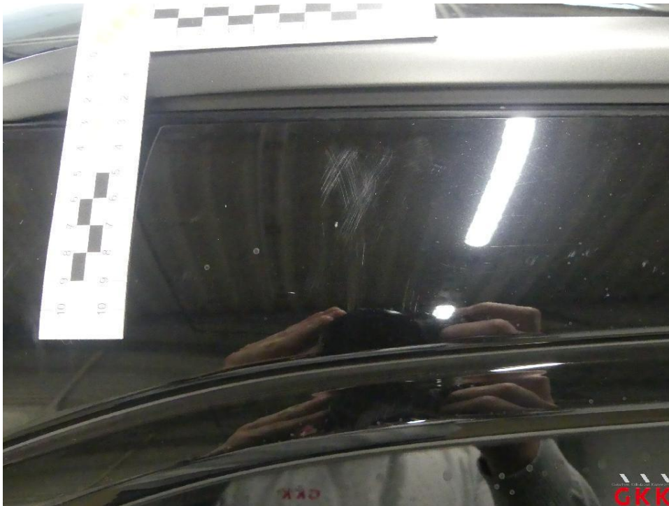
Bild 29 Dach, Holm rechts, verkratzt, Smartrepair
