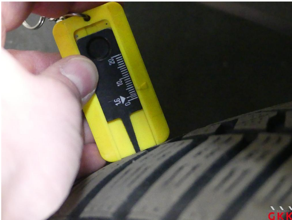
Bild 34 Reifen, vorn links und rechts, Untermaß, ersetzen
