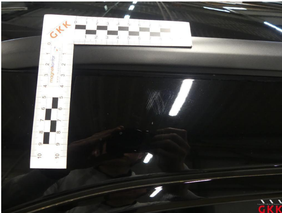
Bild 28 Dach, Holm rechts, verkratzt, Smartrepair
