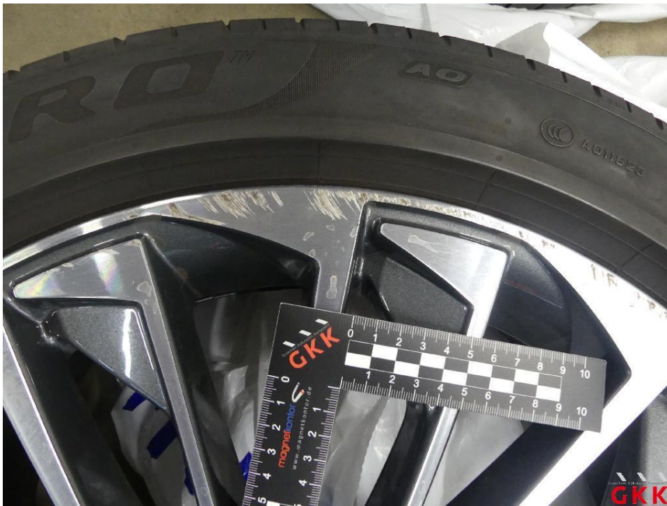
Bild 20 LM-Rad, 1 x beiliegend, verkratzt, ersetzen
