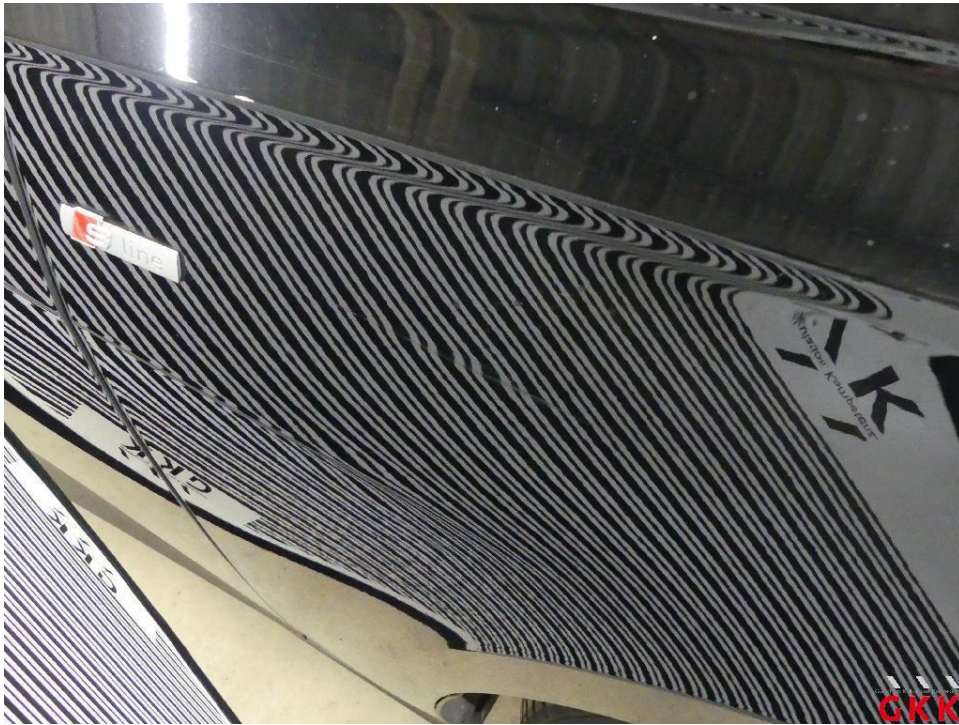
Bild 25 Kotflügel vorne rechts, beschädigt, instand setzen - lackieren
