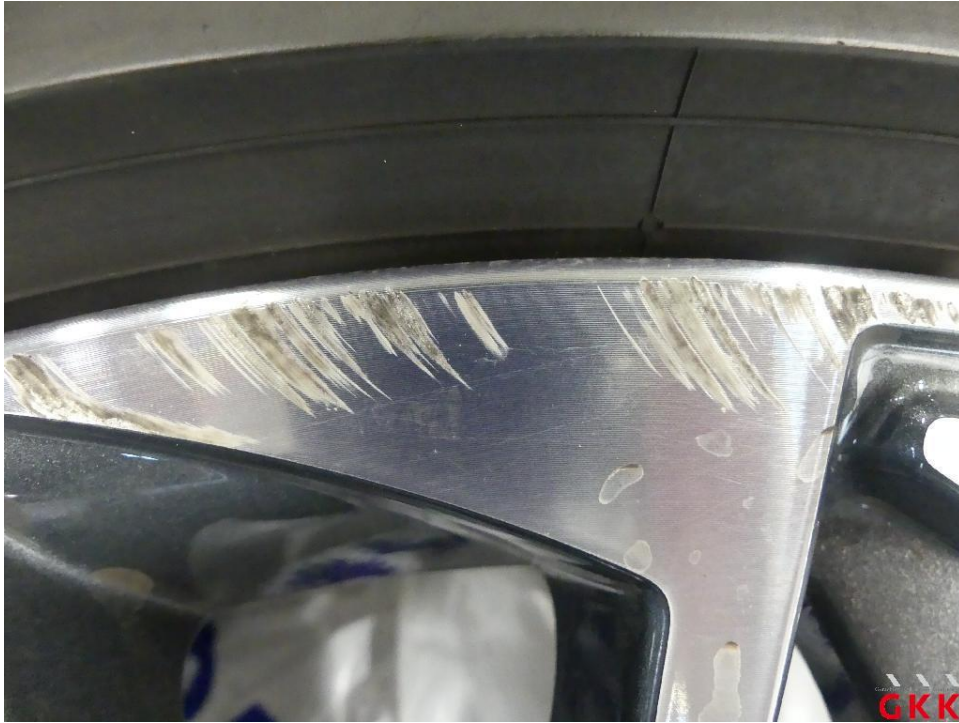
Bild 19 LM-Rad, 1 x beiliegend, verkratzt, ersetzen
