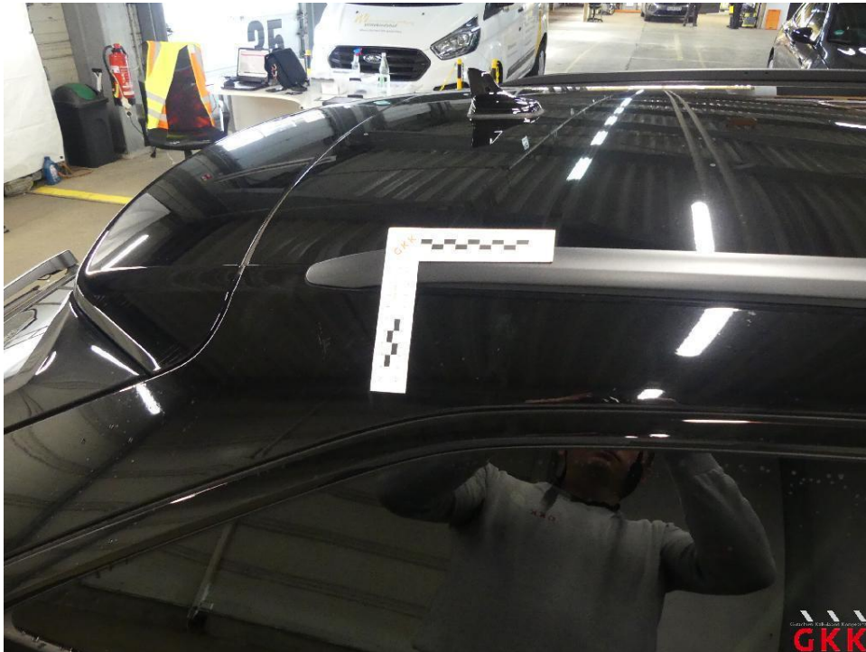
Bild 27 Dach, Holm rechts, verkratzt, Smartrepair
