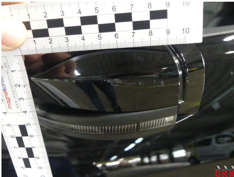
Bild 23 Spiegelgehäuse links, Kappe -lackiert-, verkratzt, lackieren ohne LV
