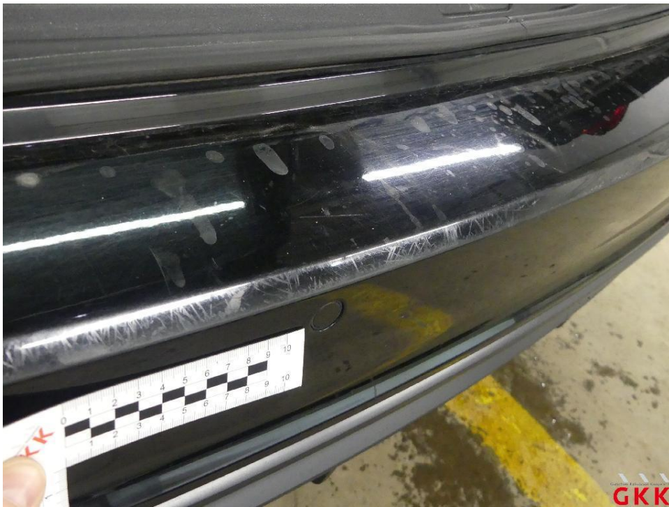
Bild 32 Stoßfänger hinten, Verkleidung -lackiert-, verkratzt, lackieren
