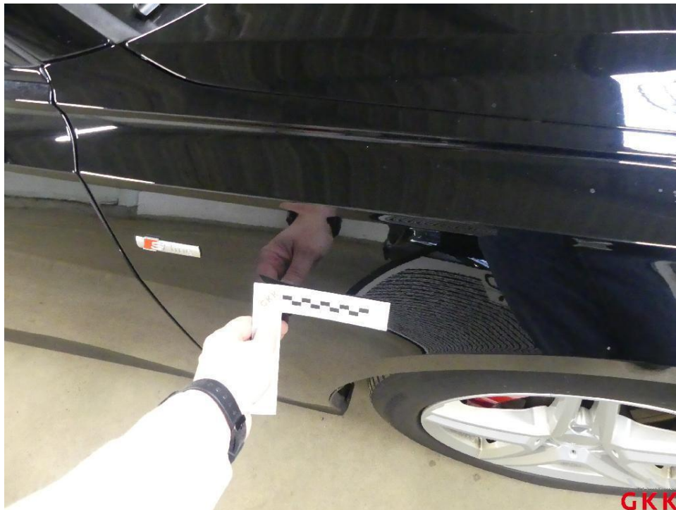
Bild 24 Kotflügel vorne rechts, beschädigt, instand setzen - lackieren
