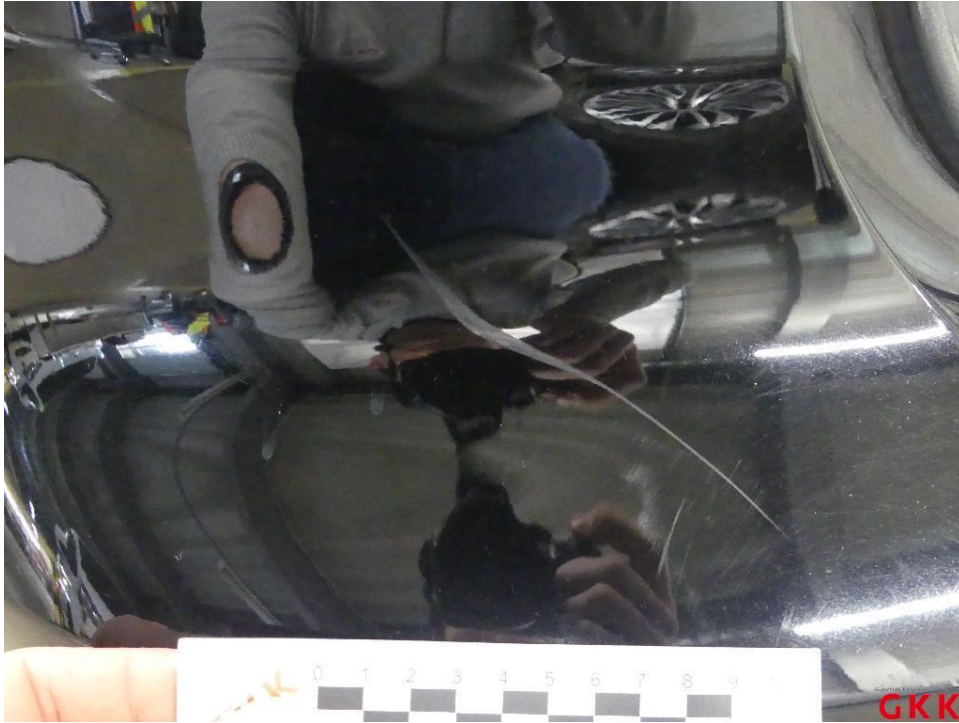
Bild 31 Stoßfänger hinten, Verkleidung -lackiert-, verkratzt, lackieren
