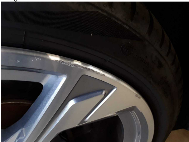
Domage #9: Roue / Pneumatiques: Jante alliage arrière droite (Materialabtrag optisch gering) - Erafilé - Diminution de valeur
