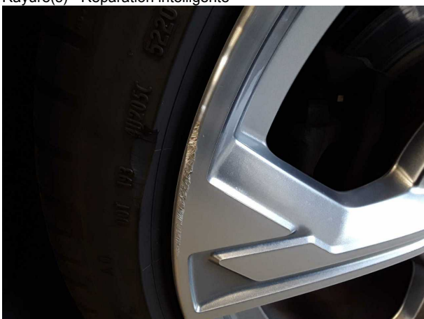
Damage #7: Roue / Pneumatiques: Jante alliage arrière gauche (Materialabtrag optisch zu hoch) - Eraflé - Diminution de valeur
