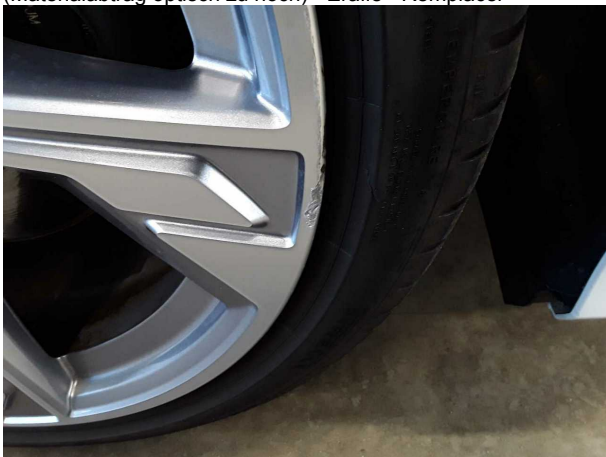
Domage #12: Roue / Pneumatiques: Jante alliage avant droite (Materialabtrag optisch zu hoch) - Eraflé - Remplacer
