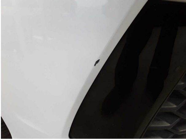
Domage #10: Pare-chocs avant: Pare-chocs avant - Erafilé - Réparer et repeindre
