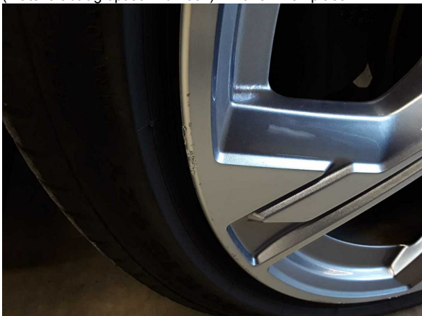
Domage #13: Roue / Pneumatiques: Jante alliage avant gauche (Materialabtrag optisch zu hoch) - Eraflé - Remplacer
