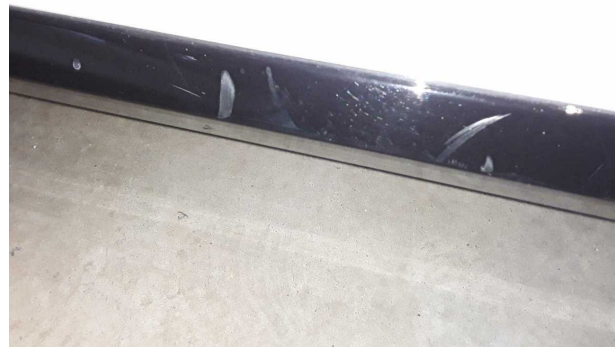
Dommage #4: Seuil gauche: Habillage - Rayure(s) - Réparation intelligente
