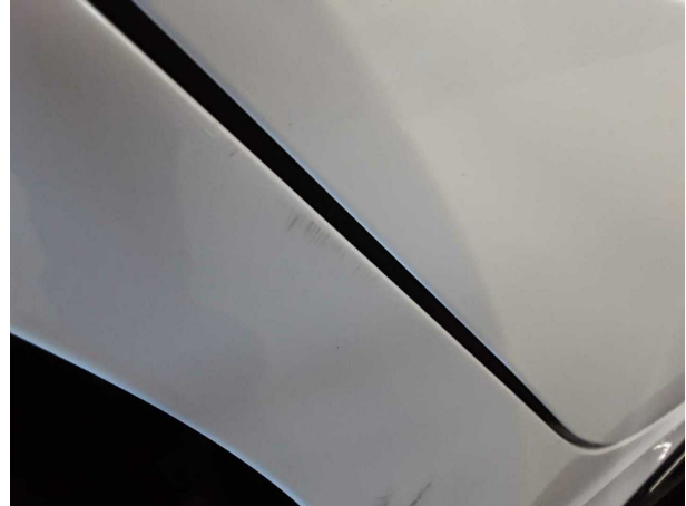
Damage #6: Panneau latéral arrière droit: Passage de roue - Rayure(s) - Réparation intelligente
