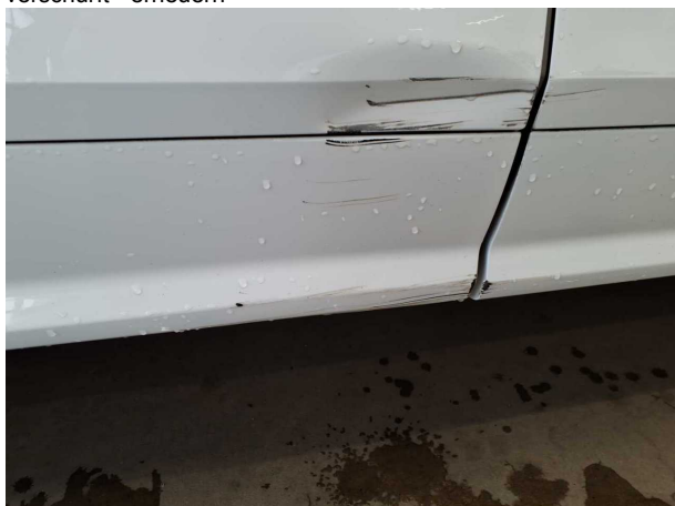
Beschädigung #2: Tür hinten rechts: Zierleiste unten - verkratzt / verschürft - erneuern
