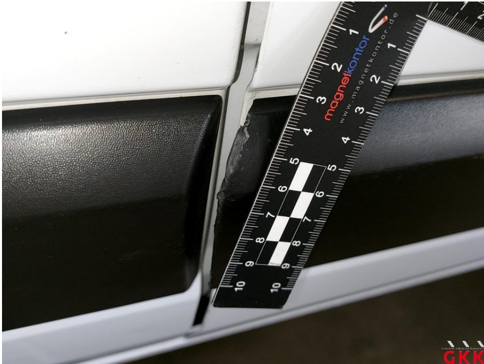
Bild 37 Tür vorne rechts, Leiste -unten-, beschädigt, ersetzen
