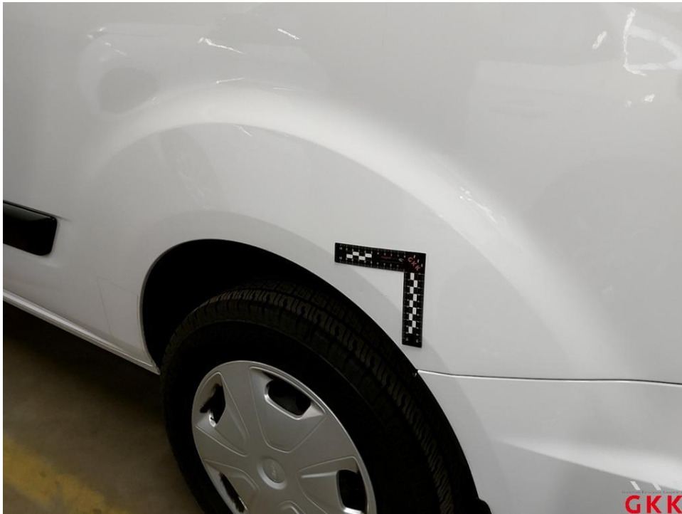
Bild 44 Seitenwand links, beschädigt, instand setzen - lackieren
