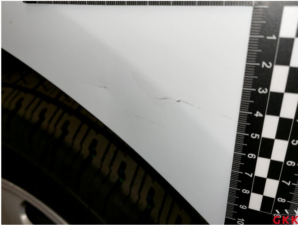
Bild 46 Seitenwand links, beschädigt, instand setzen - lackieren
