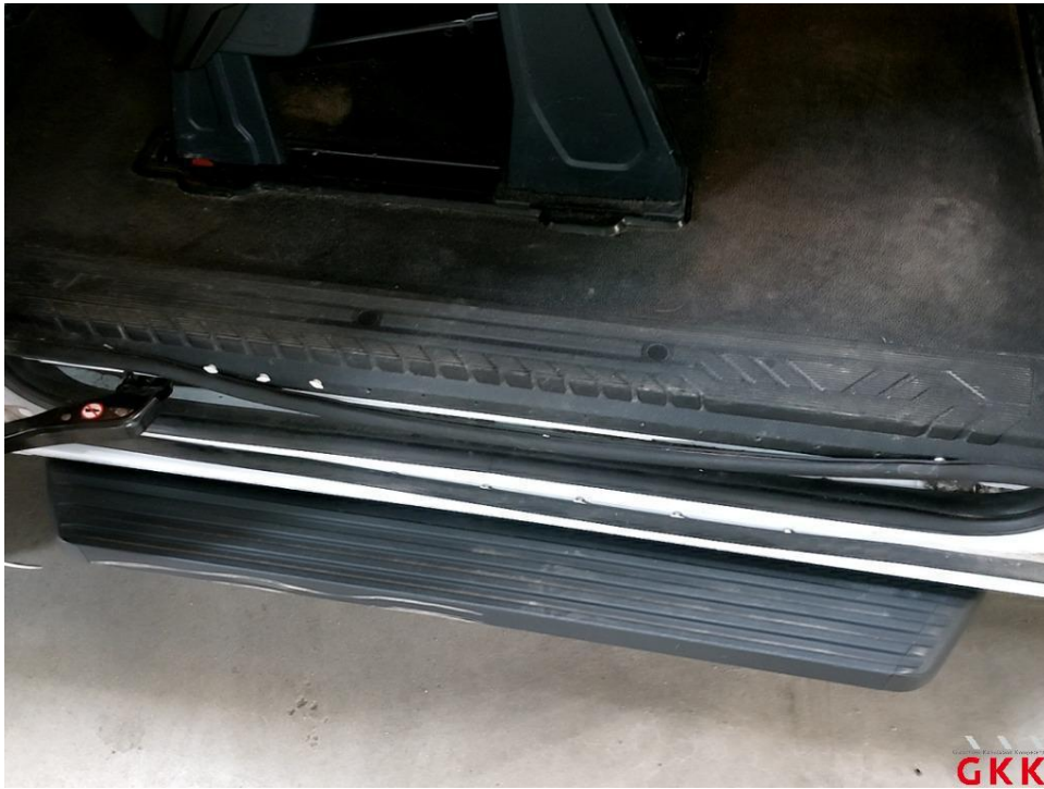
Bild 17 Schiebetür rechts, Dichtung -Einstieg-, beschädigt, ersetzen
