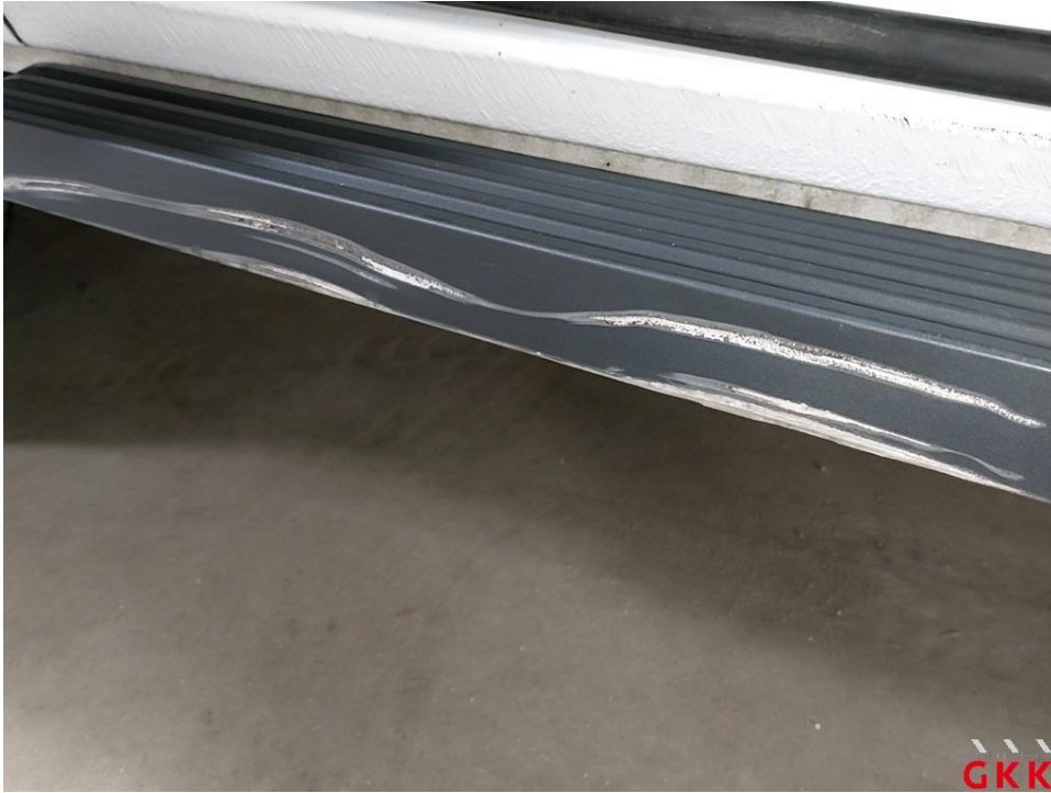
Bild 19 Trittbrett rechts, verkratzt, ersetzen
