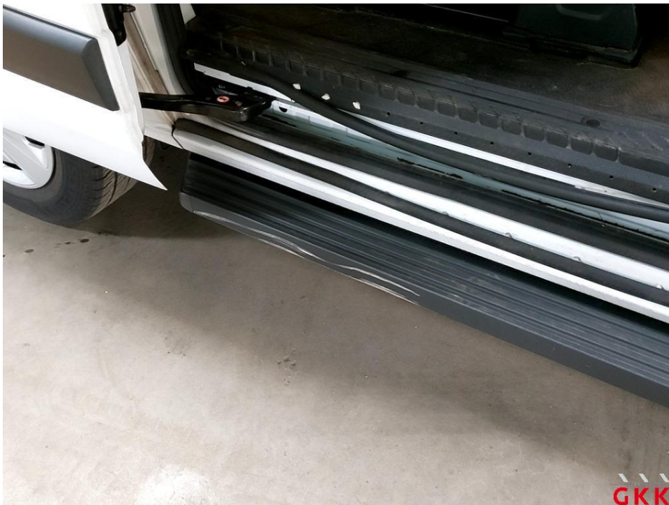
Bild 18 Trittbrett rechts, verkratzt, ersetzen
