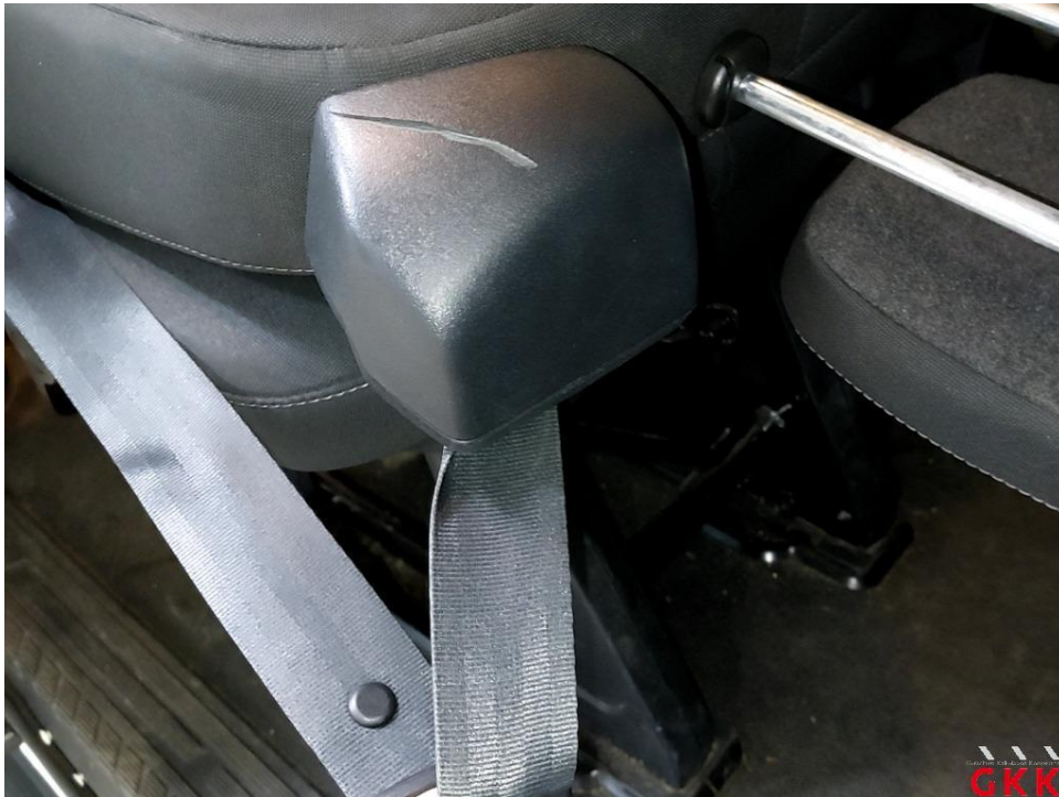
Bild 27 Sitz hinten rechts, Verkleidung, beschädigt, ersetzen
