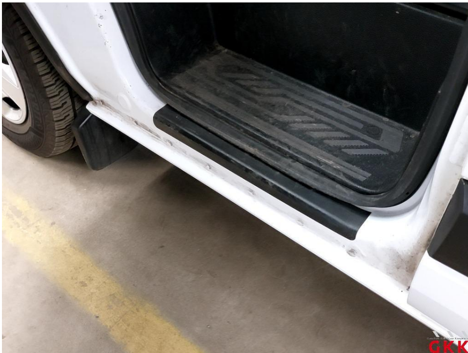
Bild 28 Tür vorne links, Dichtung -Einstieg-, fehlt, ersetzen
