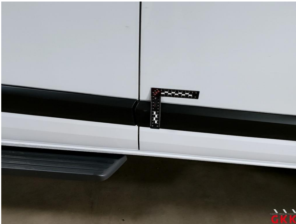
Bild 36 Tür vorne rechts, Leiste -unten-, beschädigt, ersetzen
