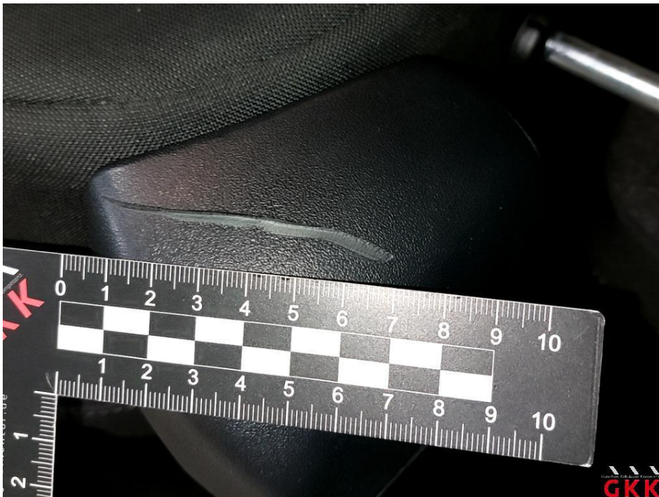
Bild 26 Sitz hinten rechts, Verkleidung, beschädigt, ersetzen
