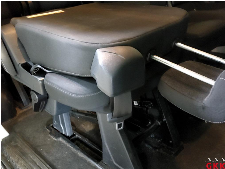
Bild 25 Sitz hinten rechts, Verkleidung, beschädigt, ersetzen
