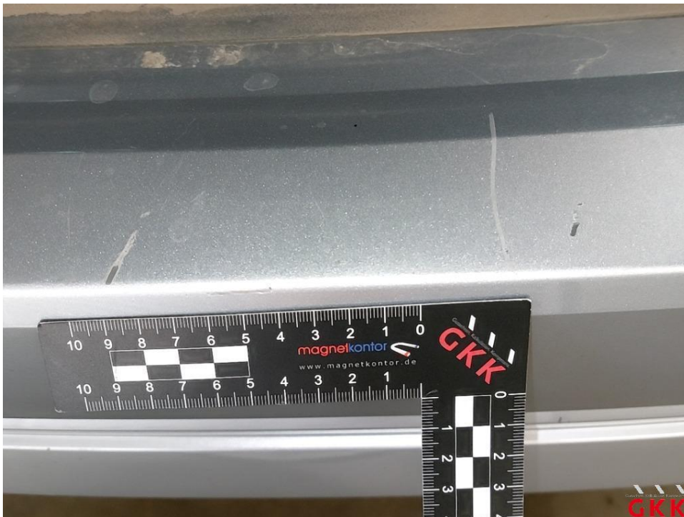
Bild 34 Stoßfänger hinten, Verkleidung -lackiert-, verkratzt, lackieren
