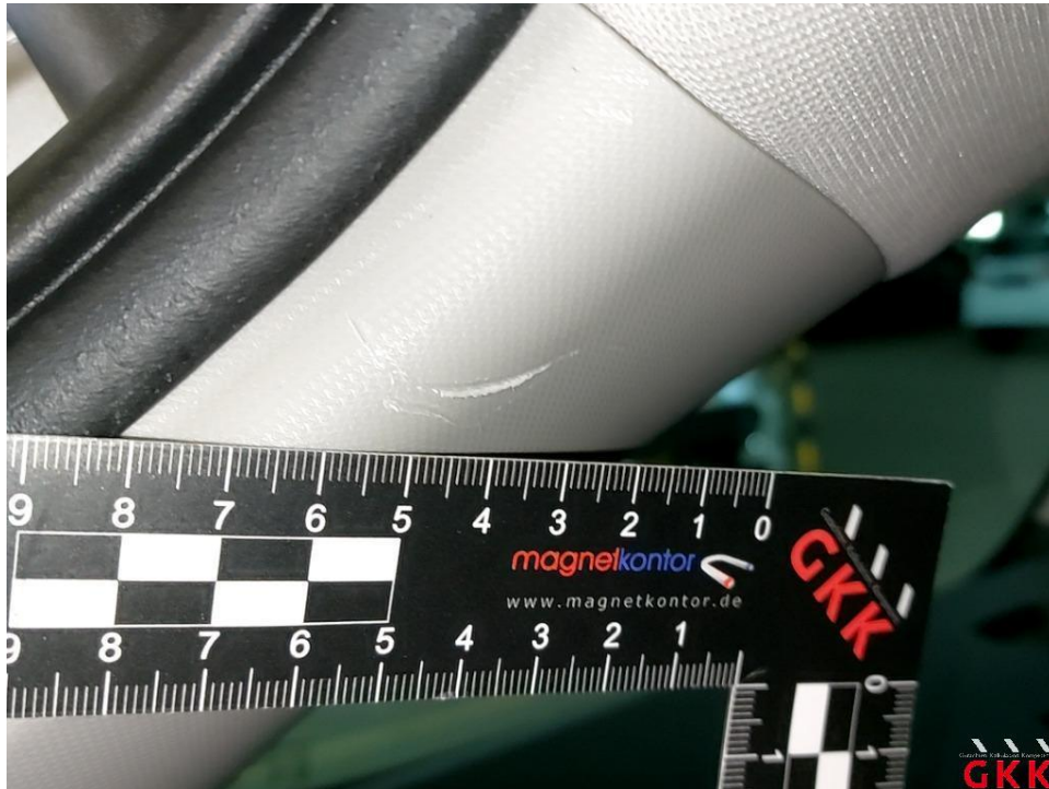
Bild 37 D- Säule links, Innenverkleidung, verkratzt, Smartrepair
