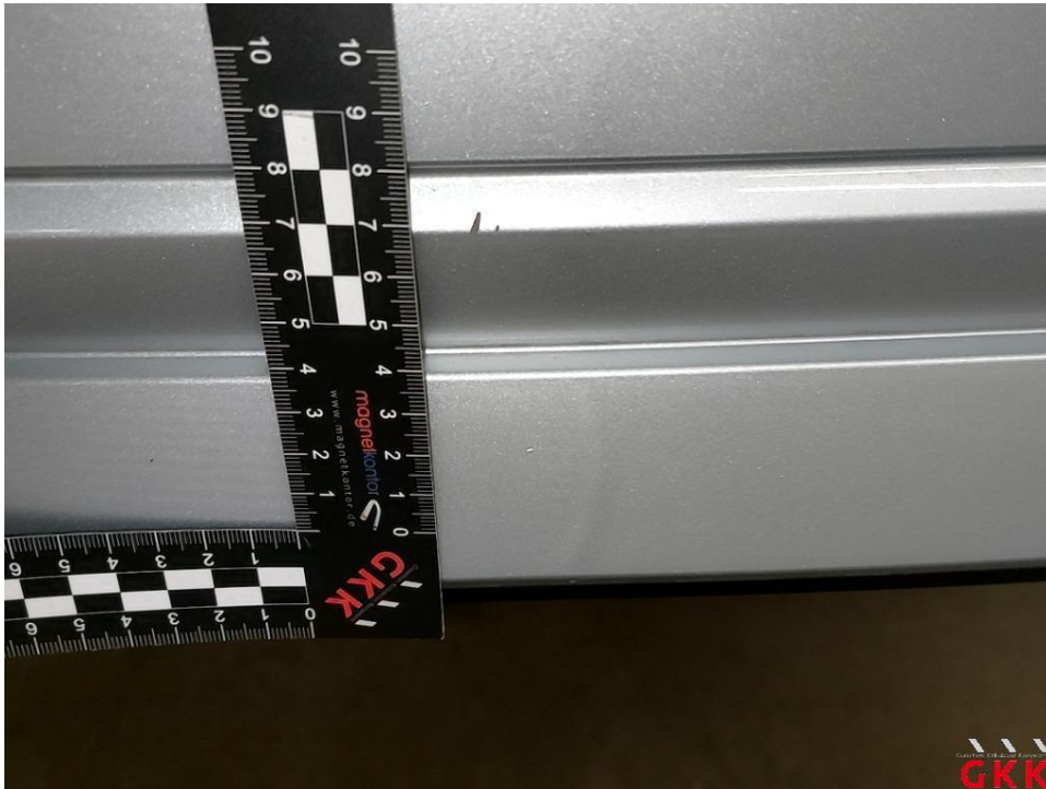
Bild 35 Stoßfänger hinten, Verkleidung -lackiert-, verkratzt, lackieren
