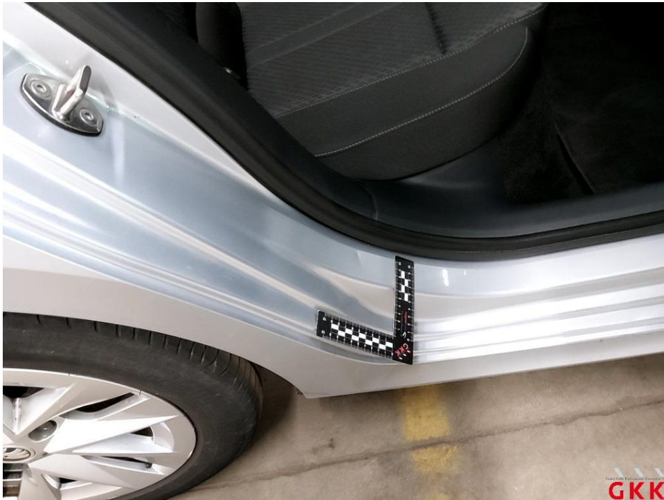
Bild 25 Tür hinten rechts, Einstieg, beschädigt, Smartrepair
