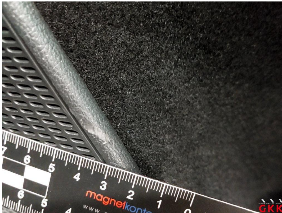
Bild 24 Tür hinten rechts, Innenverkleidung -Standard-, Druckstellen, Smartrepair
