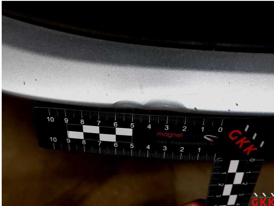
Bild 21 Stoßfänger vorne, Verkleidung -lackiert-, beschädigt, ersetzen
