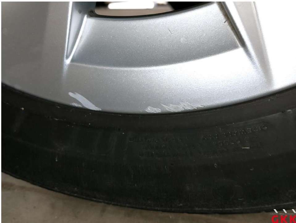
Bild 40 LM-Rad, hinten rechts, verkratzt, aufbereiten
