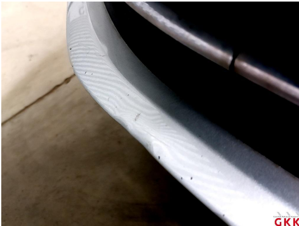
Bild 20 Stoßfänger vorne, Verkleidung -lackiert-, beschädigt, ersetzen
