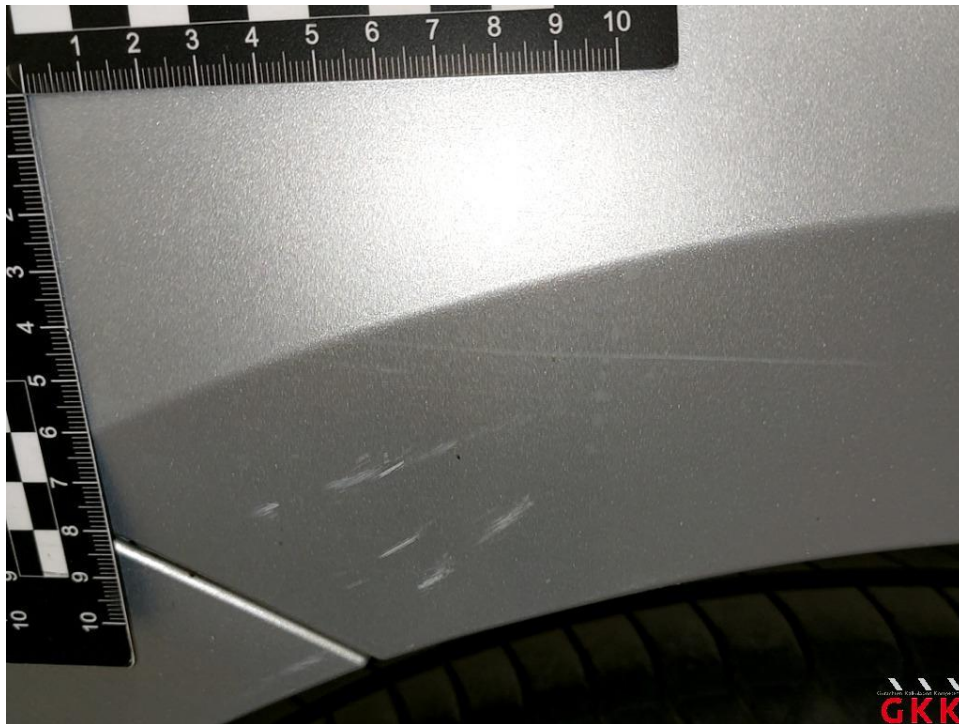
Bild 29 Seitenwand rechts, verkratzt, polieren
