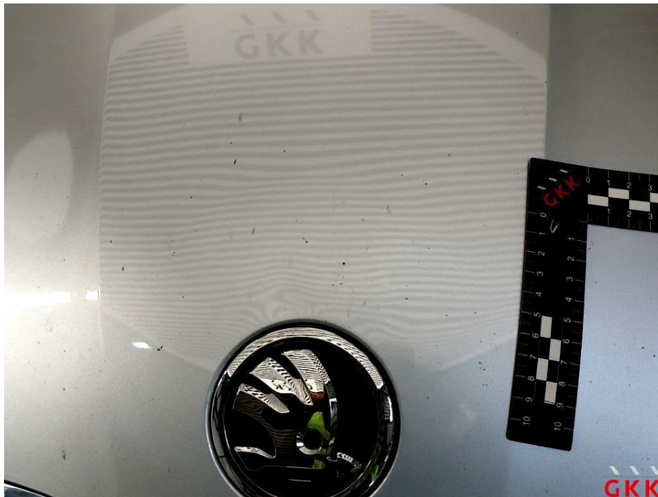
Bild 18 Motorhaube, beschädigt, instand setzen - lackieren
