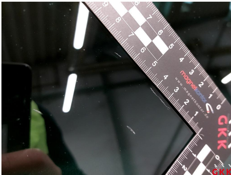
Bild 32 Seitenwand rechts, Scheibe -getönt-, verkratzt, ersetzen
