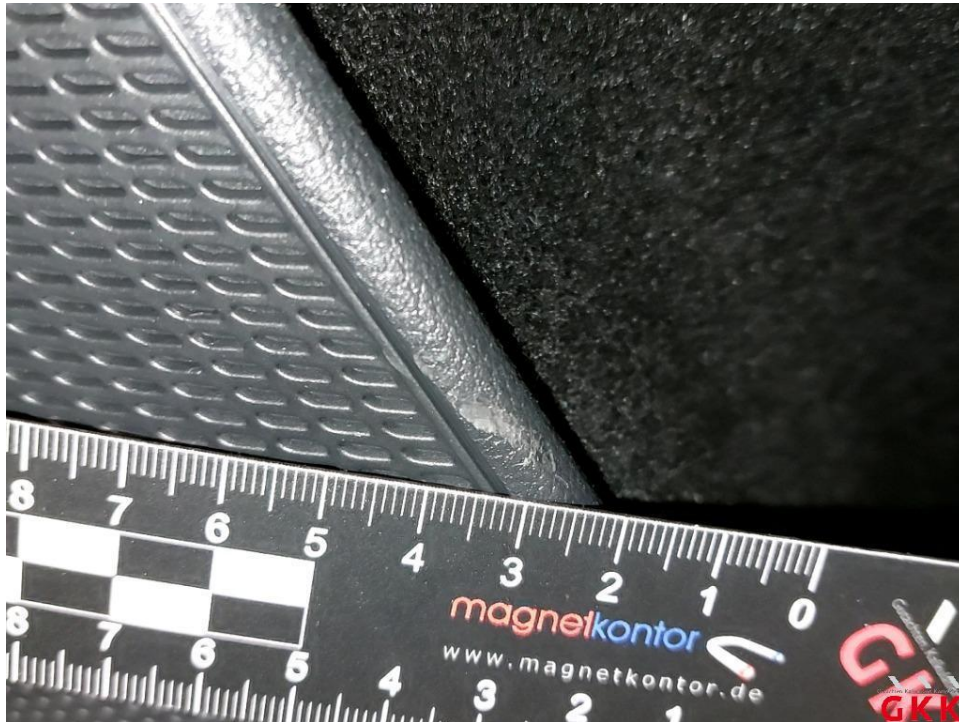
Bild 23 Tür hinten rechts, Innenverkleidung -Standard-, Druckstellen, Smartrepair
