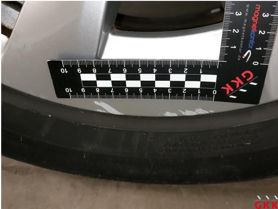
Bild 39 LM-Rad, hinten rechts, verkratzt, aufbereiten
