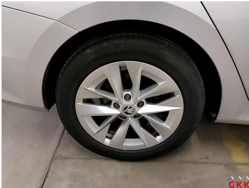
Bild 38 LM-Rad, hinten rechts, verkratzt, aufbereiten
