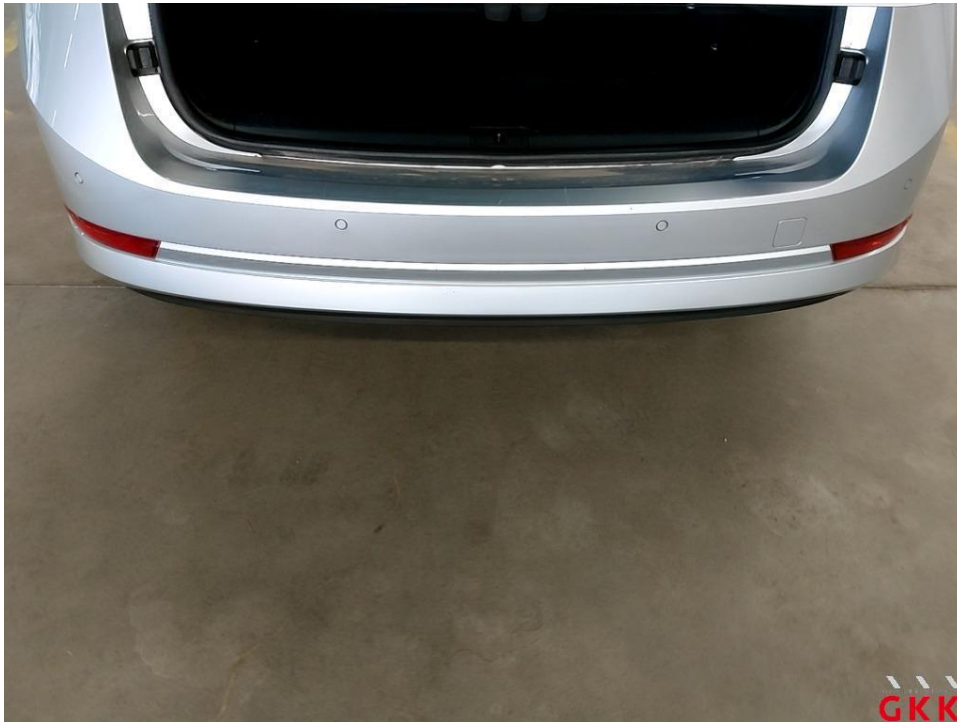
Bild 33 Stoßfänger hinten, Verkleidung -lackiert-, verkratzt, lackieren
