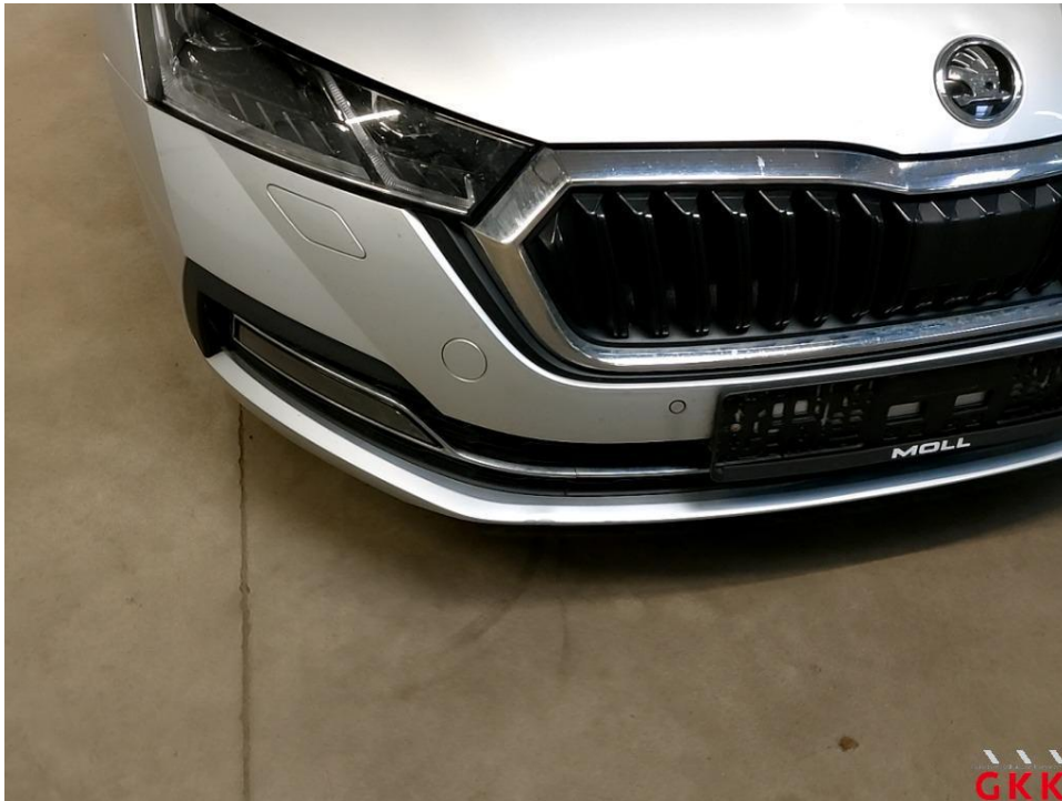
Bild 19 Stoßfänger vorne, Verkleidung -lackiert-, beschädigt, ersetzen
