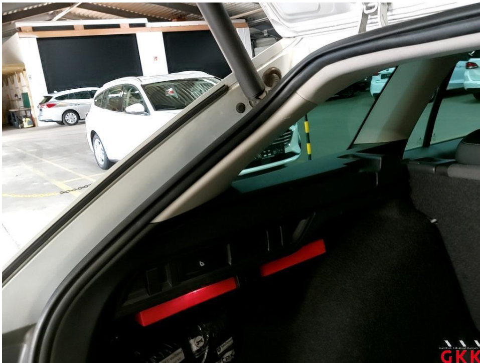
Bild 36 D- Säule links, Innenverkleidung, verkratzt, Smartrepair
