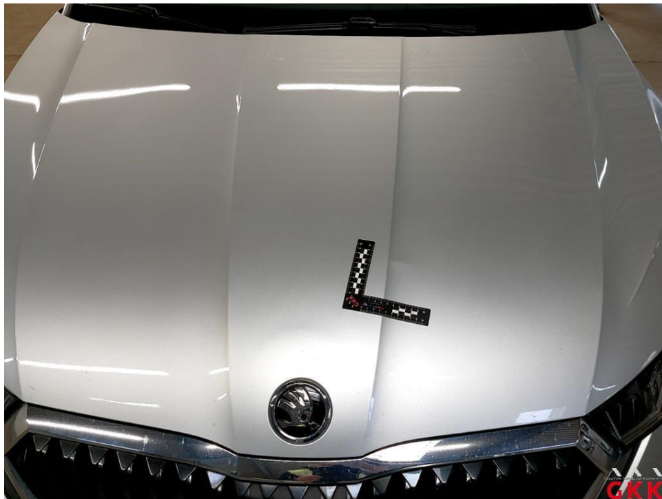
Bild 16 Motorhaube, beschädigt, instand setzen - lackieren
