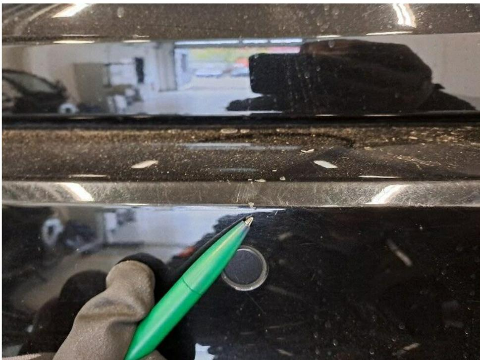
Bild 24 : Stoßfänger hinten Kratzer + Kerbe
