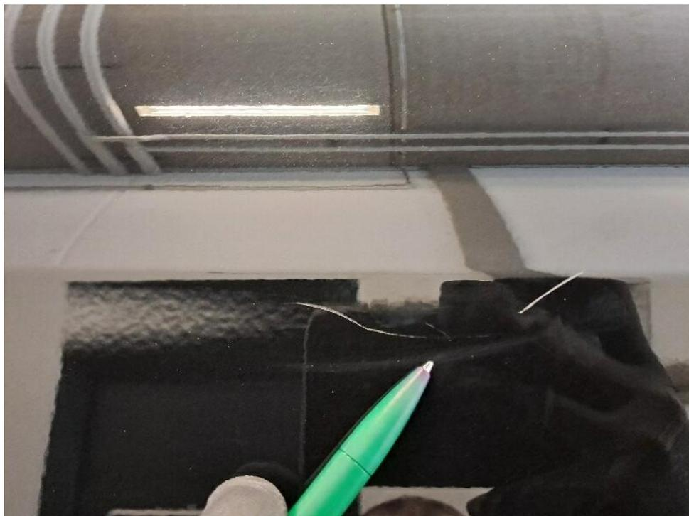
Bild 21 : Türe hinten rechts Kratzer + Delle
