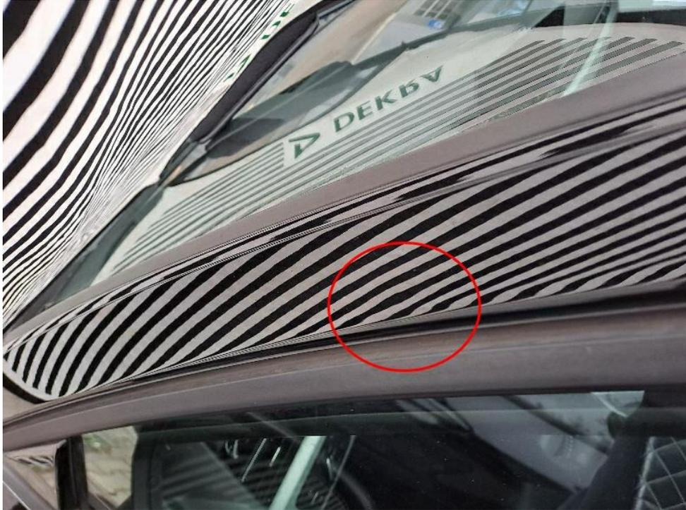
Bild 25 : A-Säule Inks Delle
