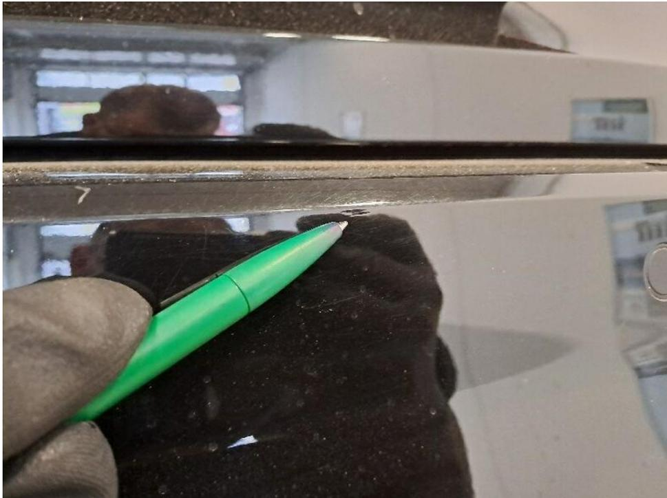
Bild 23 : Stoßfänger hinten Kratzer + Kerbe
