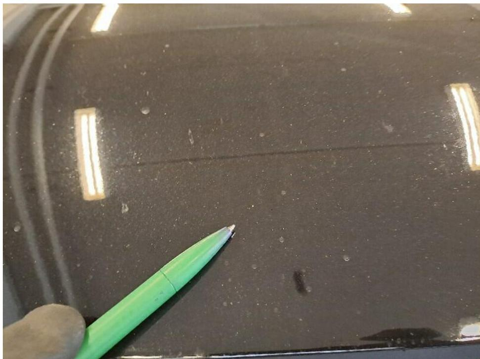
Bild 18 : Motorhaube Steinschlag + Delle
