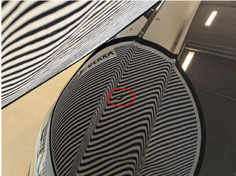
Bild 17 : Motorhaube Steinschlag + Delle
