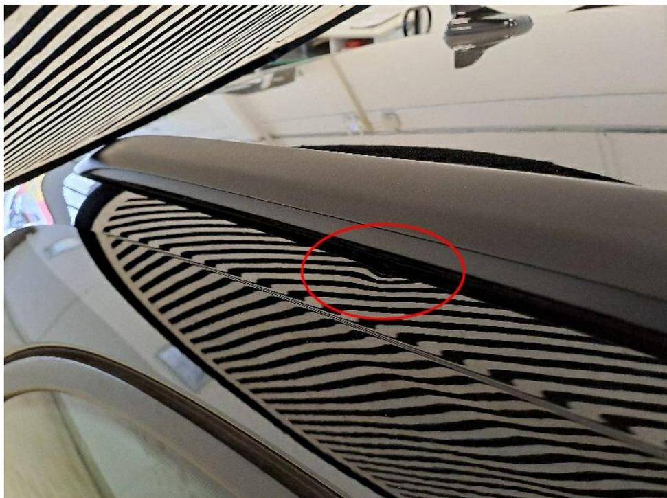
Bild 16 : Dachrahmen rechts Delle
