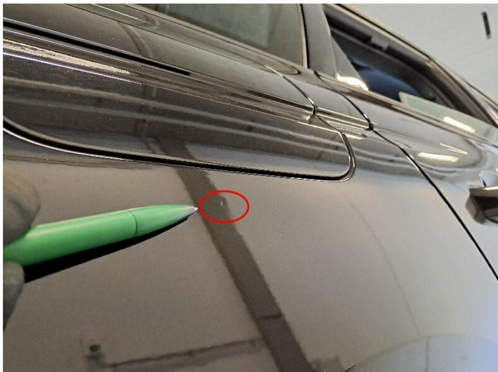
Bild 22 : Seitenwand hinten rechts Kratzer + Delle
