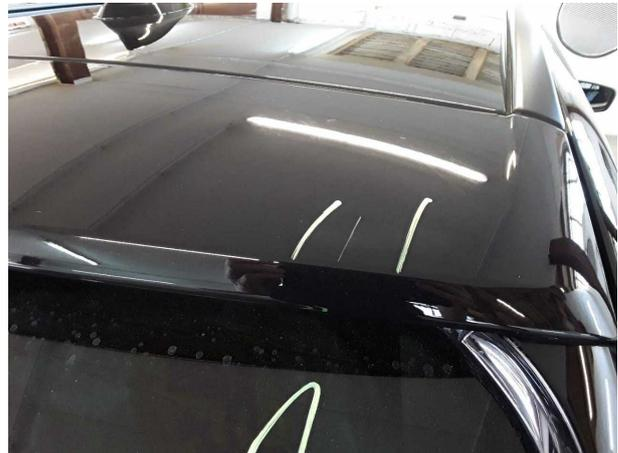
**Beschädigung #2:** Heckklappe/-tür: Heckspoiler - verkratzt / verschürft - Smart Repair
