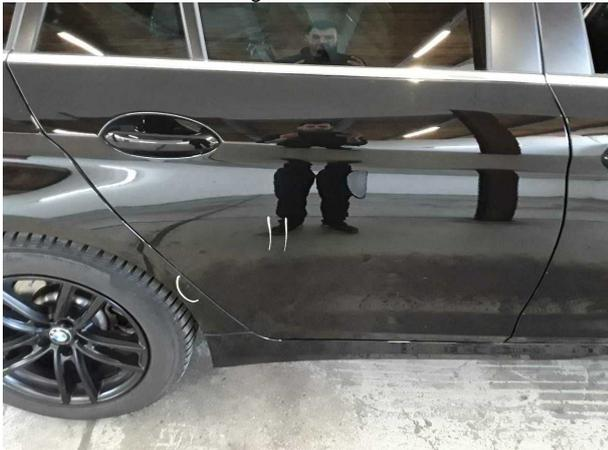
**Beschädigung #4:** Tür hinten rechts: Tür - Kratzer - instandsetzen und lackieren
