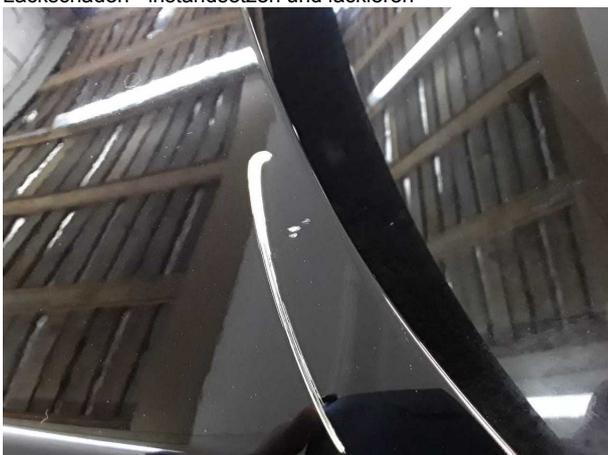
**Beschädigung #8:** Motorhaube: Motorhaube - verkratzt / versch...
