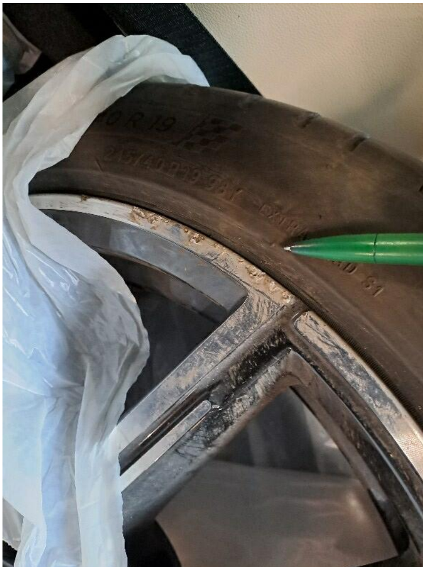
Bild 14 : LM-Felge vorne rechts Sommer glanzgedreht Kratzer + Abschürfungen
