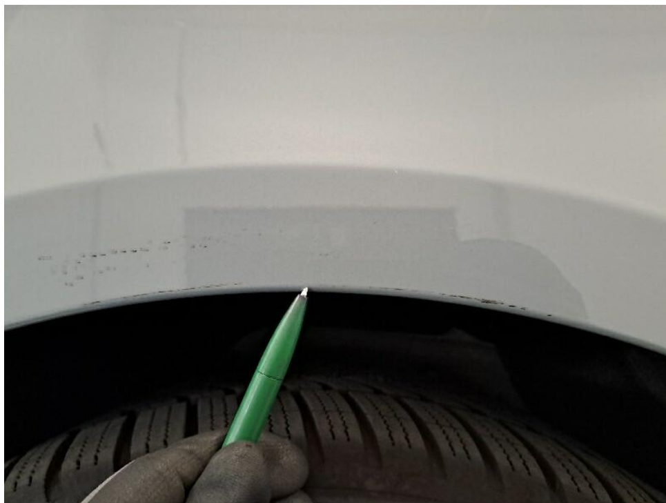
Bild 20 : Seitenwand hinten links Kratzer + Delle
