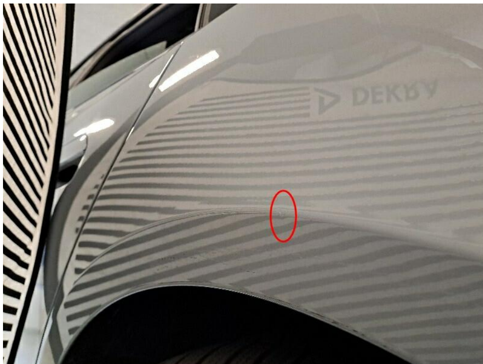
Bild 21 : Seitenwand hinten links Kratzer + Delle
