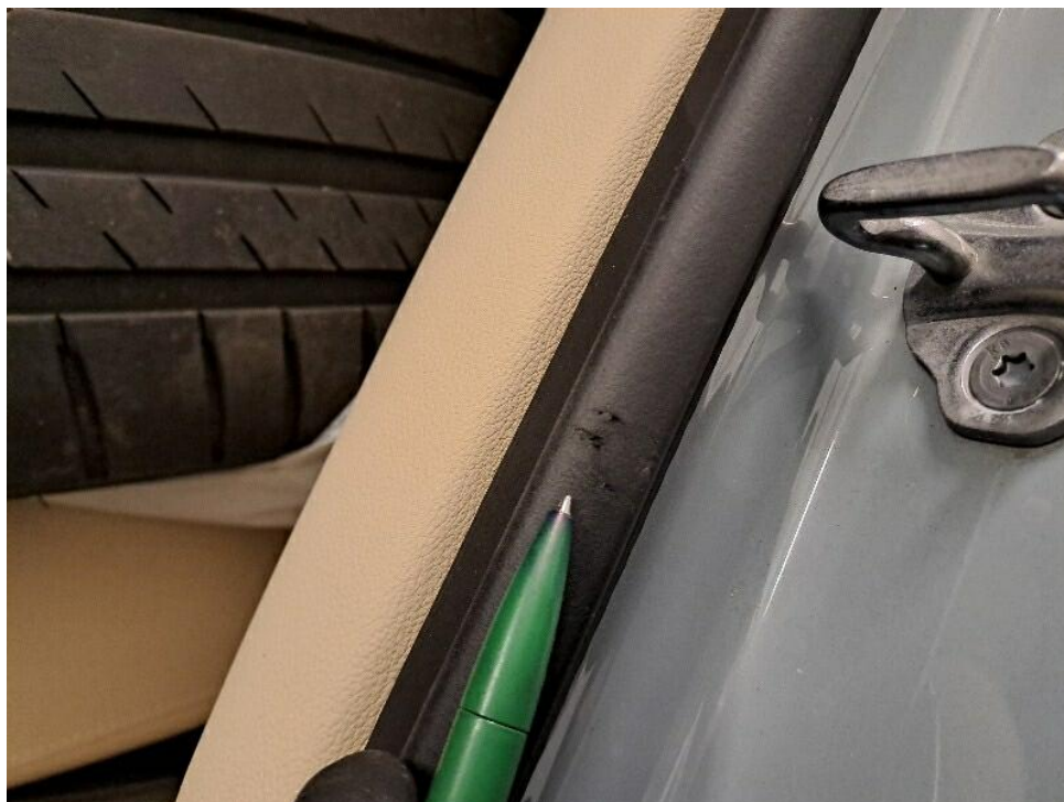
Bild 23 : Kantenschutz hinten links Kratzer
