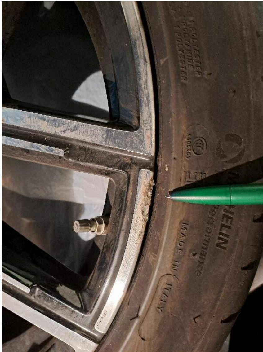
Bild 13 : LM-Felge vorne rechts Sommer glanzgedreht Kratzer + Abschürfungen
