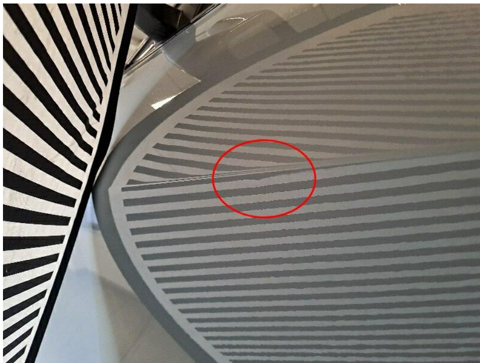
Bild 22 : Türe vorne links Delle
