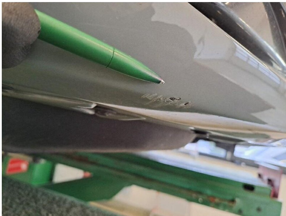
Bild 18 : Stoßfänger vorne Kratzer
