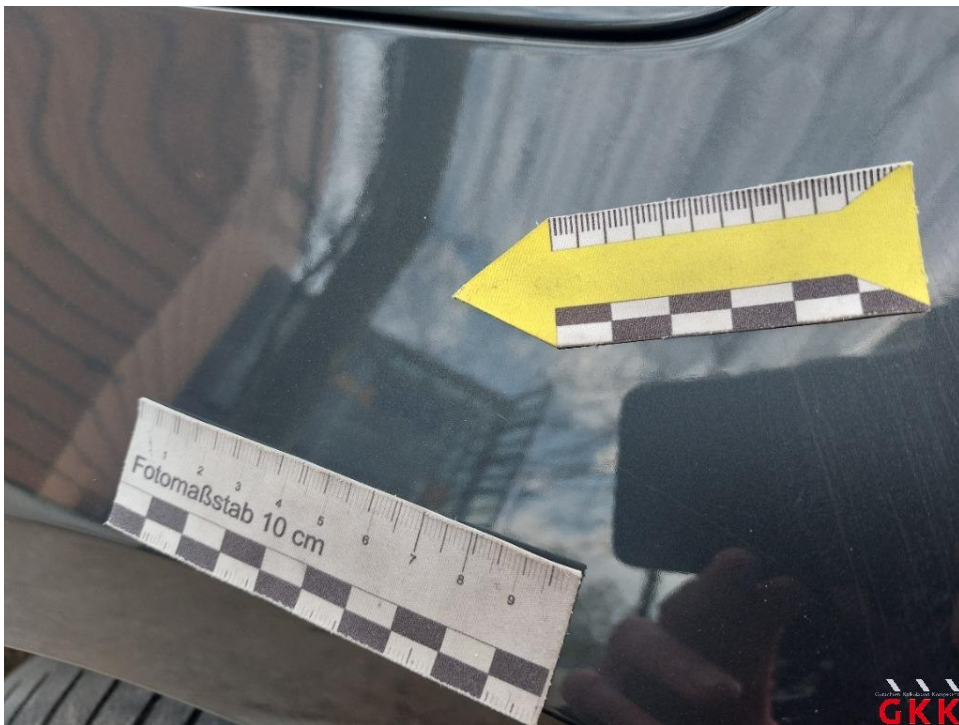
Bild 36. Seitenwand rechts, Reparaturmangel, lackieren
