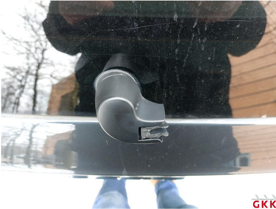
Bild 19. Heckwischer, Arm, abgerissen, ersetzen
