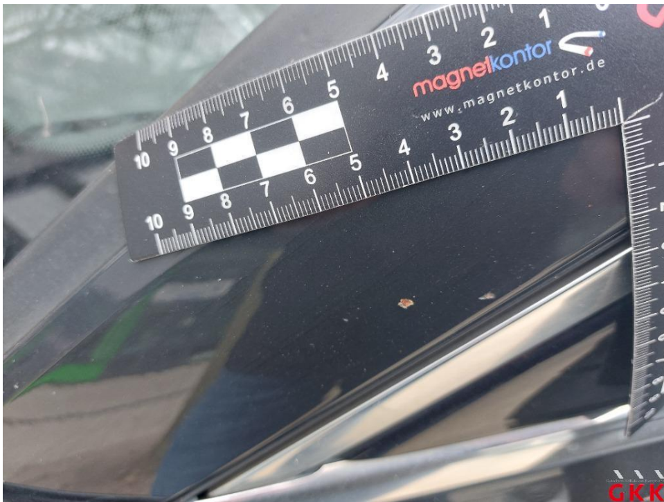
Bild 26. A- Säule links, korrodiert, lackieren
