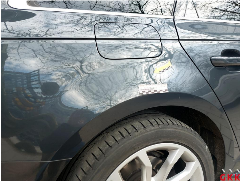
Bild 35. Seitenwand rechts, Reparaturmangel, lackieren
