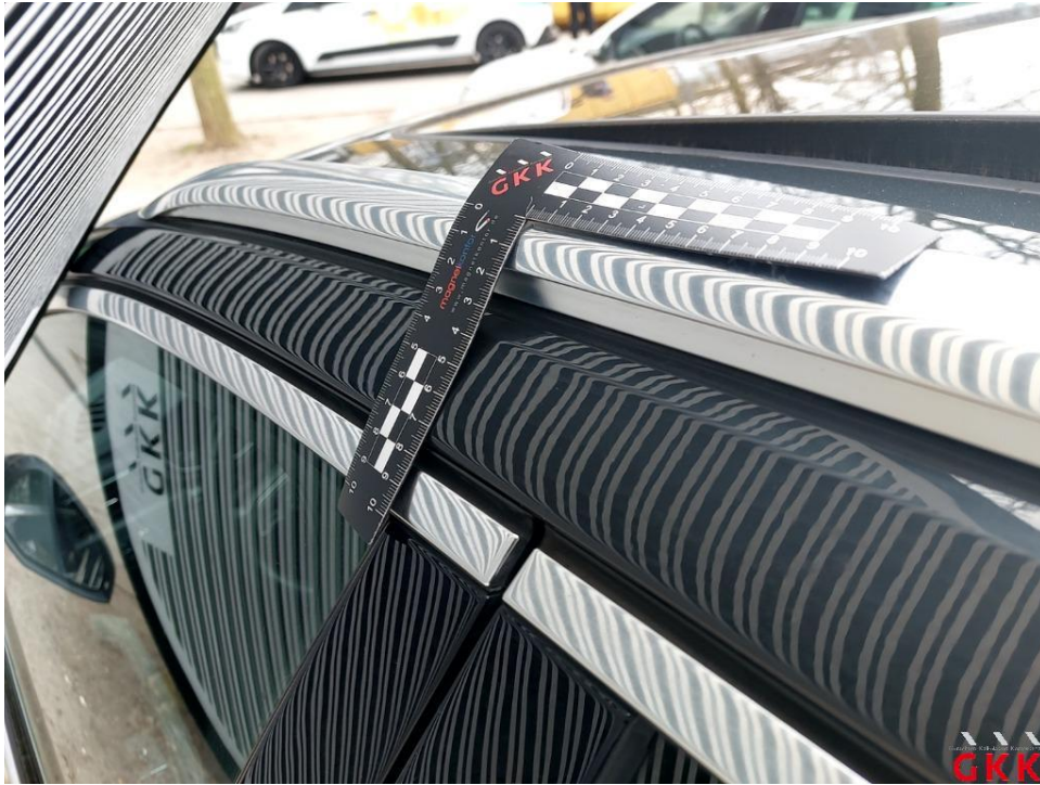
Bild 29. Dach, Holm links, beschädigt, instand setzen - lackieren
