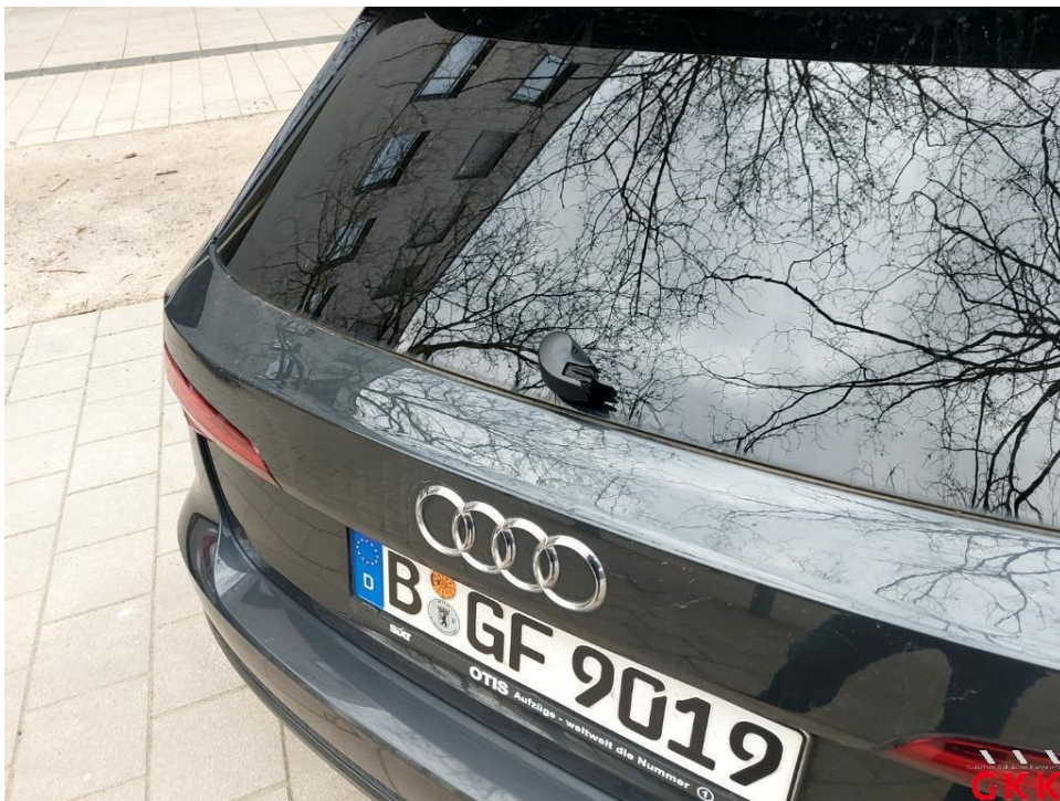
Bild 18. Heckwischer, Arm, abgerissen, ersetzen
