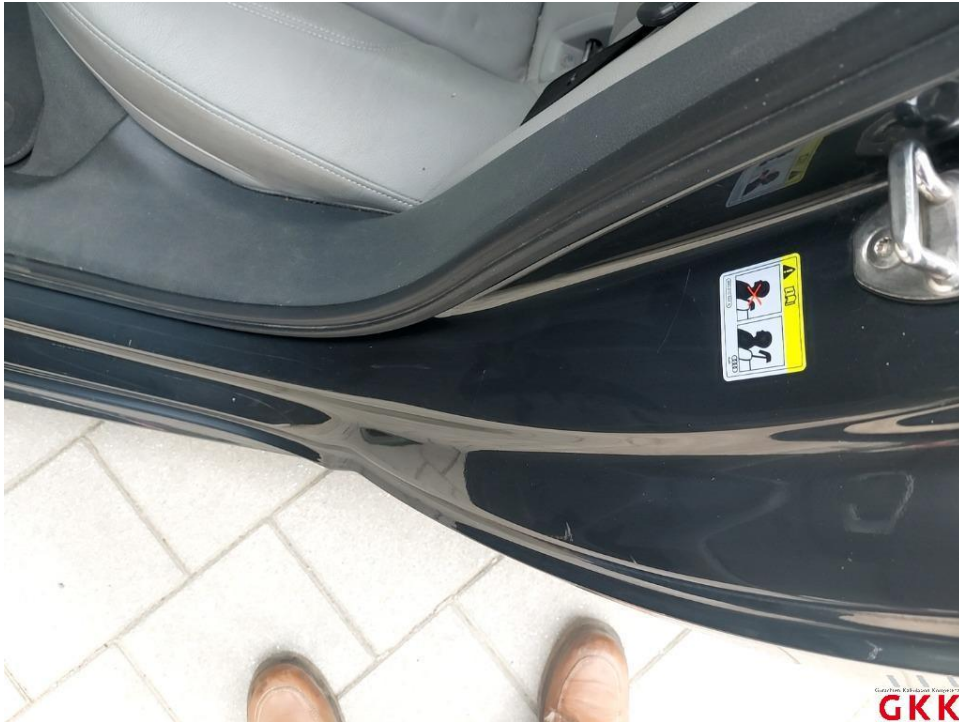
Bild 37. Tür hinten links, Einstieg, beschädigt, instand setzen - lackieren
