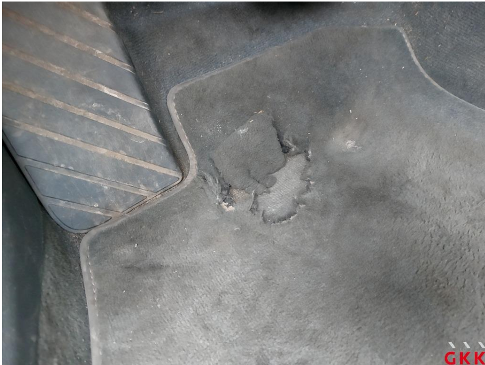
Bild 24. Fußmatte(n), vorne links, beschädigt, ersetzen
