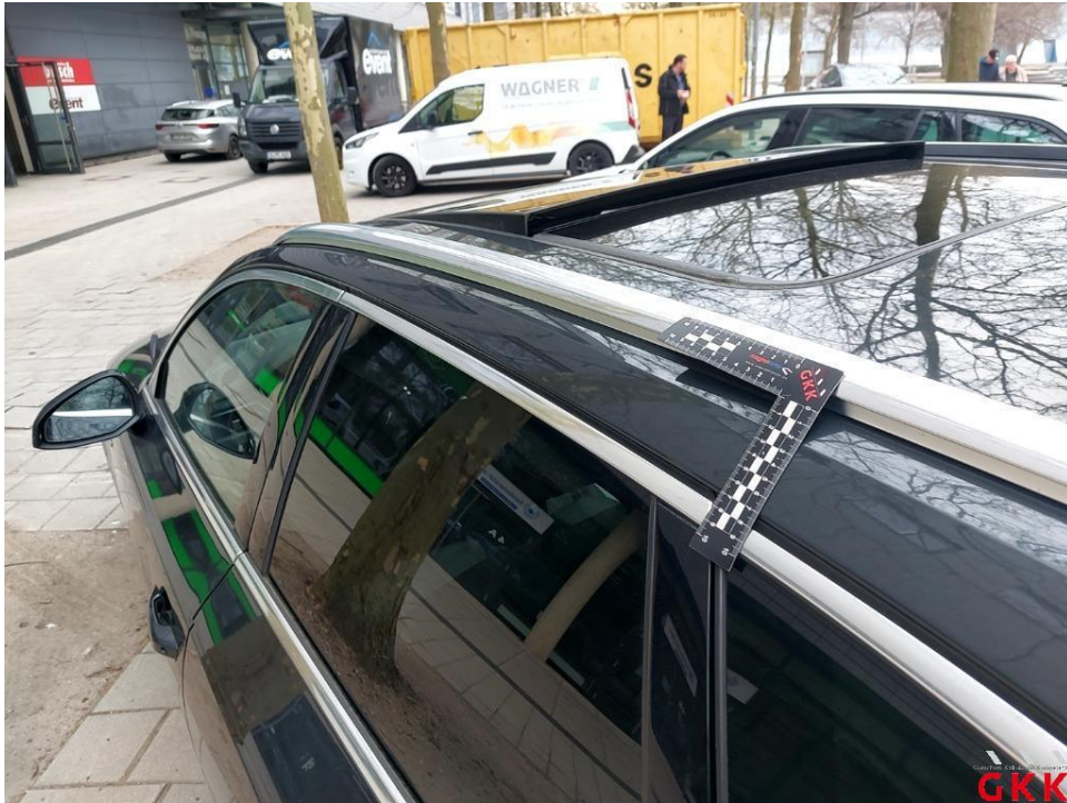
Bild 27. Dach, Holm links, beschädigt, instand setzen - lackieren
