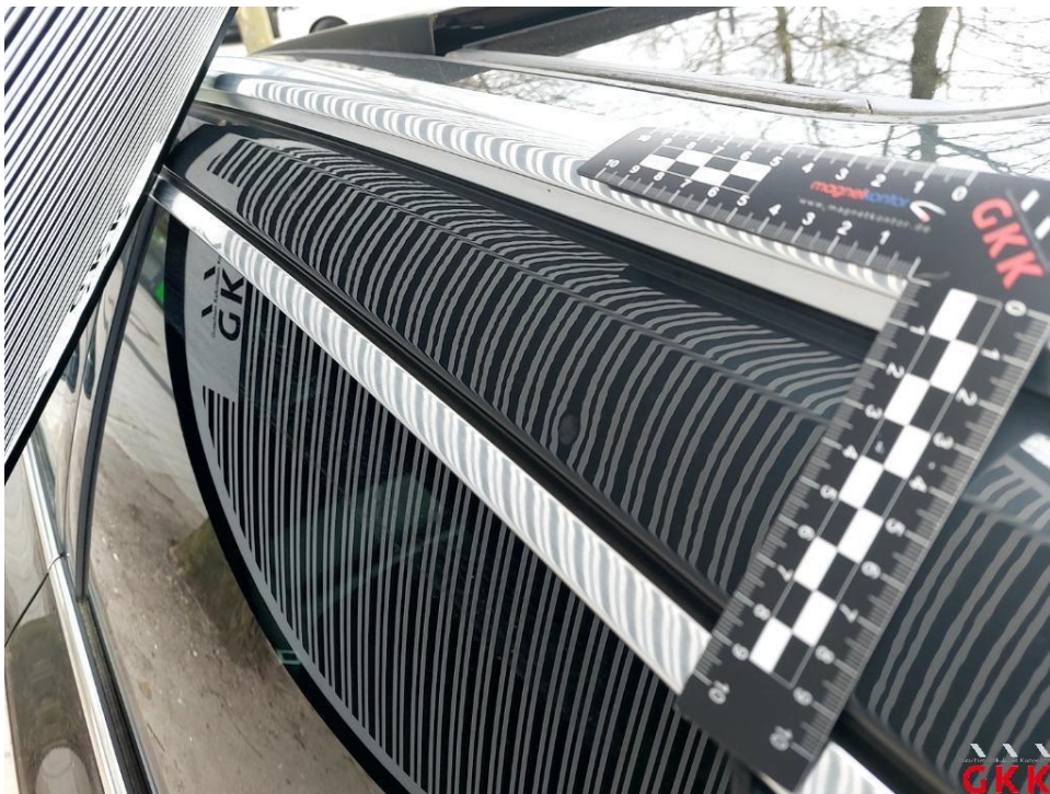
Bild 28. Dach, Holm links, beschädigt, instand setzen - lackieren
