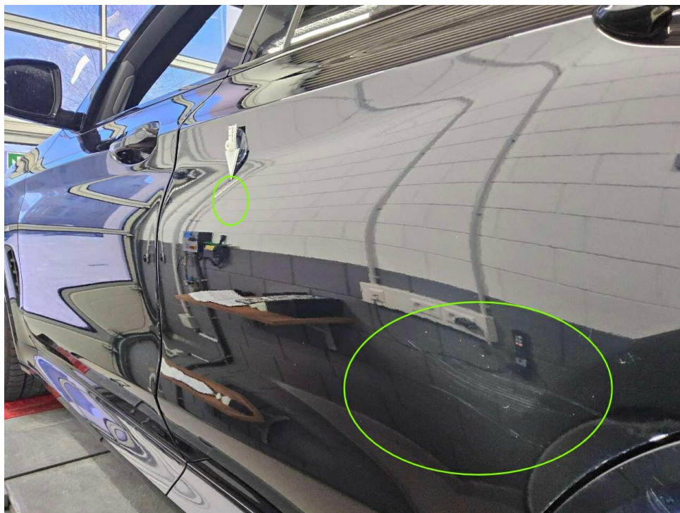
Bild 31 : Tür hinten links, eingedellt, instandsetzen und lackieren mit Lackaufbau
