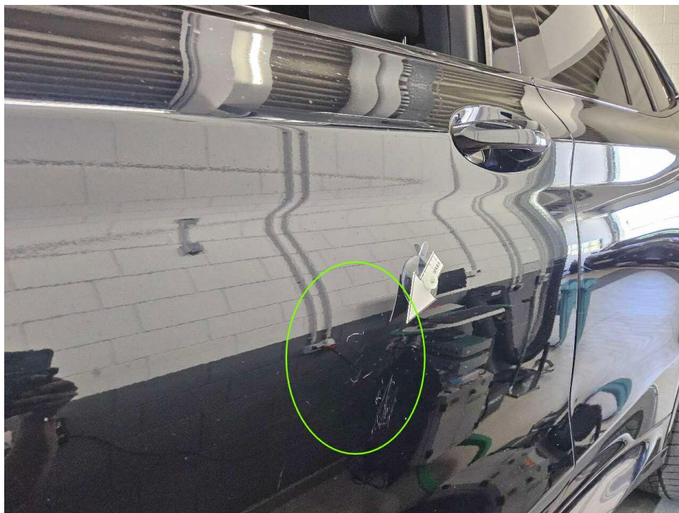
Bild 29 : Tür vorne links Lackierung, zerkratzt, lackieren mit Lackaufbau
