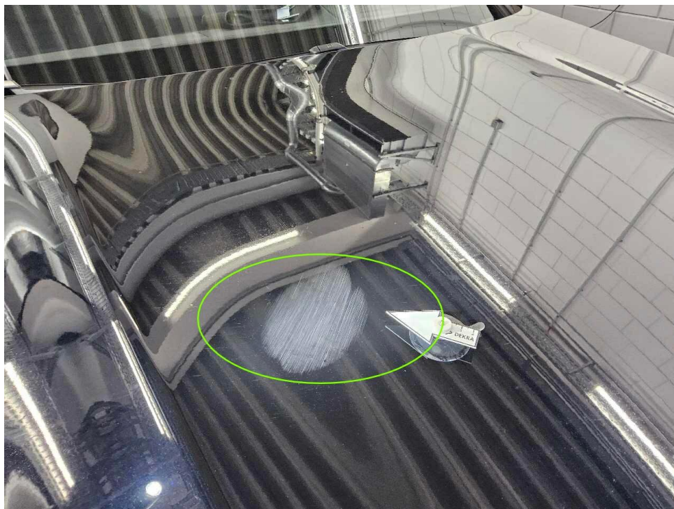
Bild 27 : Motorhaube Lackierung, zerkratzt, lackieren
