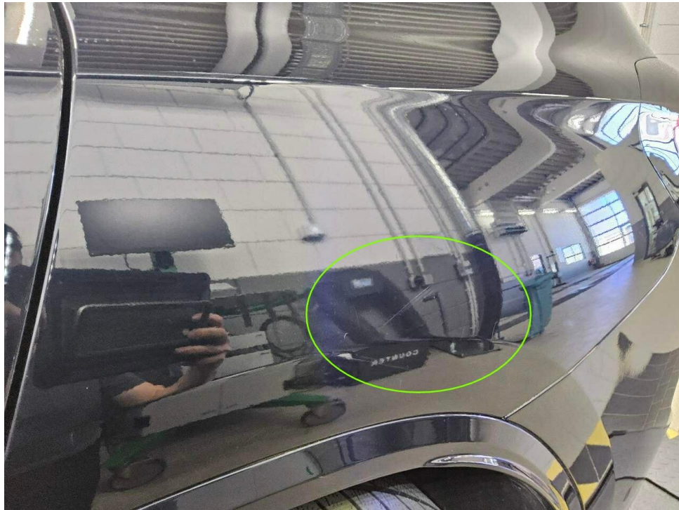
Bild 41 : Seitenteil hinten links Lackierung, zerkratzt, lackieren
