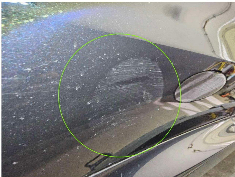
Bild 36 : Tür hinten rechts Lackierung, zerkratzt, lackieren
