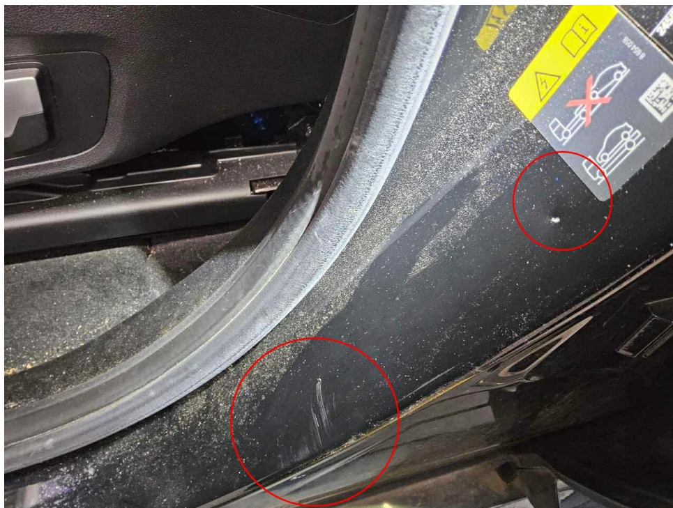
Bild 19 : Türeinstieg vorne links verkratzt und eingedellt
