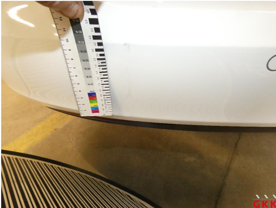
Bild 19 Stoßfänger hinten, Verkleidung -lackiert-, beschädigt, instand setzen - lackieren
