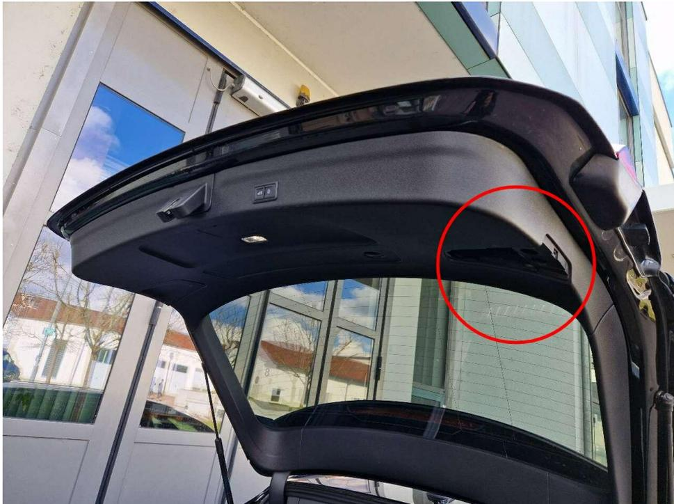
Bild 17 : Abdeckung Heckklappenverkleidung rechts fehlt
