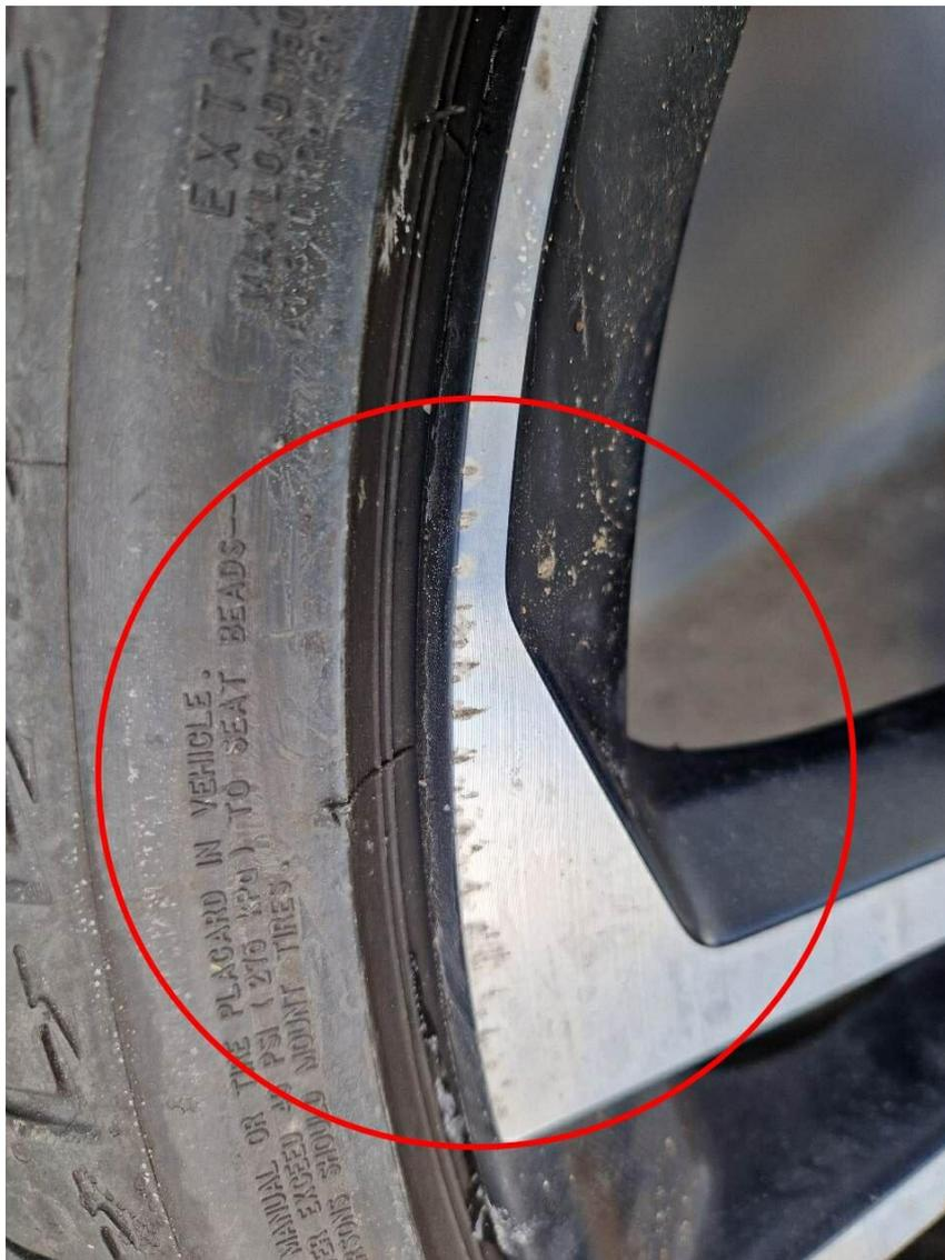
Bild 14 : Sommerradfelge verschrammt
