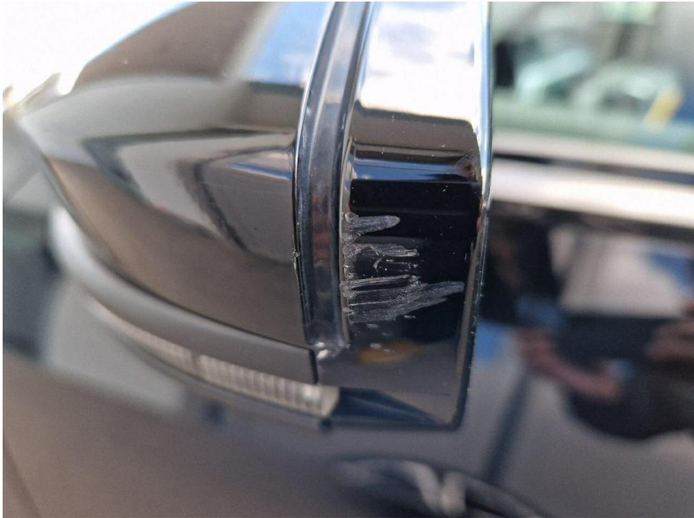
Bild 15 : Spiegelkappe links verschrammt
