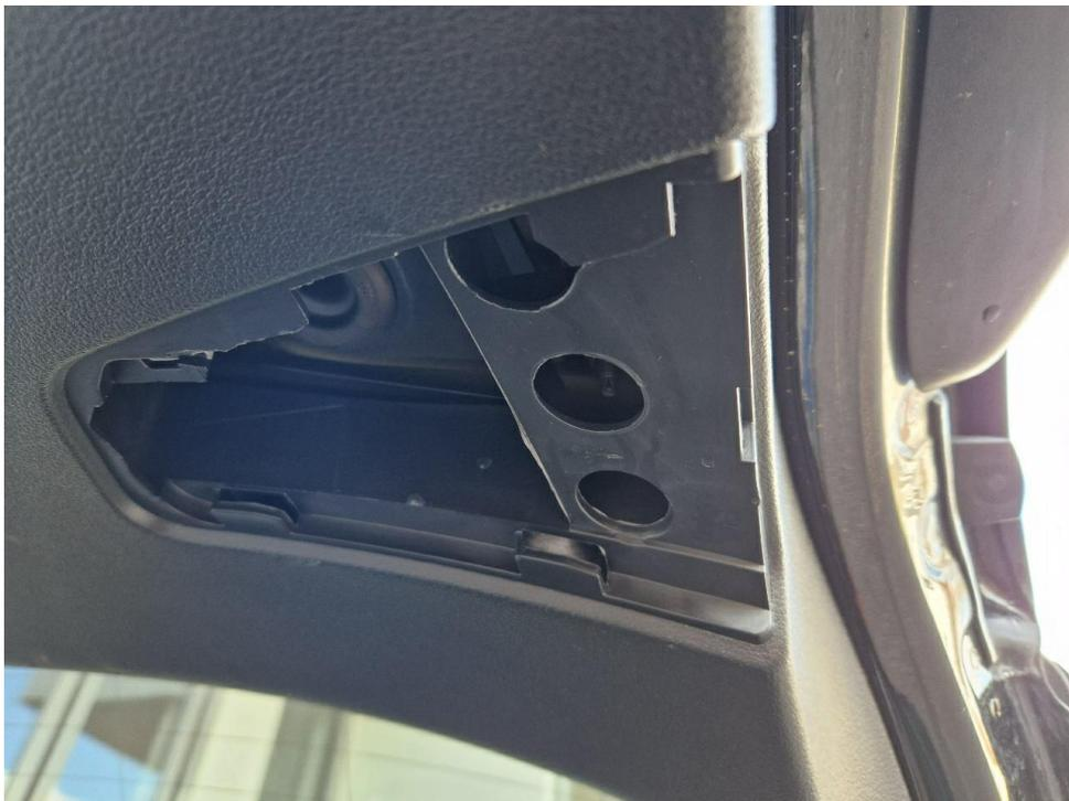
Bild 18 : Abdeckung Heckklappenverkleidung rechts fehlt
