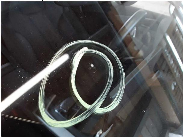
**Domage #4:** Vitrage: Pare-brise - Dommage causé par des cailloux - Remplacer
