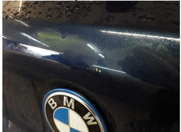
**Beschädigung #2:** Heckklappe/-tür: Heckklappe - verkratzt / verschürft - Smart Repair
