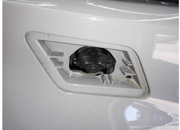
**Beschädigung #4:** Scheinwerfer: Scheinwerferreinigungsdüse rechts (Abdeckung) - fehlt - erneuern
