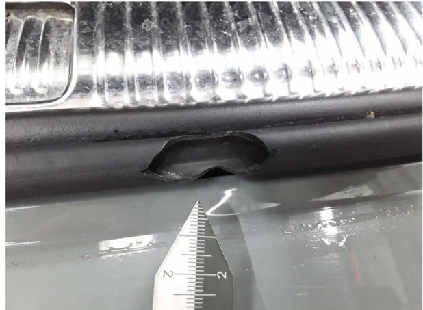
**Beschädigung #2:** Heckklappe/-tür: Dichtung - gebrochen / gerissen - erneuern
