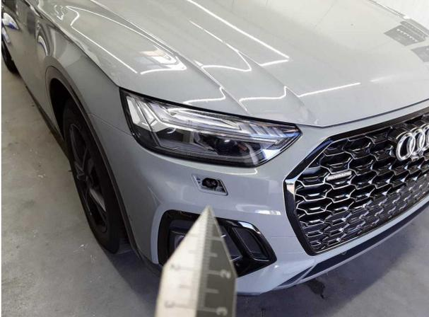
**Beschädigung #4:** Scheinwerfer: Scheinwerferreinigungsdüse rechts (Abdeckung) - fehlt - erneuern
