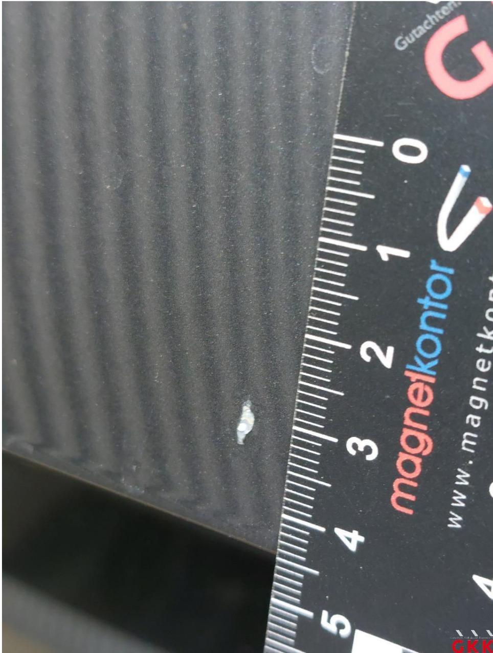
Bild 45 Heckklappe, korrodiert, lackieren
