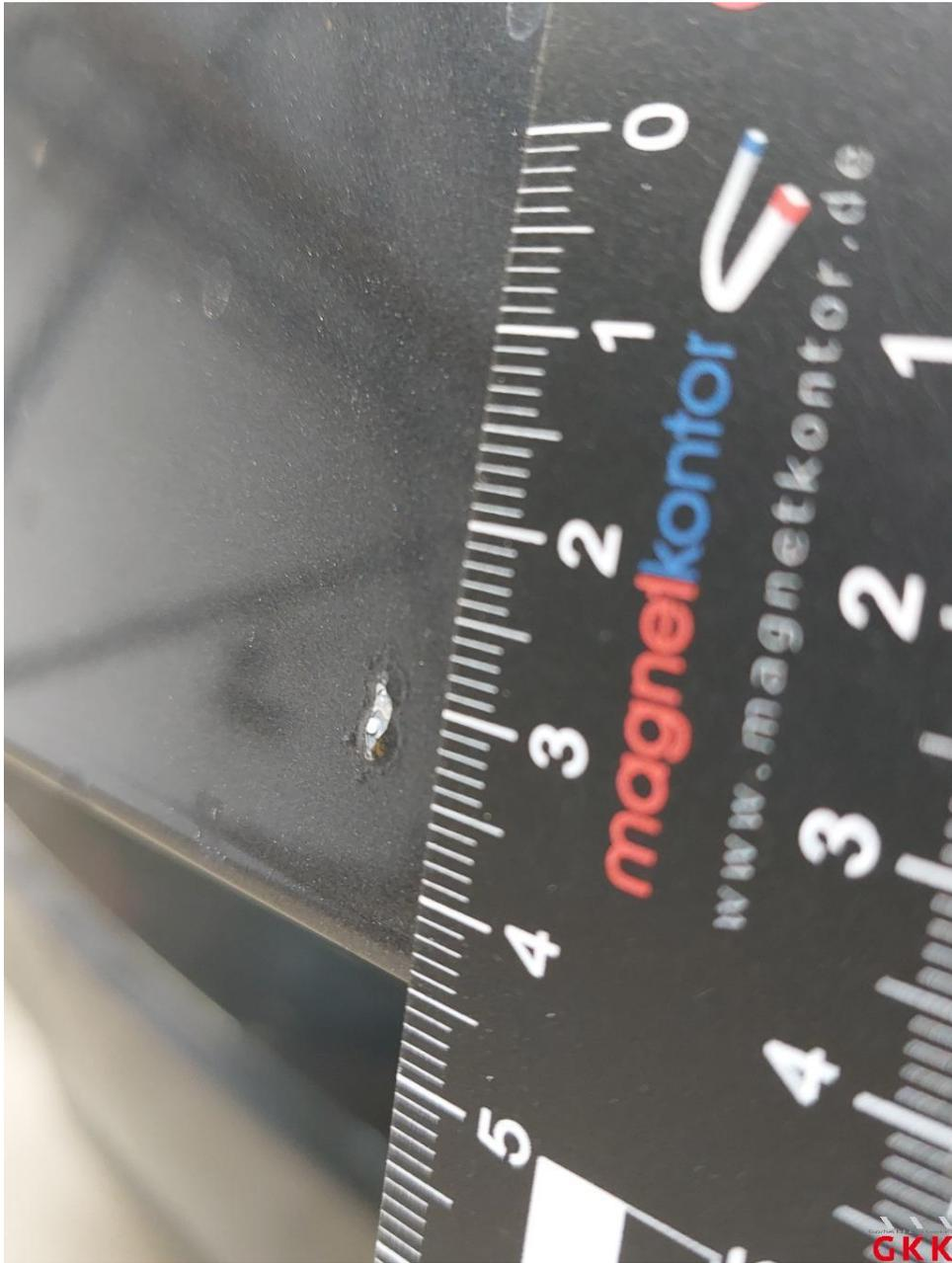
Bild 46 Heckklappe, korrodiert, lackieren
