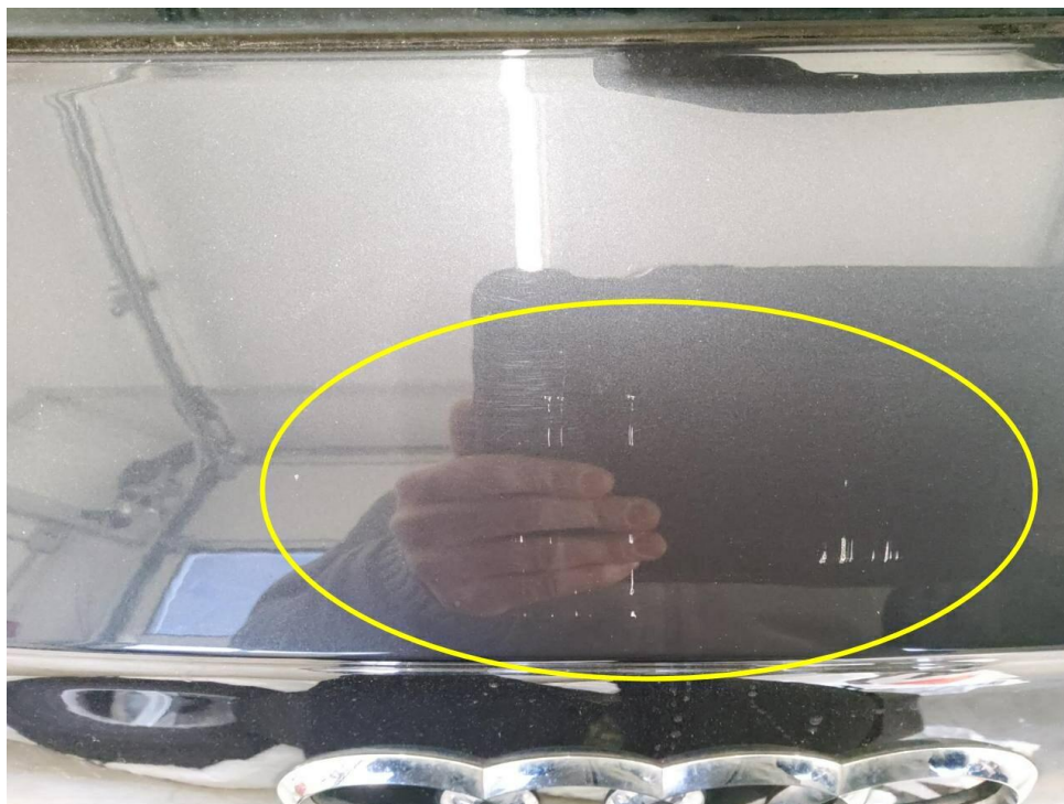
Bild 17 : Heckklappe Lackierung oberhalb, zerkratzt, lackieren mit Lackaufbau
