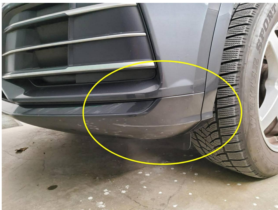
Bild 22 : Stoßfänger vorne Lackierung, zerkratzt, lackieren mit Lackaufbau
