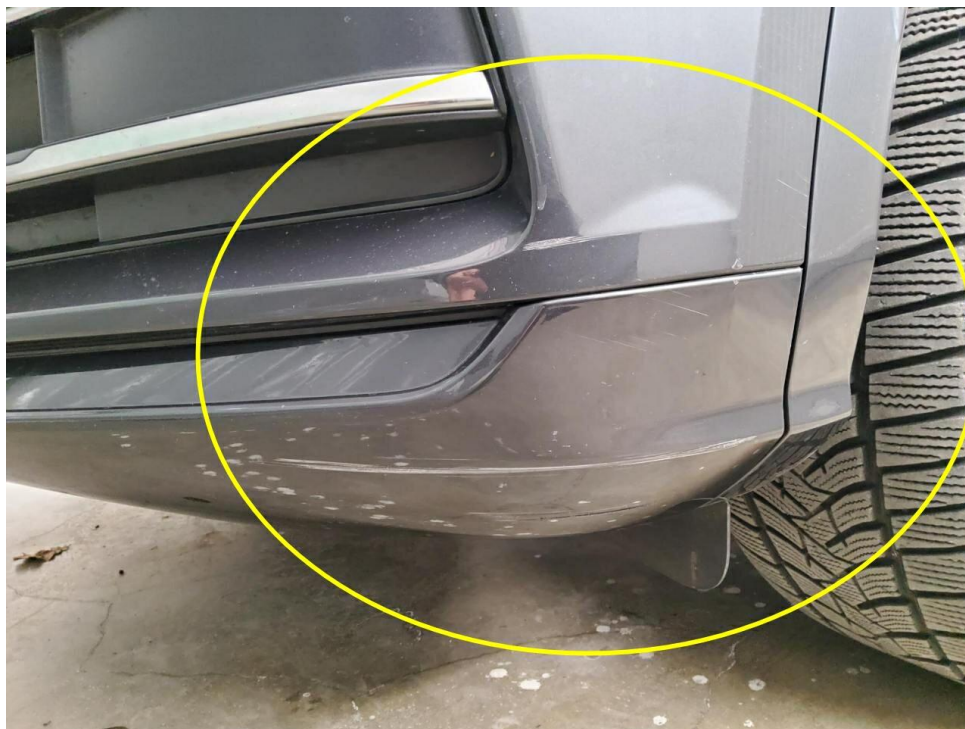
Bild 21 : Stoßfänger vorne Lackierung, zerkratzt, lackieren mit Lackaufbau
