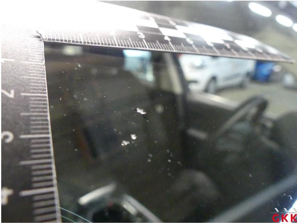
Bild 17 Frontscheibe, mit Regensensor und Frontkamera, Steinschlag mit Rissbildung, instand setzen
