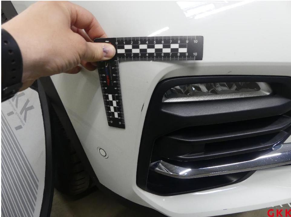
Bild 23 Stoßfänger vorne, Verkleidung -lackiert-, verkratzt, Smartrepair
