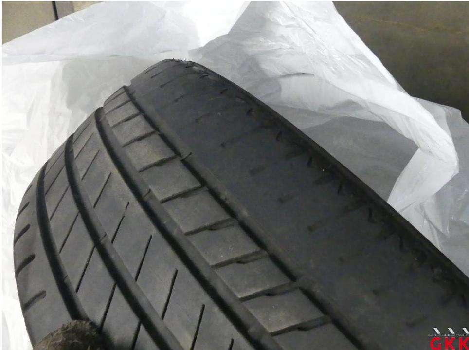
Bild 27 Reifen, 2 x beiliegend, einseitig abgefahren, ersetzen
