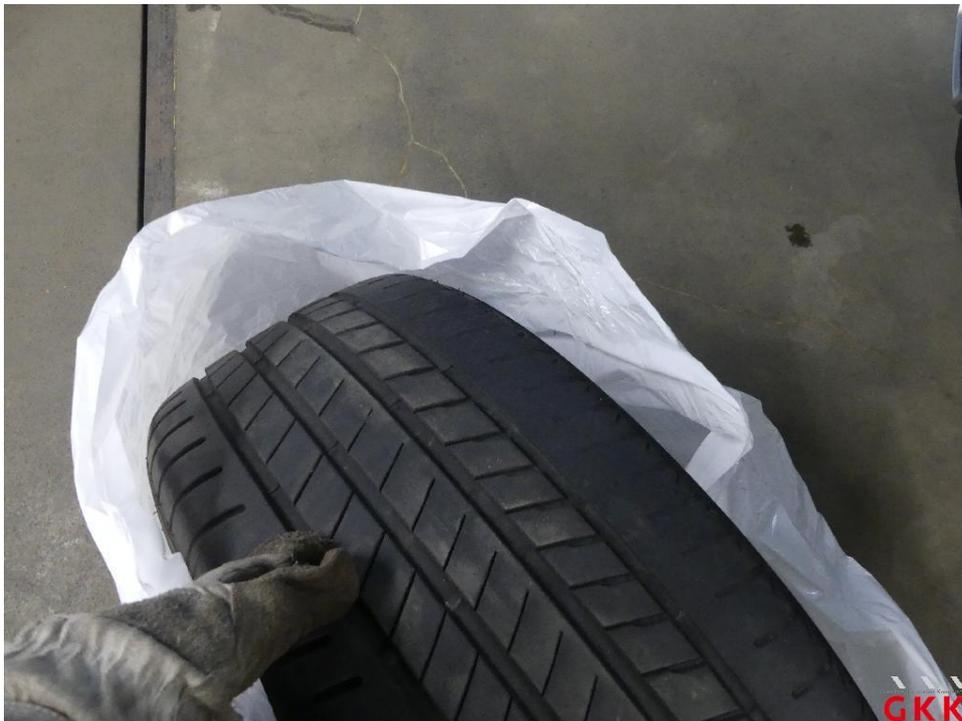
Bild 26 Reifen, 2 x beiliegend, einseitig abgefahren, ersetzen
