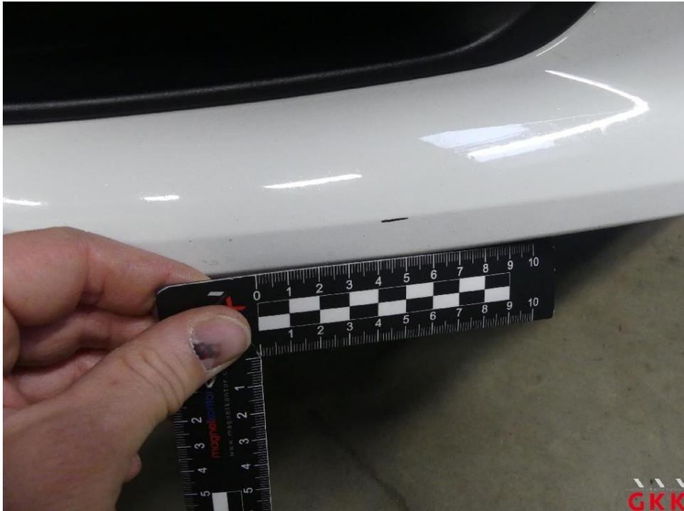
Bild 25 Stoßfänger vorne, Verkleidung -lackiert-, verkratzt, Smartrepair
