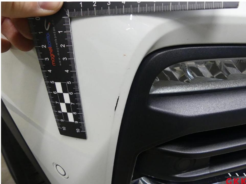
Bild 24 Stoßfänger vorne, Verkleidung -lackiert-, verkratzt, Smartrepair
