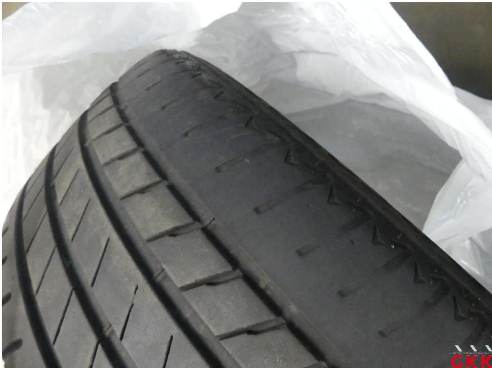
Bild 28 Reifen, 2 x beiliegend, einseitig abgefahren, ersetzen
