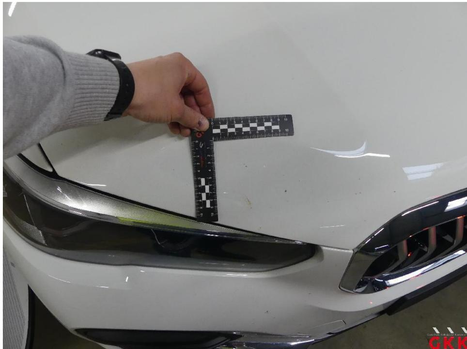
Bild 20 Motorhaube, Steinschlag, lackieren
