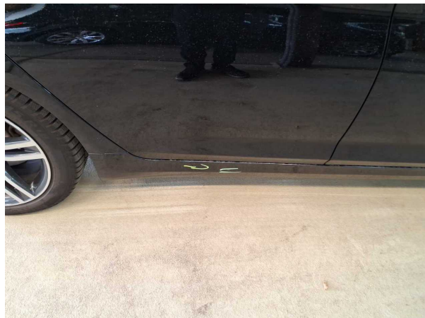
Domage #9: Seuil droit: Habillage - Eraflé - Réparer et repeindre
