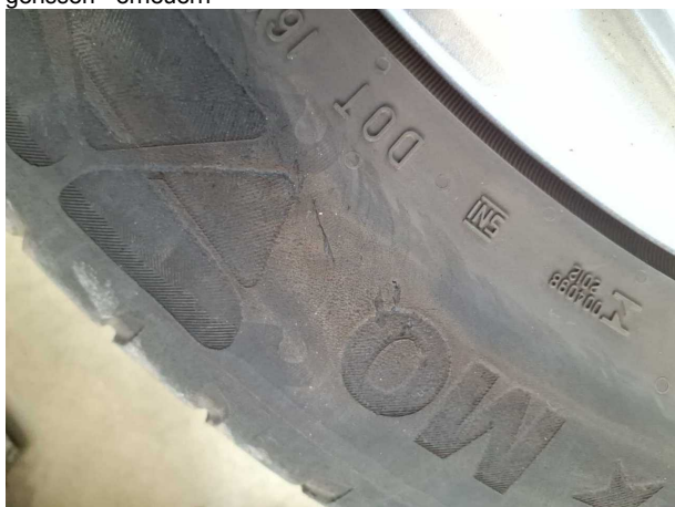
Beschädigung #2: Rad/Reifen: Reifen vorn links - gebrochen / gerissen - erneuern
