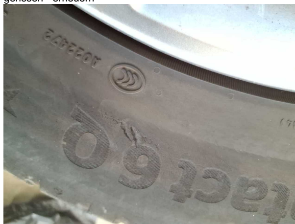
Beschädigung #2: Rad/Reifen: Reifen vorn links - gebrochen / gerissen - erneuern
