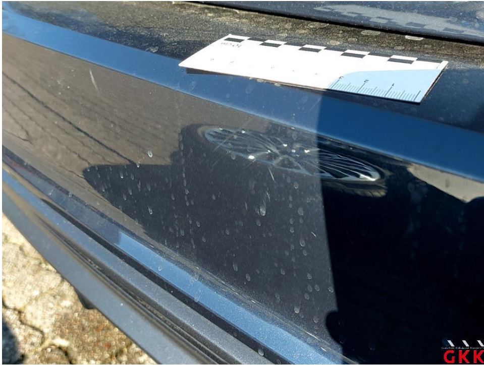
Bild 29. Stoßfänger hinten, Verkleidung -lackiert-, verkratzt, auslegen, schleifen, polieren
