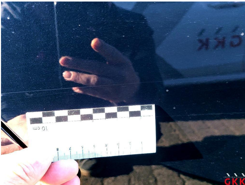
Bild 24. Tür hinten rechts, verkratzt, auslegen, schleifen, polieren
