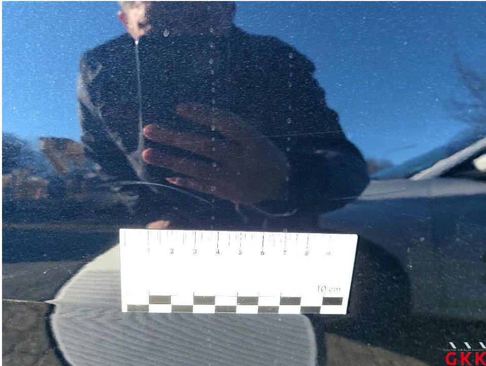
Bild 27. Seitenwand rechts, verkratzt, lackieren
