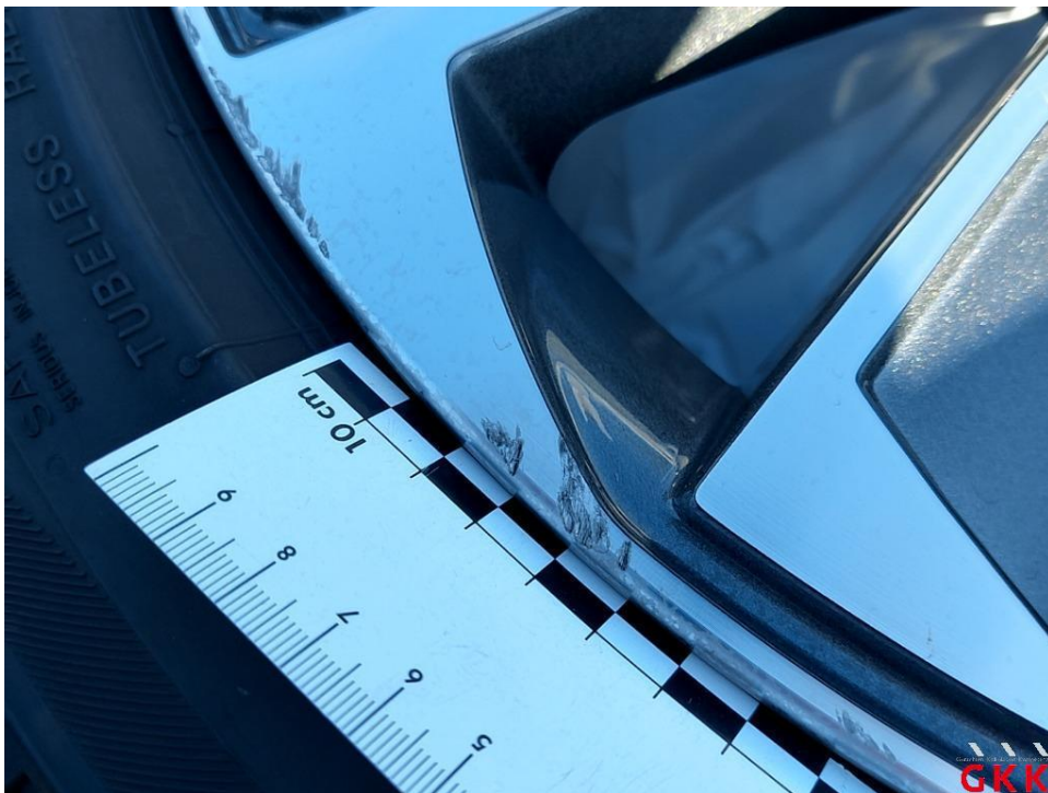
Bild 14. LM-Rad, 1 x beiliegend, Materialabtrag, ersetzen
