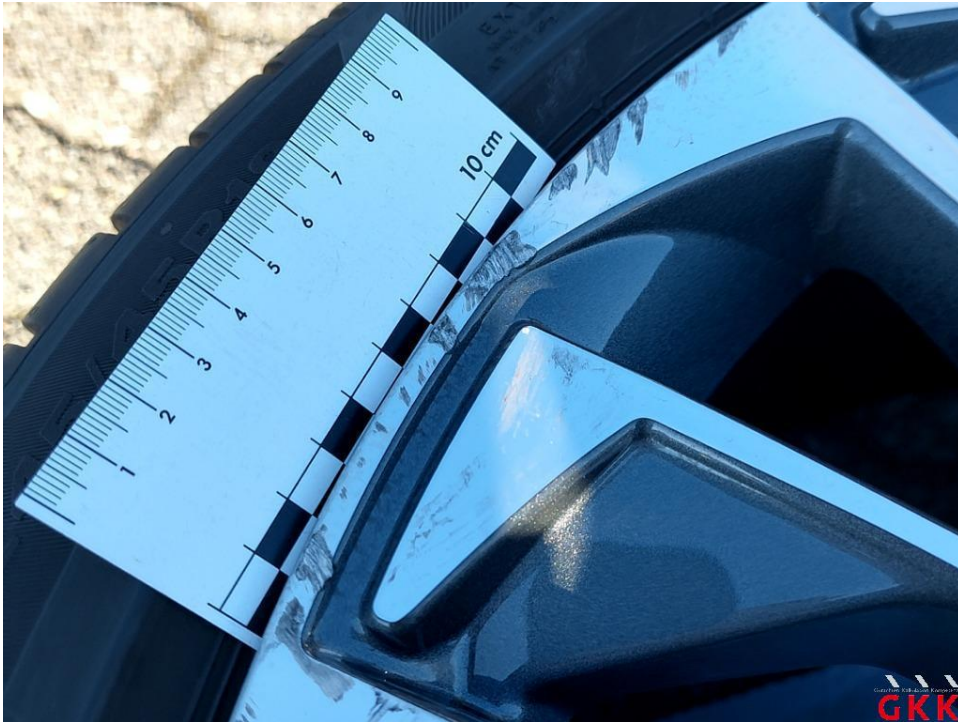
Bild 17. LM-Rad, 1 x beiliegend, verkratzt, ersetzen
