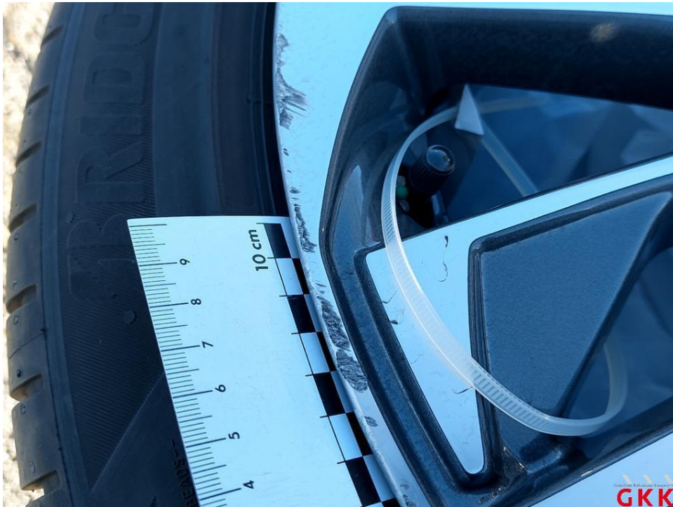
Bild 16. LM-Rad, 1 x beiliegend, verkratzt, ersetzen
