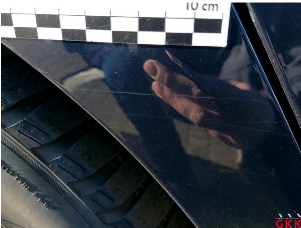
Bild 26. Seitenwand rechts, verkratzt, lackieren
