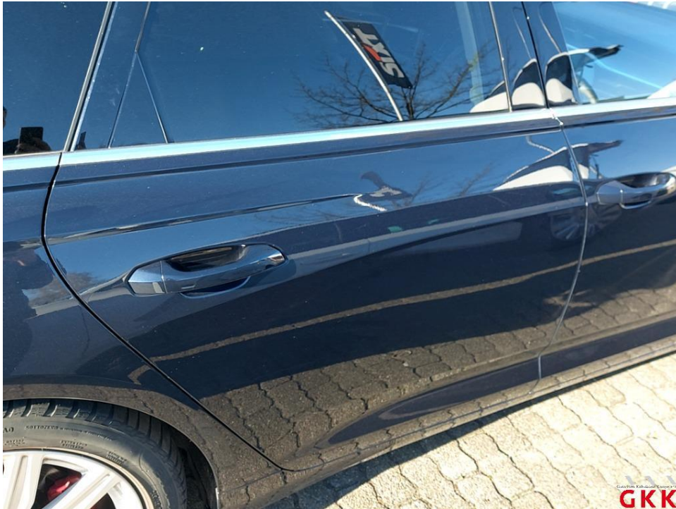
Bild 23. Tür hinten rechts, verkratzt, auslegen, schleifen, polieren
