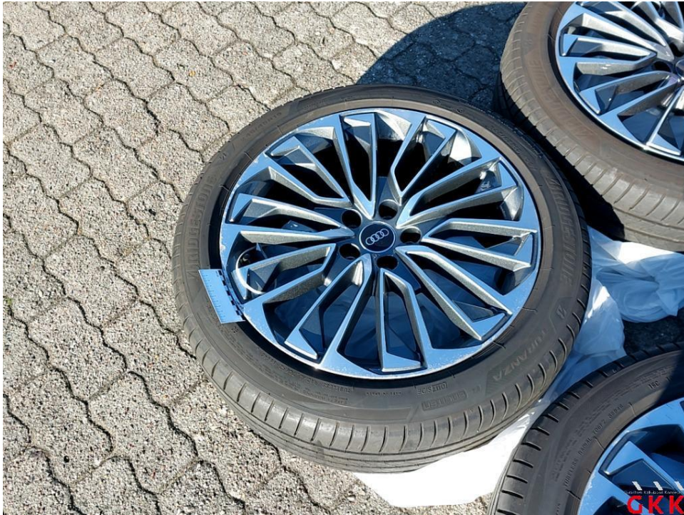
Bild 15. LM-Rad, 1 x beiliegend, verkratzt, ersetzen
