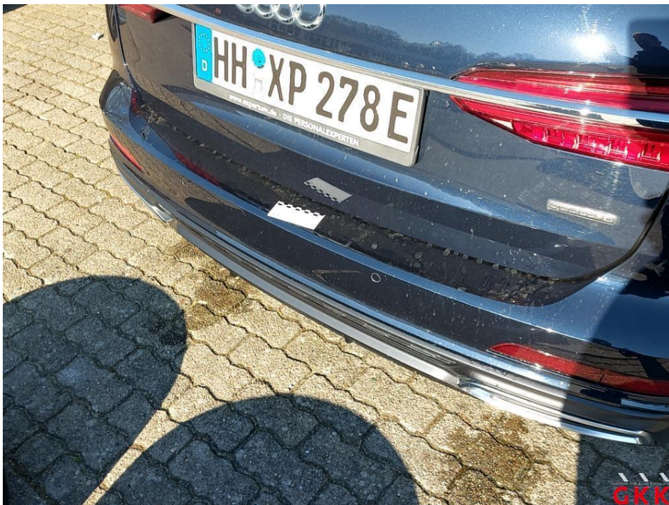
Bild 28. Stoßfänger hinten, Verkleidung -lackiert-, verkratzt, auslegen, schleifen, polieren
