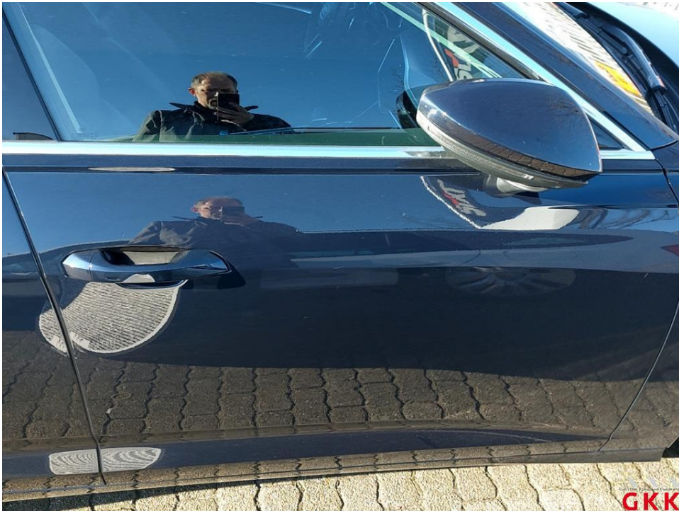
Bild 18. Tür vorne rechts, verkratzt, lackieren
