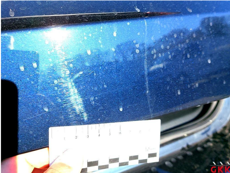
Bild 31. Heckklappe, unterhalb, verkratzt, lackieren
