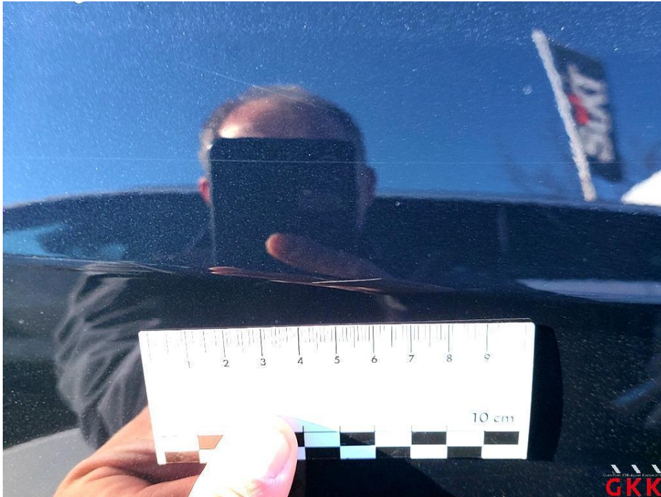
Bild 19. Tür vorne rechts, verkratzt, lackieren
