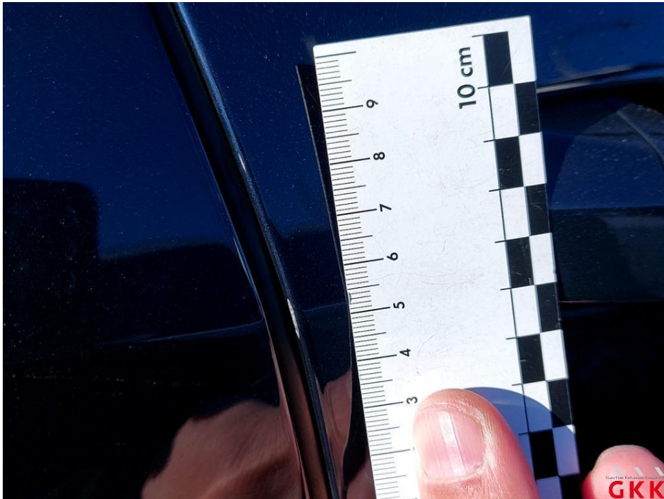
Bild 20. Tür vorne rechts, verkratzt, lackieren
