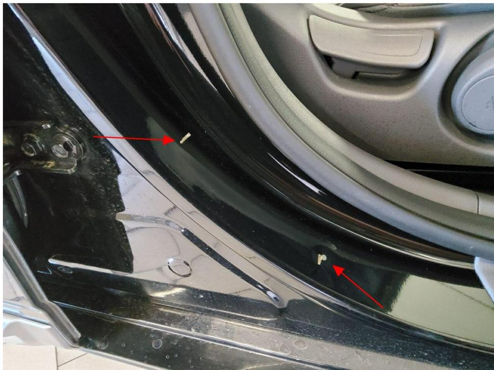
Bild 9 : Tür vorne rechts Einstieg Lackierung, zerkratzt, smart repair
