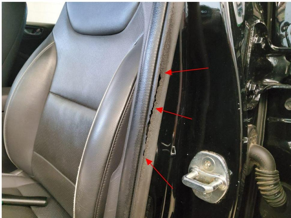
Bild 11 : Türdichtung vorne links zerrissen
