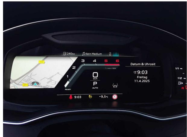
**Abbildung 10: Kombiinstrument**
