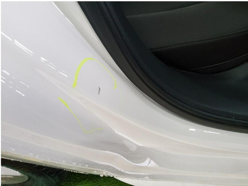
Bild 14 : Tür hinten rechts Einstieg, eingedellt, smart repair
