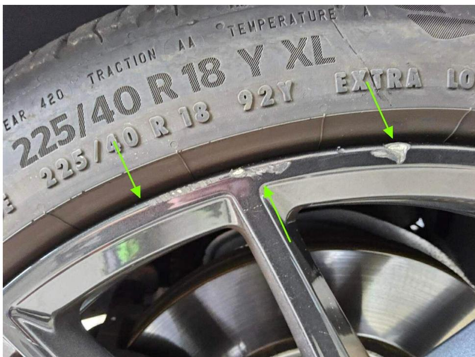
Bild 26 : Felge vorne links, zerkratzt, smart repair
