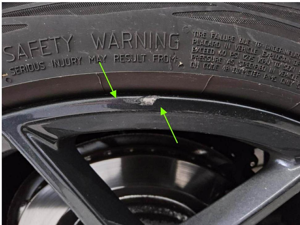
Bild 28 : Felge hinten links, zerkratzt, smart repair
