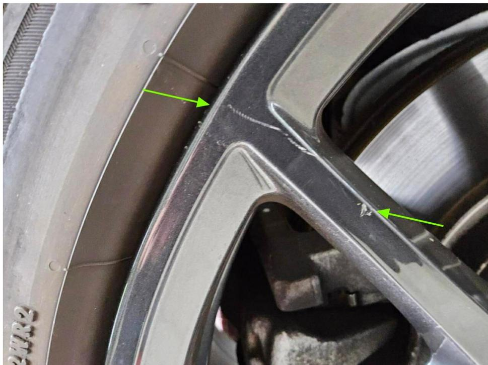
Bild 25 : Felge vorne links, zerkratzt, smart repair
