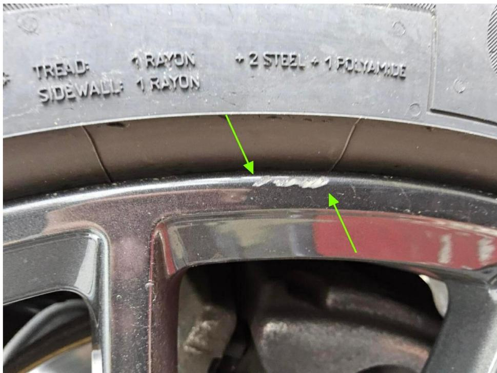
Bild 32 : Felge vorne rechts, zerkratzt, smart repair
