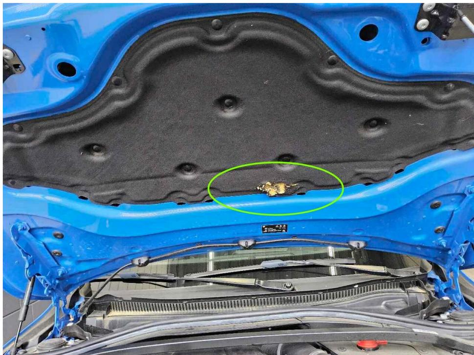
Bild 35 : Motorraum, Motorhaubendämmmatte gerissen
