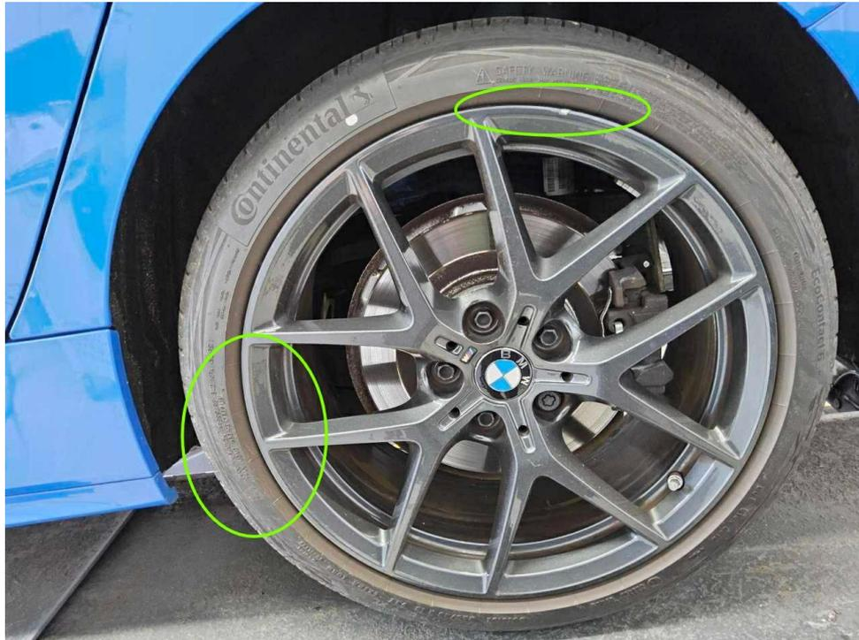
Bild 27 : Felge hinten links, zerkratzt, smart repair
