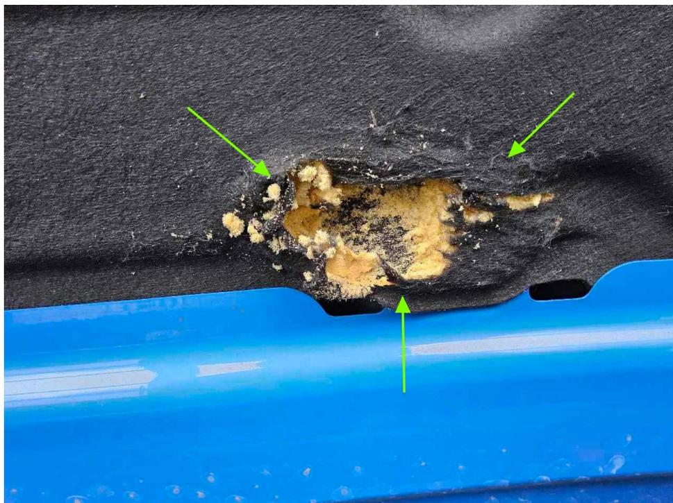
Bild 36 : Motorraum, Motorhaubendämmmatte gerissen
