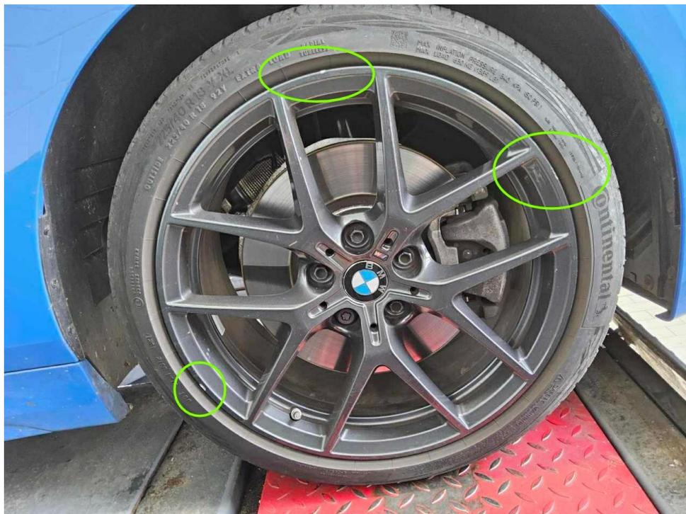
Bild 29 : Felge vorne rechts, zerkratzt, smart repair
