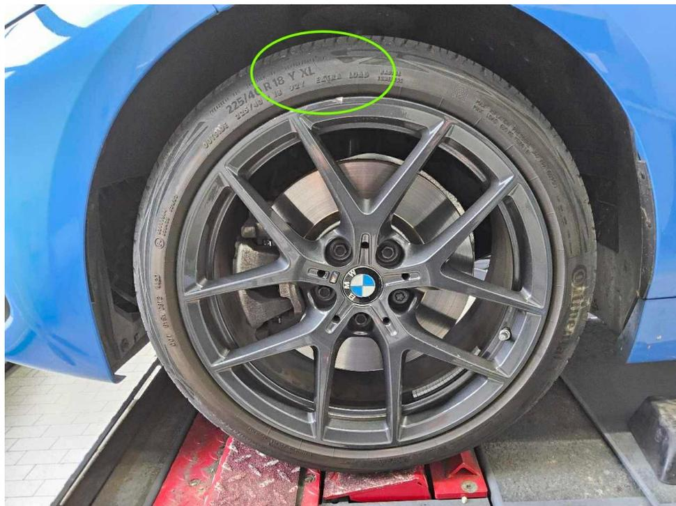
Bild 33 : Reifen vorne links, Flanke eingerissen, erneuern
