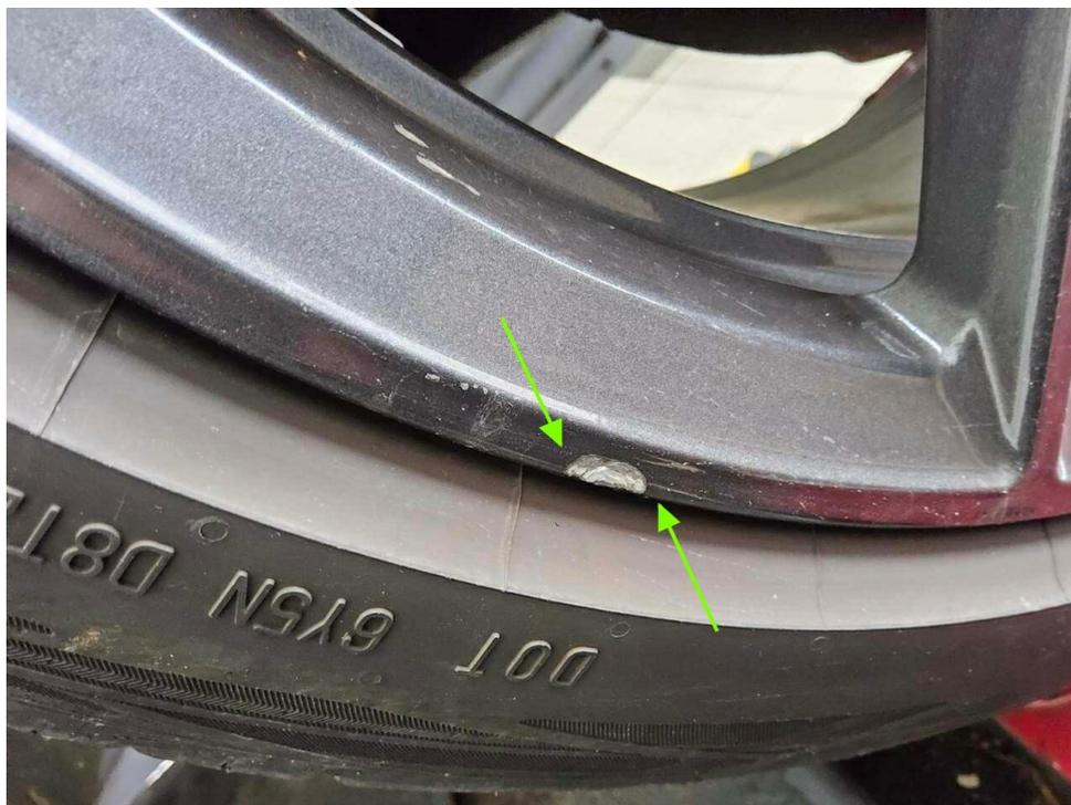
Bild 30 : Felge vorne rechts, zerkratzt, smart repair
