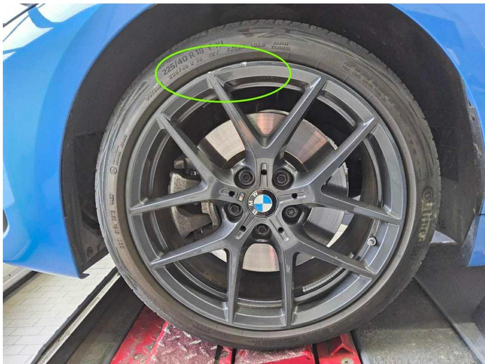
Bild 24 : Felge vorne links, zerkratzt, smart repair
