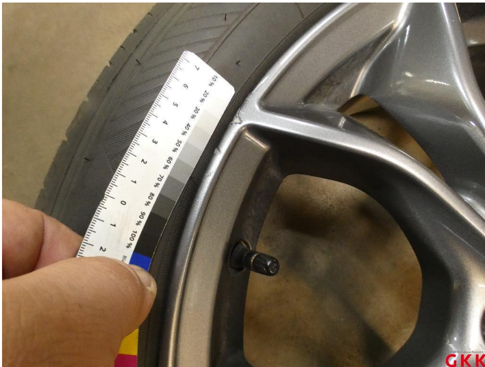
Bild 20 LM-Rad, 1 x beiliegend, Materialabtrag, ersetzen
