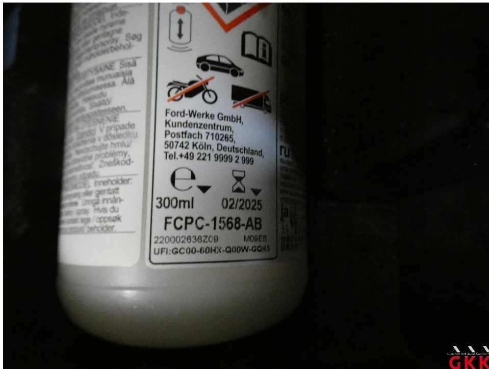
Bild 22 Reifenreparaturset, Füllflasche, MHD überschritten, ersetzen
