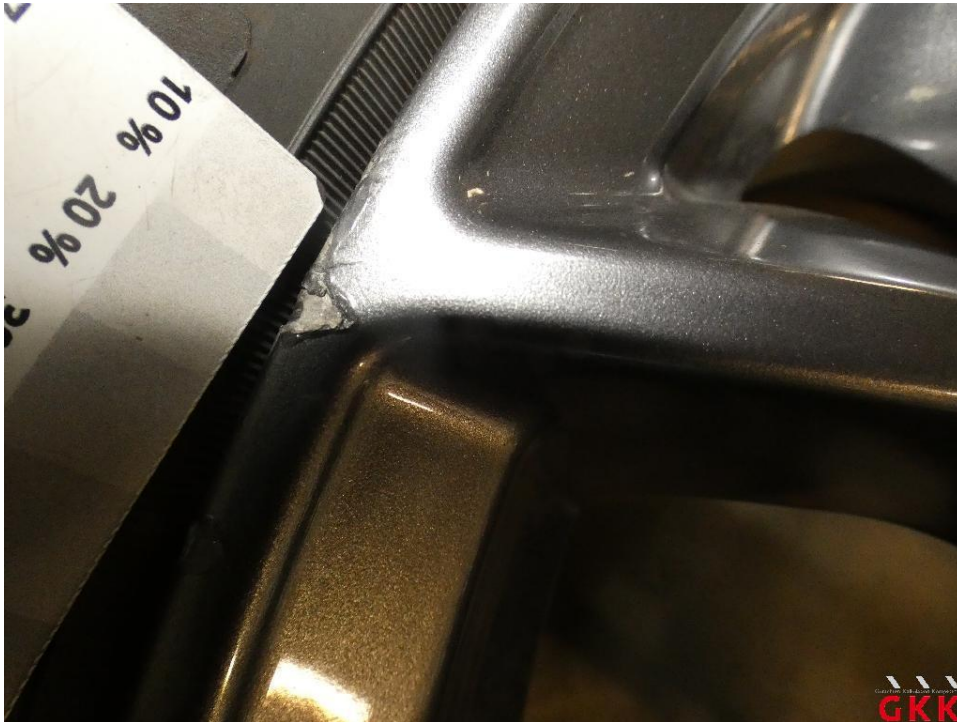
Bild 21 LM-Rad, 1 x beiliegend, Materialabtrag, ersetzen
