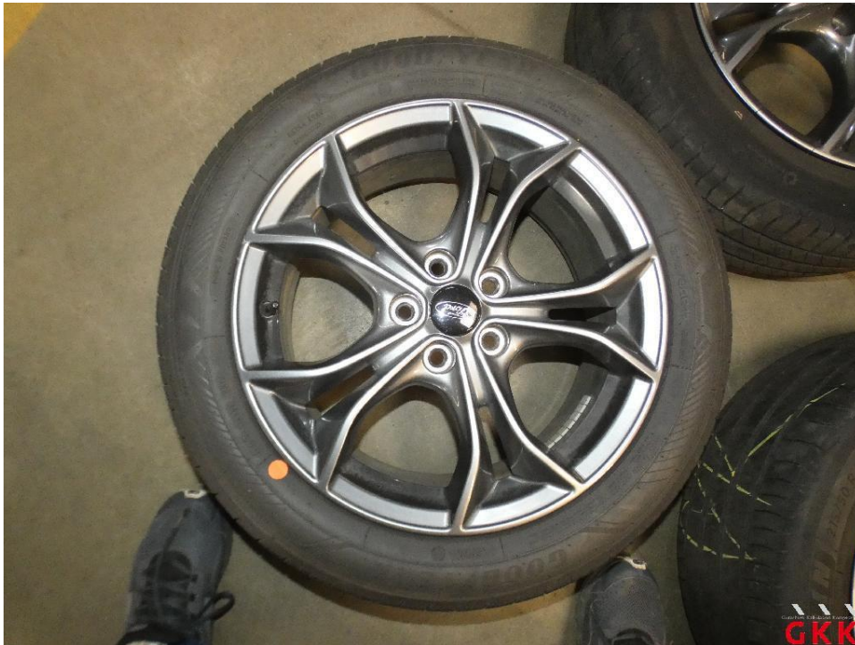
Bild 19 LM-Rad, 1 x beiliegend, Materialabtrag, ersetzen
