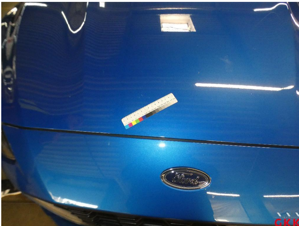
Bild 16 Motorhaube, Steinschlag, lackieren
