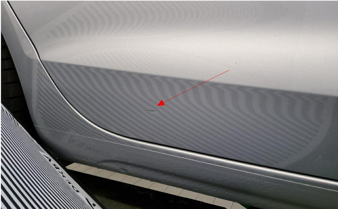
Bild 15 : Tür hinten rechts, eingedellt, smart repair
