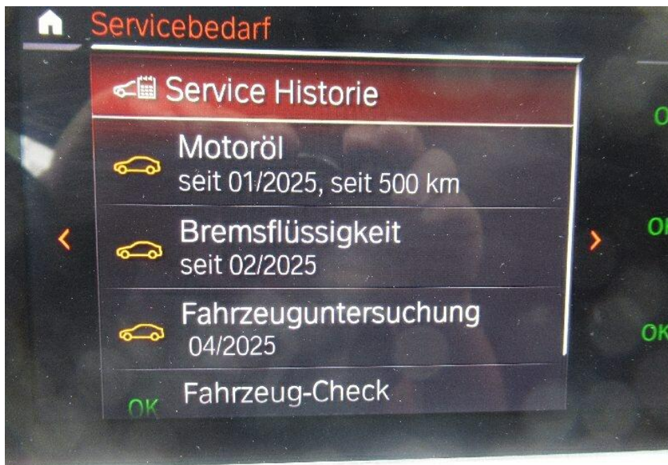
Bild 13 : Ölservice und wechsel der Bremsflüssigkeit fällig
