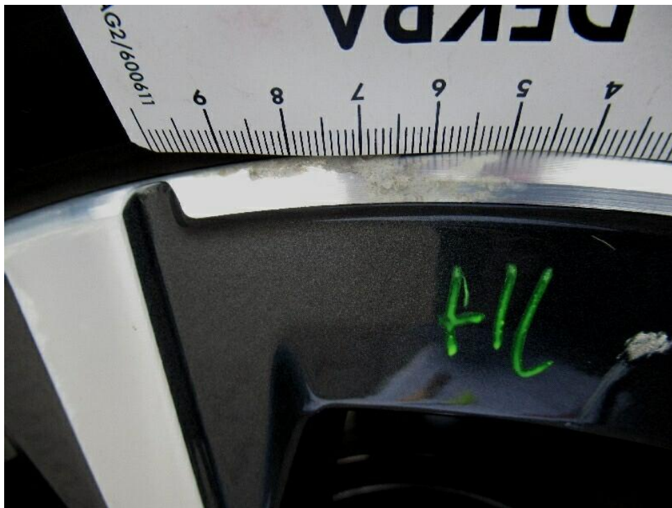
Bild 14 : Glanzgedrehte Leichtmetallfelge hinten links beschädigt
