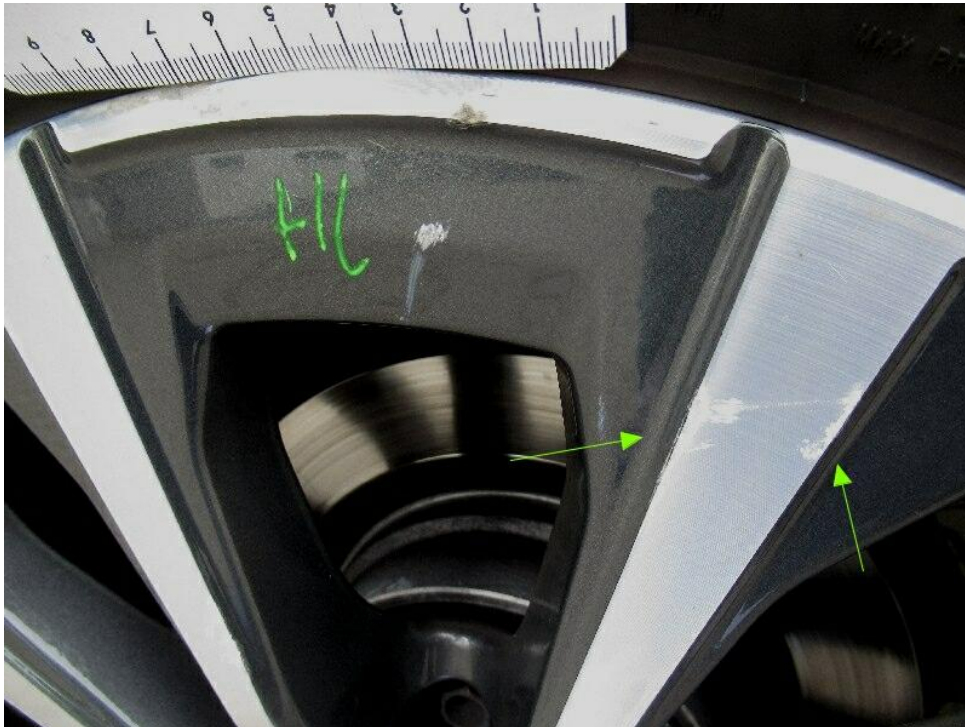
Bild 15 : Glanzgedrehte Leichtmetallfelge hinten links beschädigt
