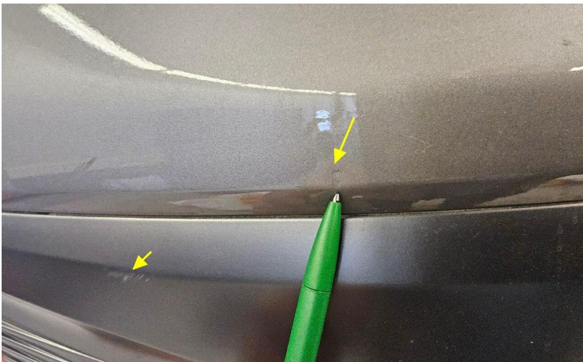
Bild 8 : Stoßfänger hinten Lackierung, zerkratzt, Gebrauchsspur
