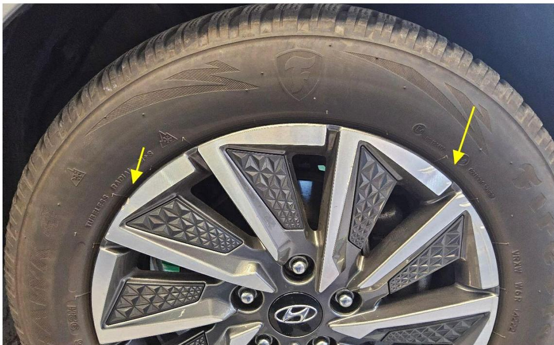
Bild 10 : Achse 1, Reifen Rechts Hochglanzfelge vorne rechts verschrammt > 20mm
