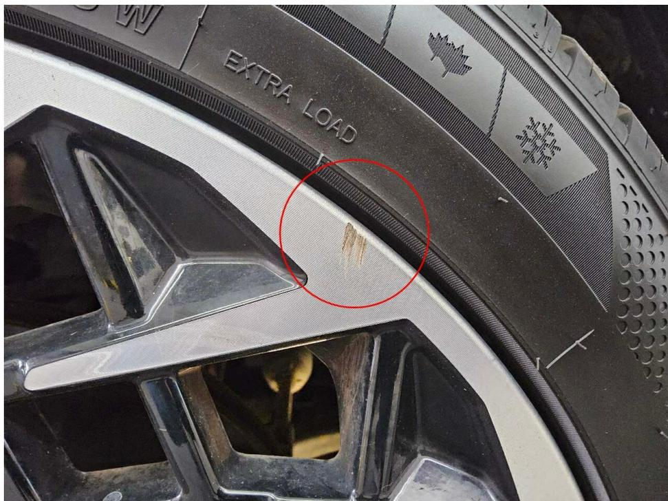
Bild 10 : Alufelge vorne links, verschrammt
