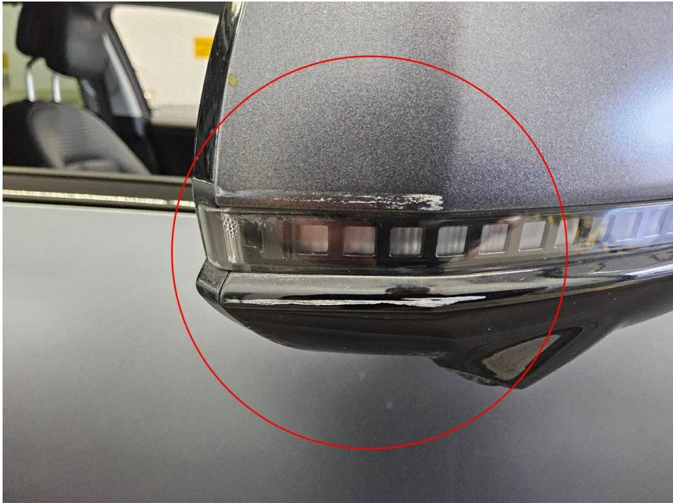
Bild 19 : Außenspiegel rechts, verschrammt
