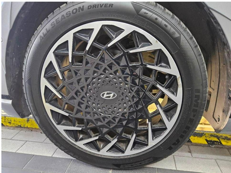
Bild 8 : Alufelge vorne links, verschrammt
