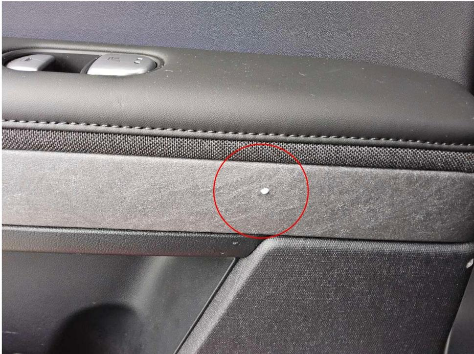
Bild 15 : Türverkleidung hinten links, verschrammt
