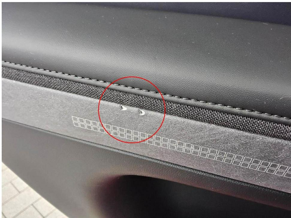
Bild 14 : Türverkleidung hinten links, verschrammt
