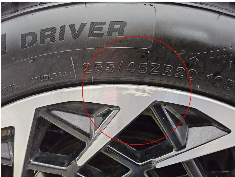
Bild 12 : Alufelge hinten rechts, verschrammt
