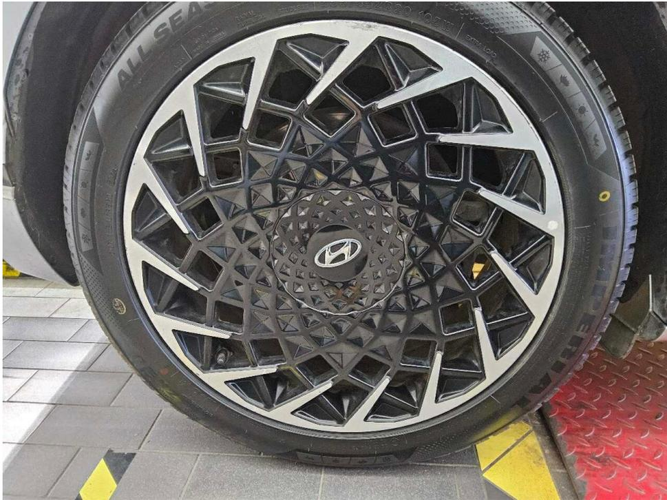
Bild 11 : Alufelge hinten rechts, verschrammt
