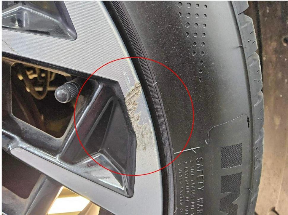
Bild 9 : Alufelge vorne links, verschrammt
