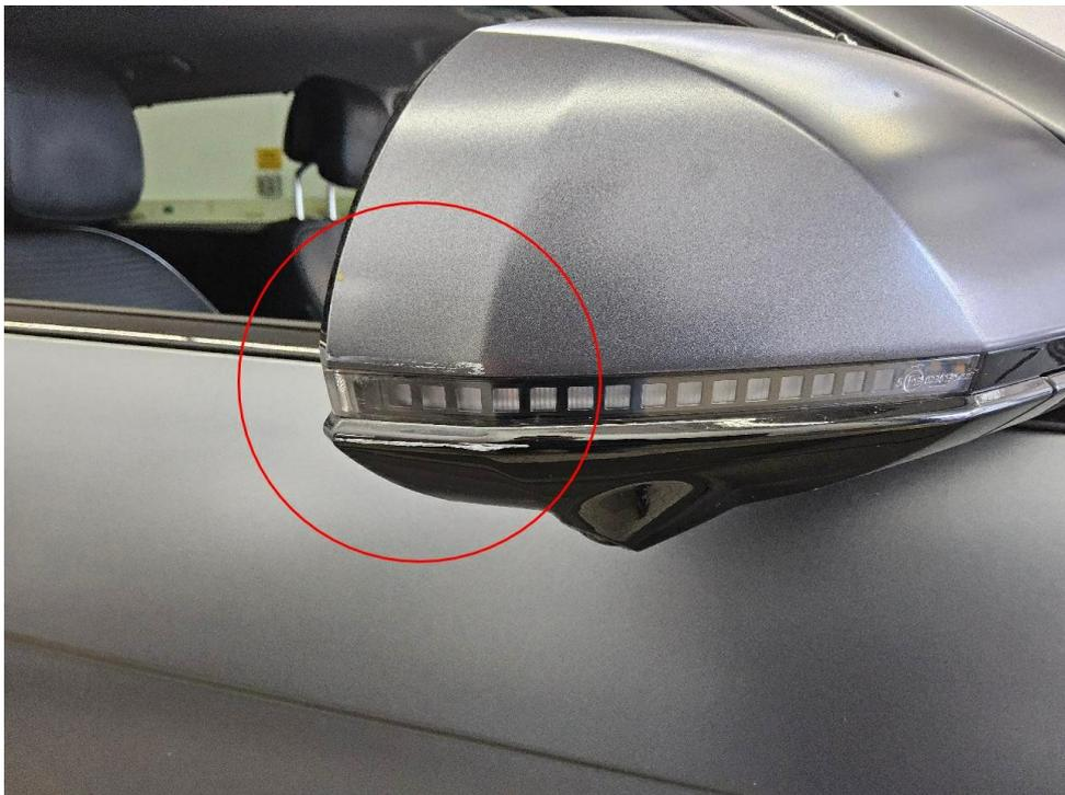
Bild 18 : Außenspiegel rechts, verschrammt
