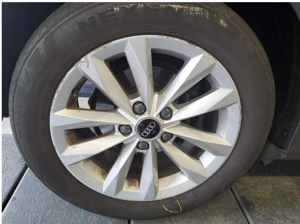
Bild 24 : Felge hinten rechts verschrammt
