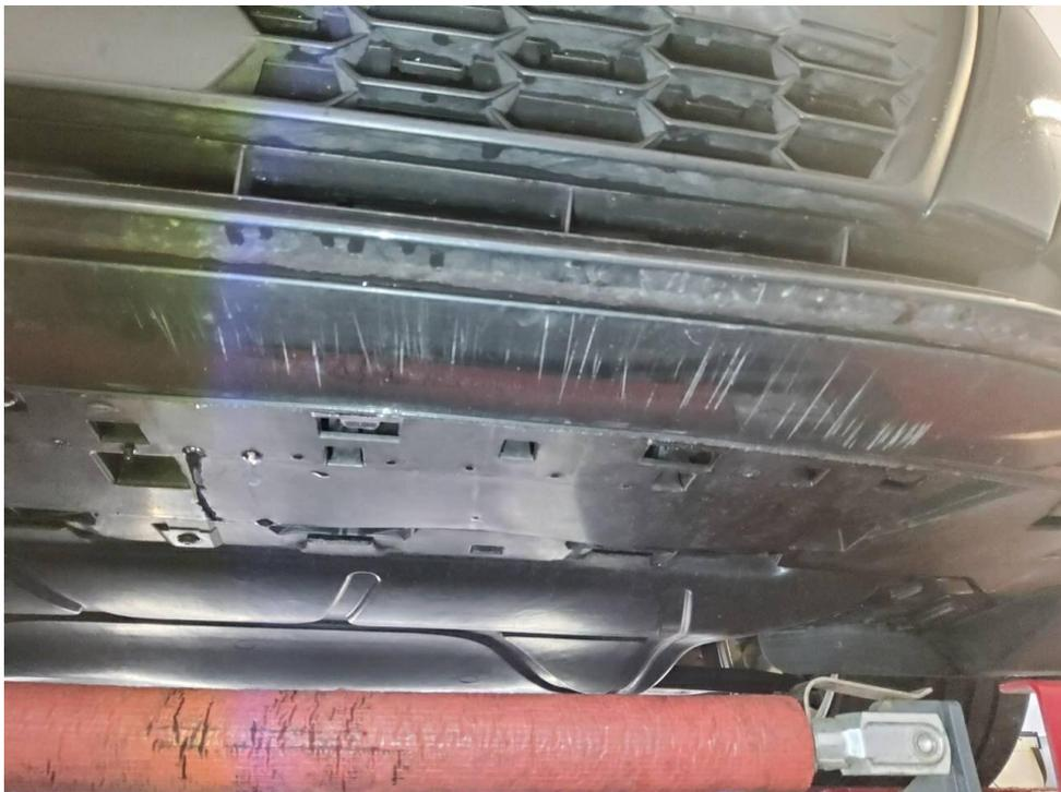
Bild 14 : Stoßfänger vorne unten zerkratzt
