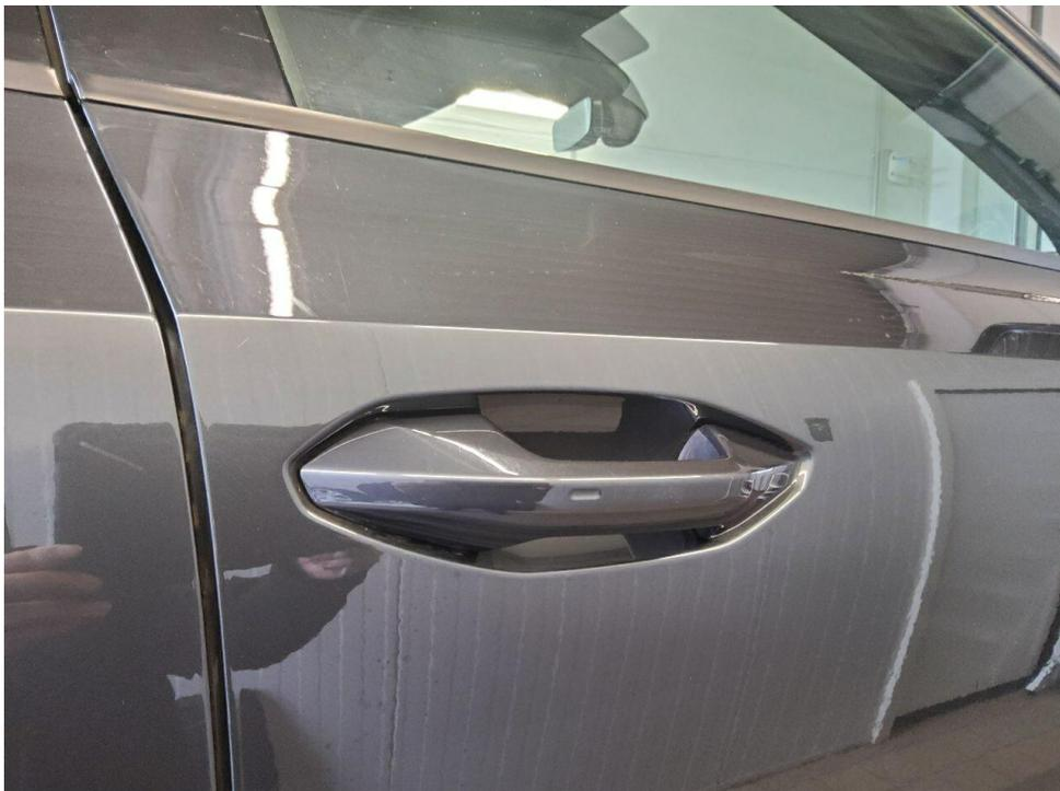
Bild 20 : Tür vorne rechts zerkratzt
