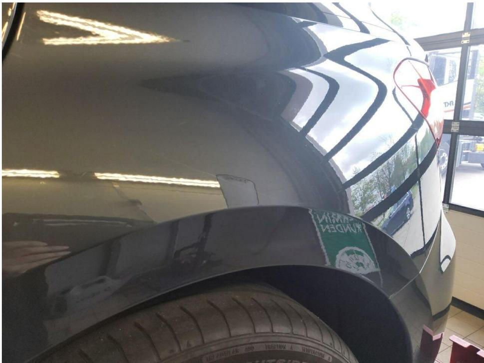
Bild 16 : Seitenwand hinten rechts zerkratzt
