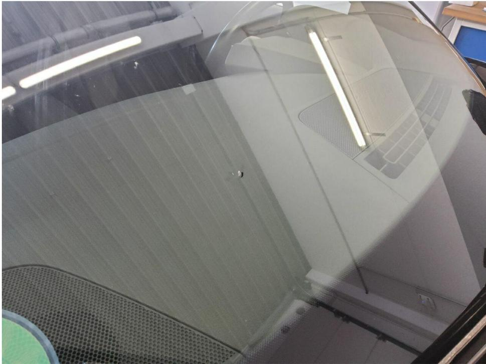
Bild 21 : Frontscheibe reparierter Steinschlag
