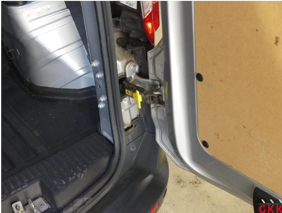
Bild 21 Hecktür rechts, Scharnier -unten-, schwergängig, instand setzen
