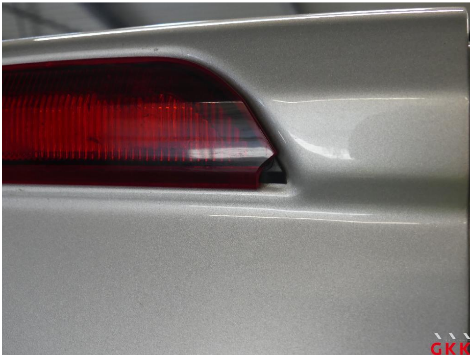
Bild 18 Zusatzbremsleuchte, gerissen, ersetzen
