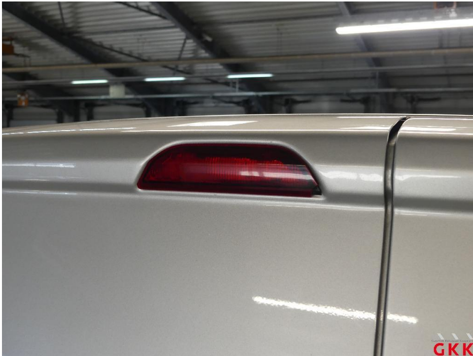
Bild 17 Zusatzbremsleuchte, gerissen, ersetzen
