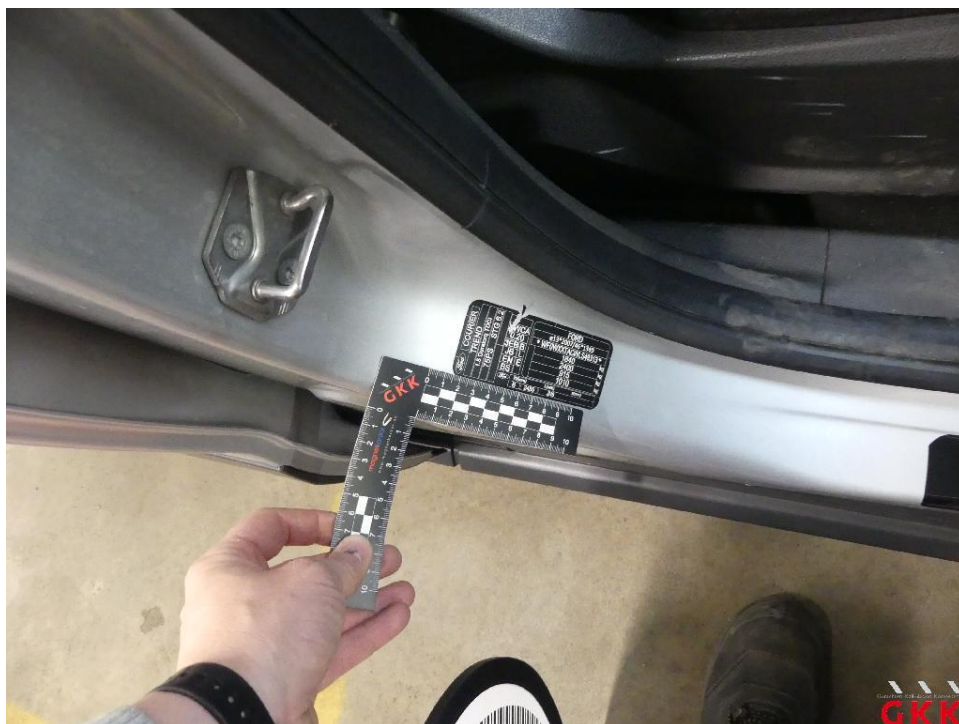
Bild 14 Tür vorne rechts, Einstieg, verkratzt, Smartrepair
