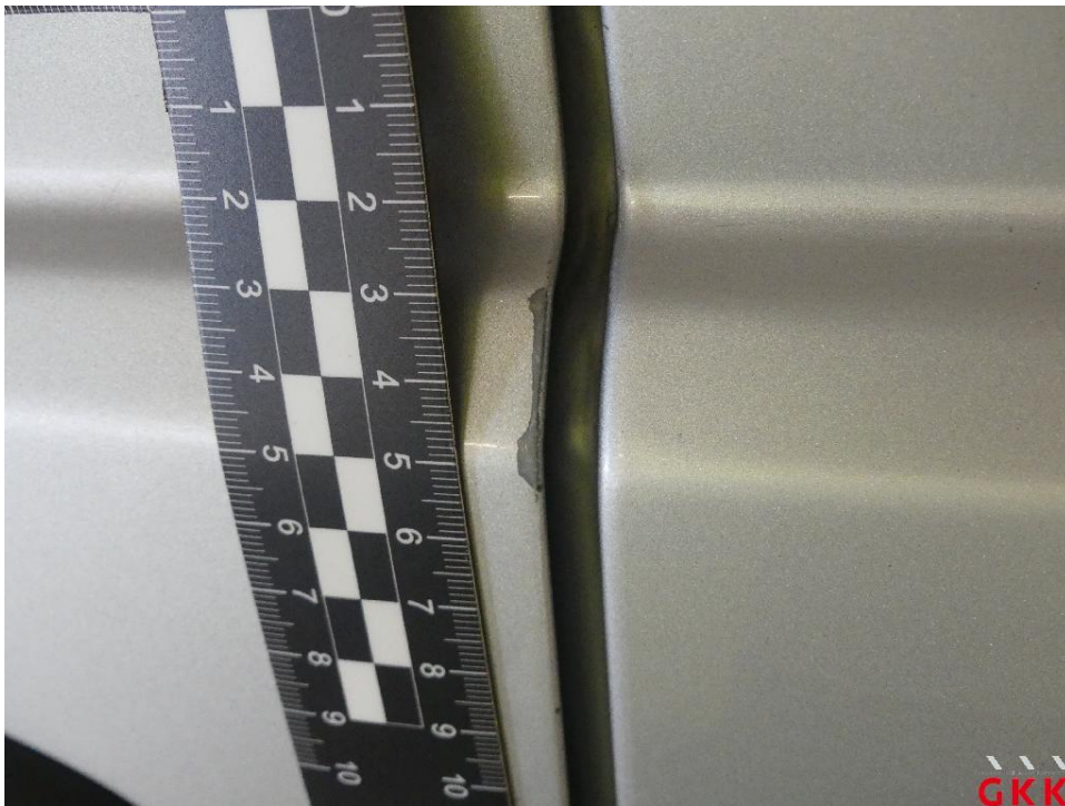
Bild 20 Hecktür links, Kante, verkratzt, auslegen, schleifen, polieren
