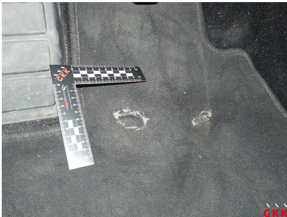
Bild 32 Fußmatte(n), vorne links, beschädigt, ersetzen
