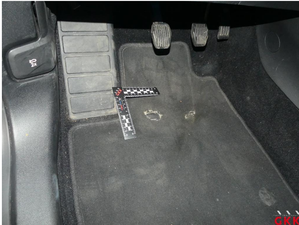
Bild 31 Fußmatte(n), vorne links, beschädigt, ersetzen
