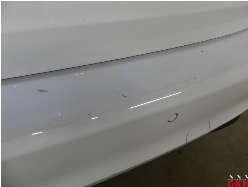
Bild 30 Stoßfänger hinten, Schutzfolie, verkratzt, ersetzen
