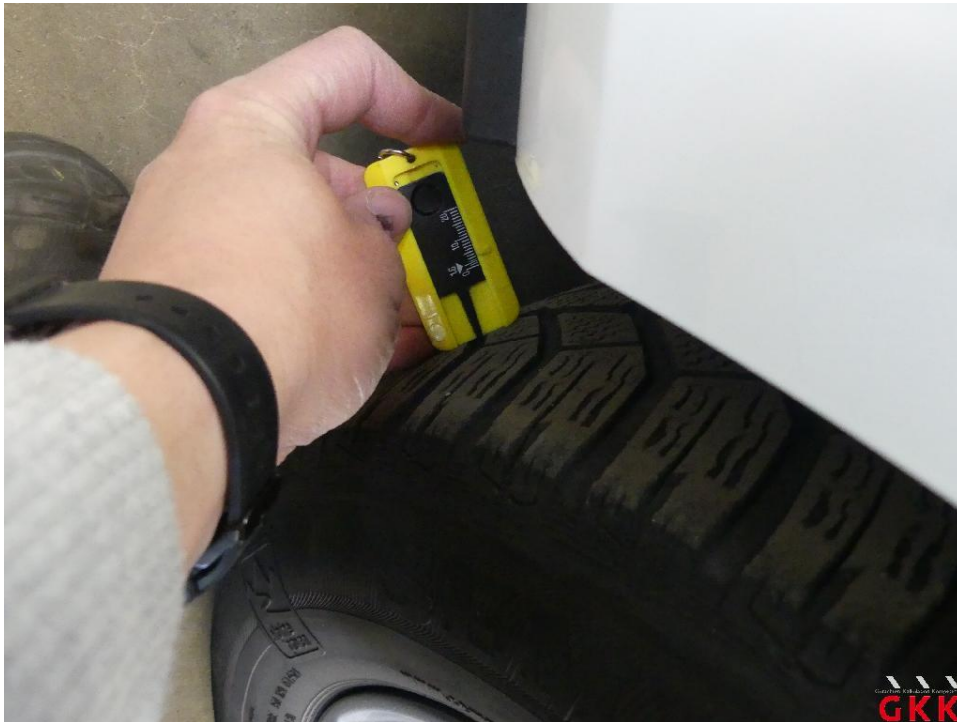
Bild 33 Reifen, vorn links und rechts, Untermaß, ersetzen
