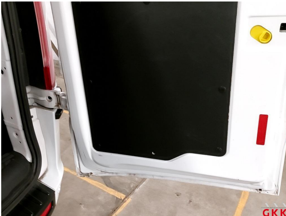
Bild 22 Hecktür rechts, Innenverkleidung, lose, instand setzen
