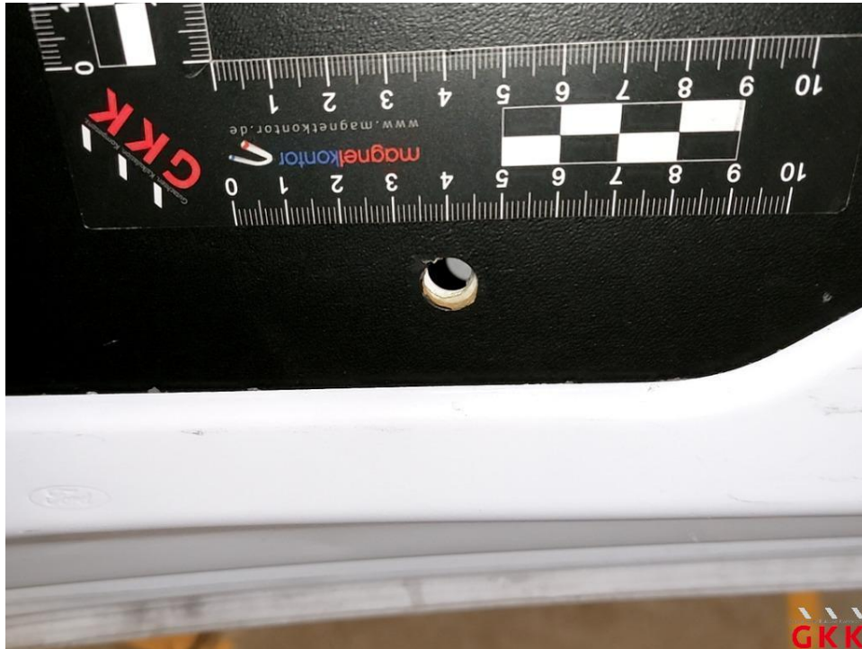
Bild 23 Hecktür rechts, Innenverkleidung, lose, instand setzen
