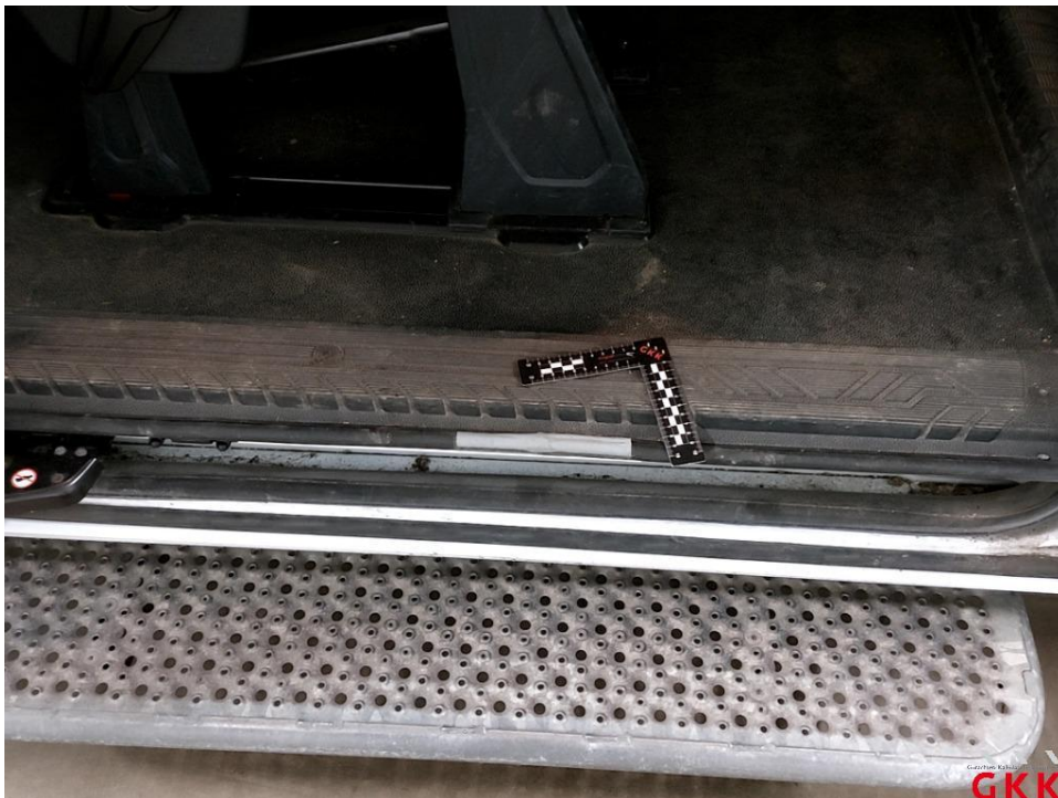
Bild 18 Schiebetür rechts, Dichtung -Einstieg-, beschädigt, ersetzen
