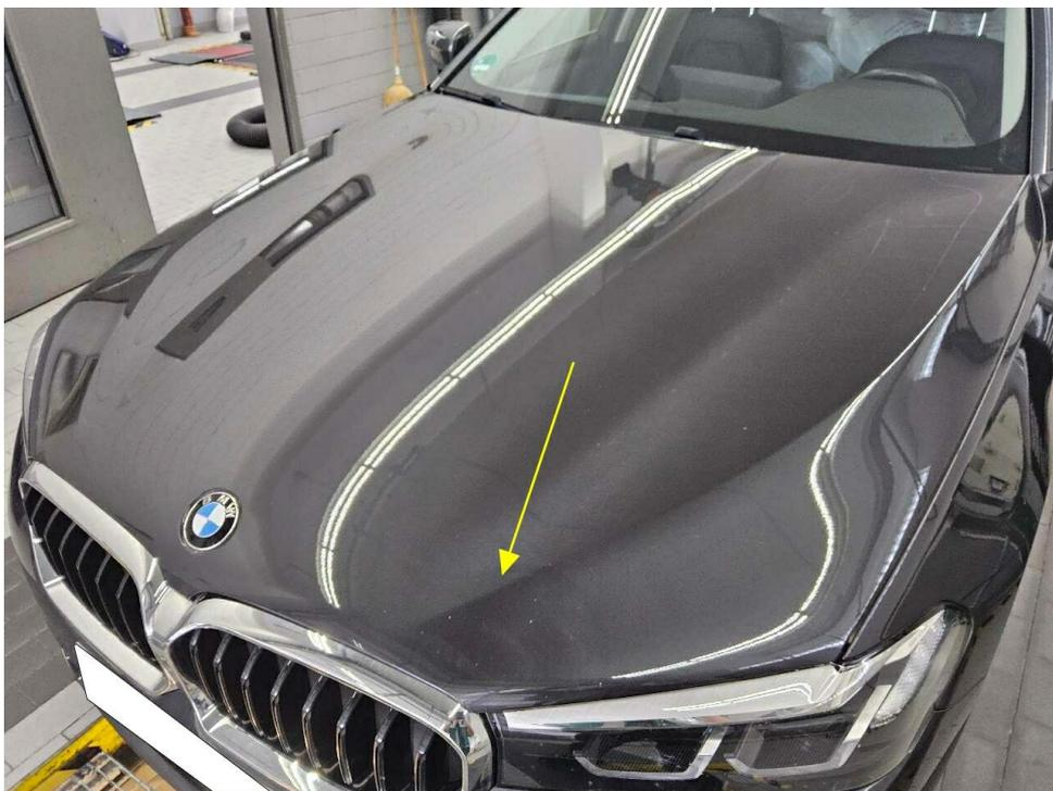
Bild 14 : Motorhaube, Steinschlag
