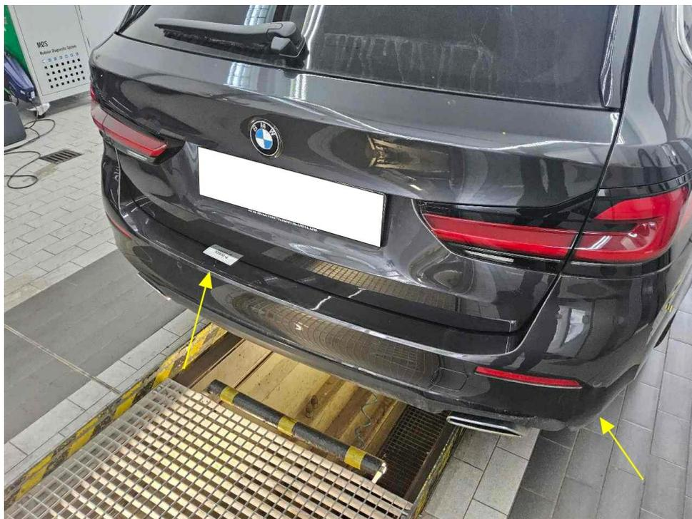
Bild 26 : Stoßfänger hinten Lackierung, zerkratzt, lackieren mit Lackaufbau
