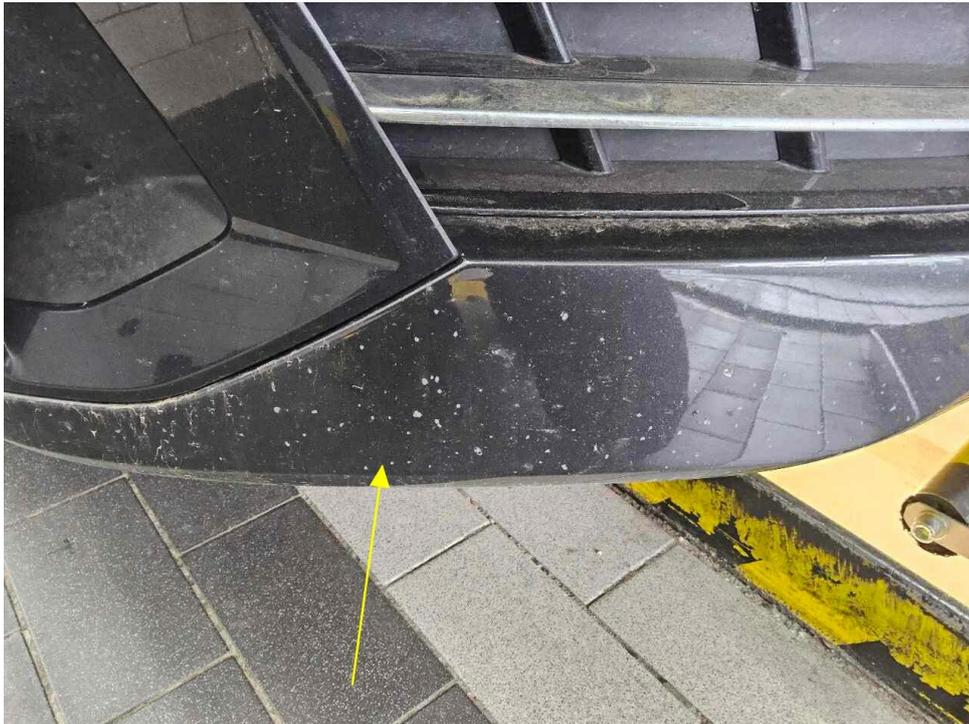
Bild 19 : Stoßfänger vorne Lackierung, Steinschlag, lackieren mit Lackaufbau
