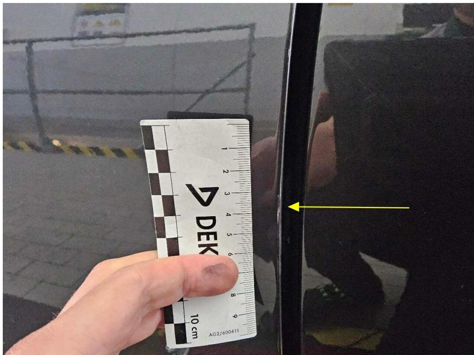
Bild 21 : Türe vorne links Kante, zerkratzt
