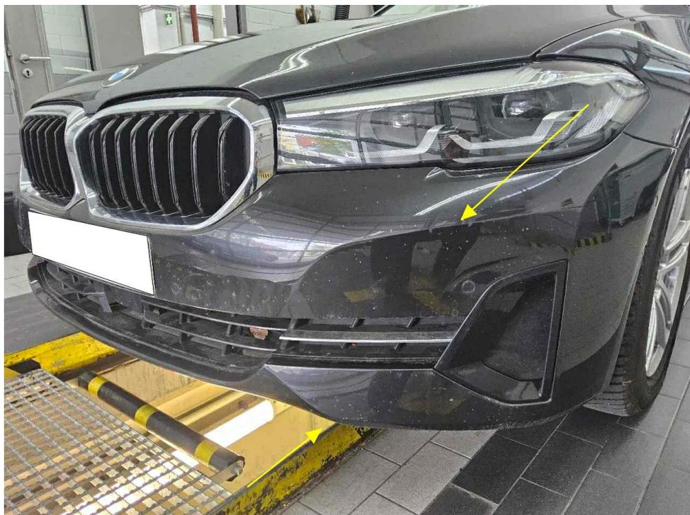
Bild 16 : Stoßfänger vorne Lackierung, Steinschlag, lackieren mit Lackaufbau
