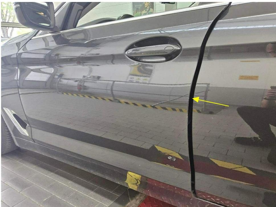
Bild 20 : Türe vorne links Kante, zerkratzt
