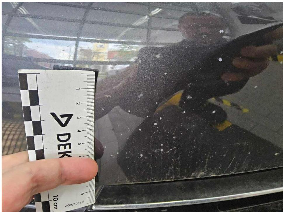
Bild 17 : Stoßfänger vorne Lackierung, Steinschlag, lackieren mit Lackaufbau
