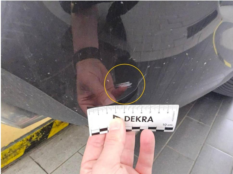
Bild 29 : Stoßfänger hinten Lackierung, zerkratzt, lackieren mit Lackaufbau
