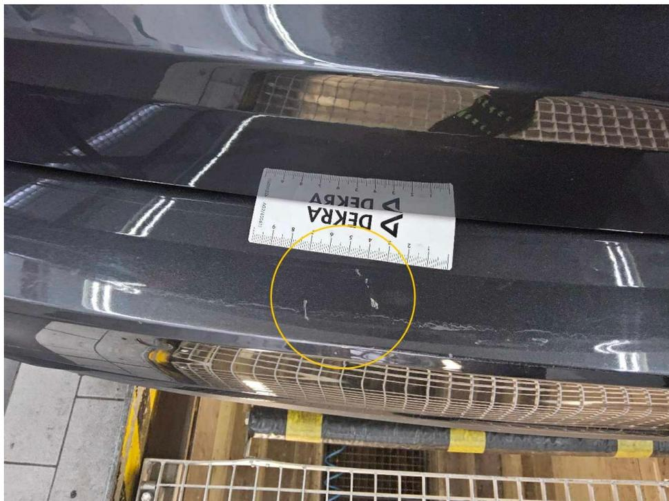
Bild 27 : Stoßfänger hinten Lackierung, zerkratzt, lackieren mit Lackaufbau
