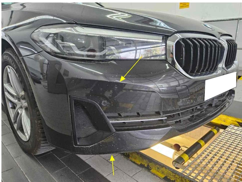
Bild 18 : Stoßfänger vorne Lackierung, Steinschlag, lackieren mit Lackaufbau
