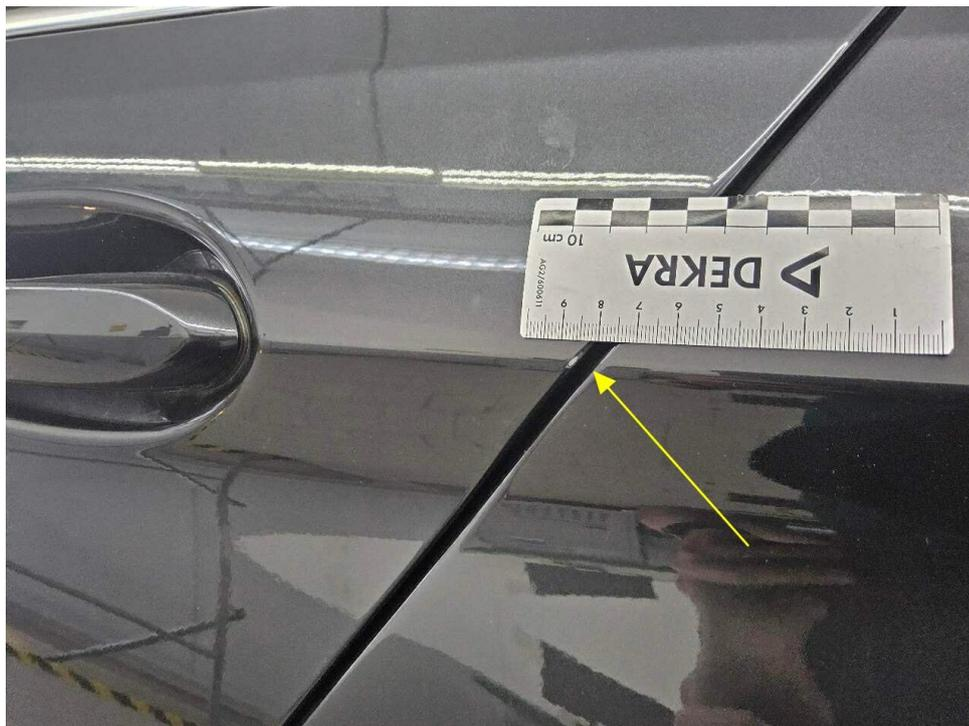
Bild 25 : Tür hinten links Kante, zerkratzt
