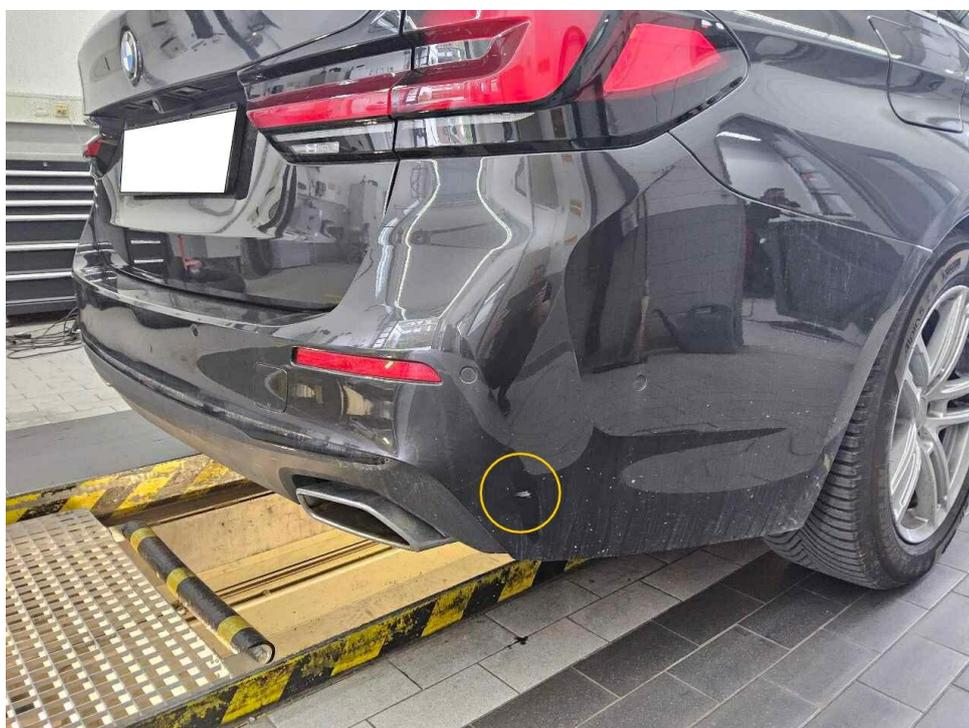
Bild 28 : Stoßfänger hinten Lackierung, zerkratzt, lackieren mit Lackaufbau
