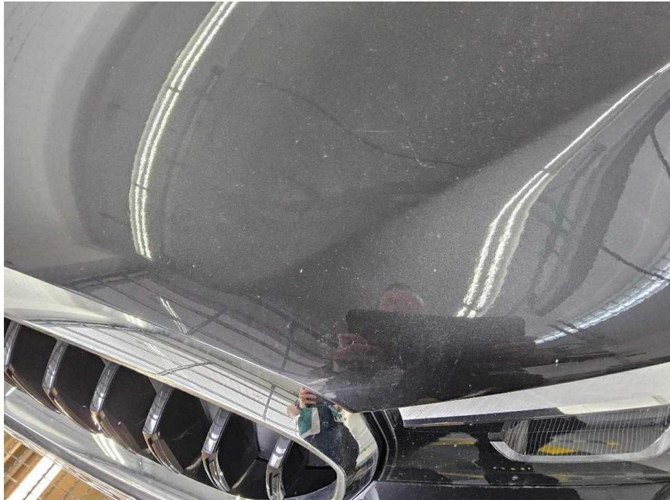
Bild 15 : Motorhaube, Steinschlag
