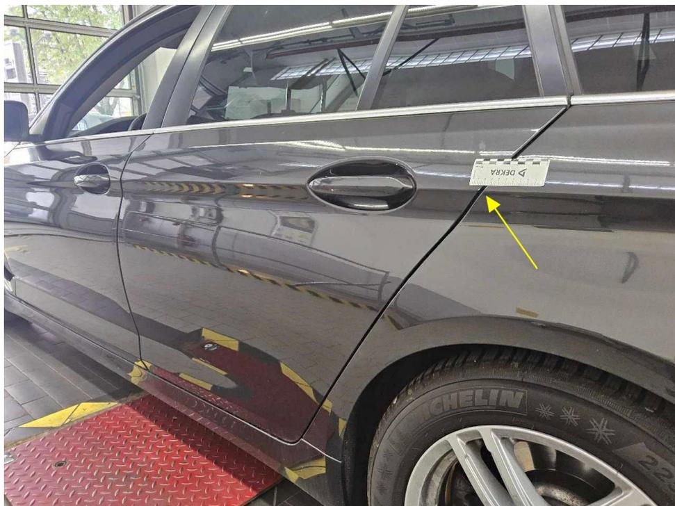
Bild 24 : Tür hinten links Kante, zerkratzt
