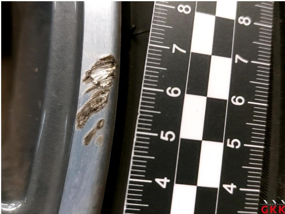
Bild 22 LM-Rad, 1 x beiliegend, verkratzt, ersetzen
