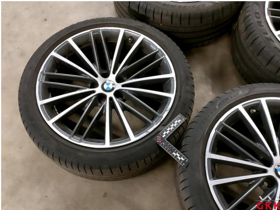
Bild 20 LM-Rad, 1 x beiliegend, verkratzt, ersetzen
