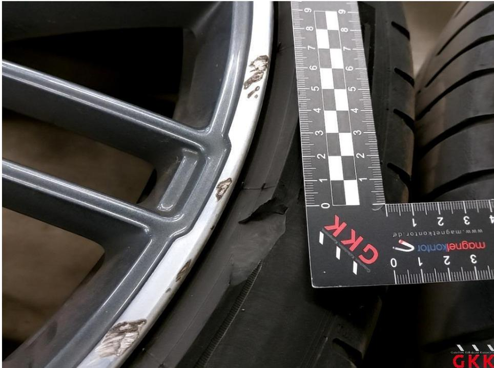
Bild 21 LM-Rad, 1 x beiliegend, verkratzt, ersetzen
