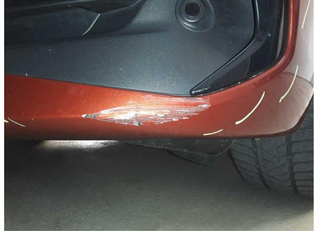
**Domage #9:** Pare-chocs avant: Pare-chocs avant - Eraflé - Remplacer
