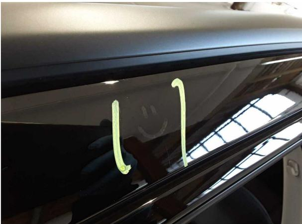
**Beschädigung #3:** Fahrzeugdach: Dachholm rechts - Lackmangel - instandsetzen und lackieren
