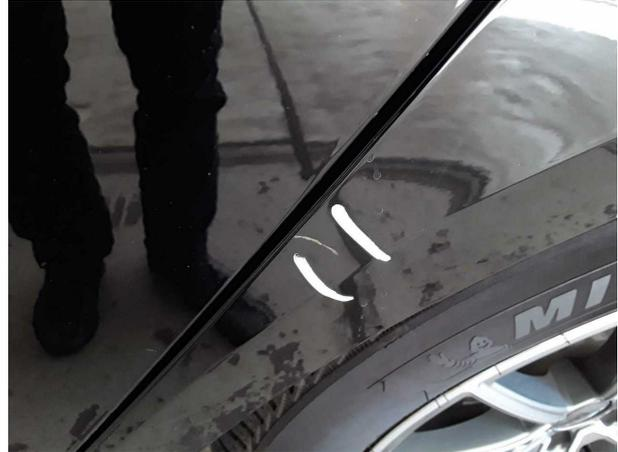
**Beschädigung #1:** Seitenwand links: Seitenwand - Kratzer - auslegen / polieren
