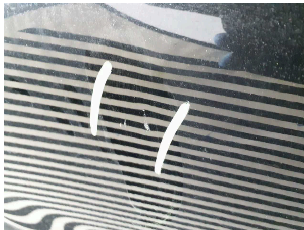
Domage #6: Porte ArD: Porte - Bosse, dommage peinture - Réparer et repeindre
