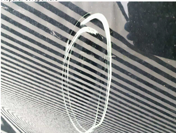
Domage #8: Porte AvD: Porte - Bosse, dommage peinture - Réparer et repeindre
