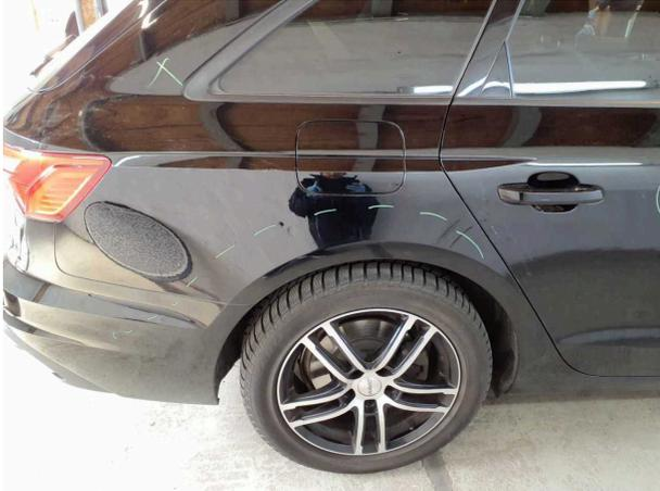
**Beschädigung #8:** Seitenwand rechts: Seitenwand - Kratzer - lackieren
