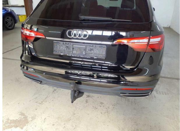
**Beschädigung #6:** Stossfänger hinten: Stossfänger hinten - verformt - instandsetzen und lackieren
