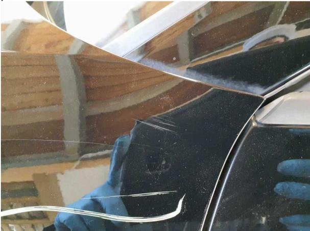
**Beschädigung #1:** Motorhaube: Motorhaube - Kratzer - auslegen / polieren
