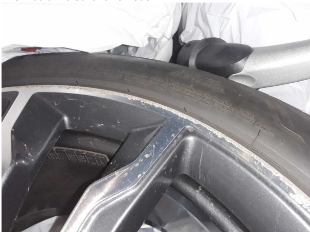
Beschädigung #2: 2.Radsatz: 1 Leichtmetallfelge (Materialabrieb) - verkratzt / verschürft - erneuern
