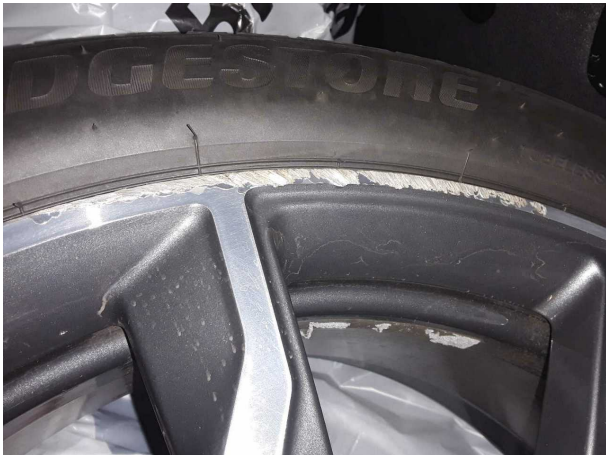
Beschädigung #1: 2.Radsatz: 1 Leichtmetallfelge (Materialabrieb) - verkratzt / verschürft - erneuern
