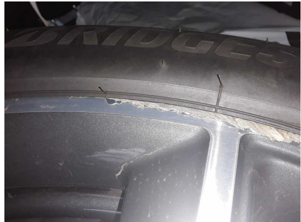
Beschädigung #1: 2.Radsatz: 1 Leichtmetallfelge (Materialabrieb) - verkratzt / verschürft - erneuern
