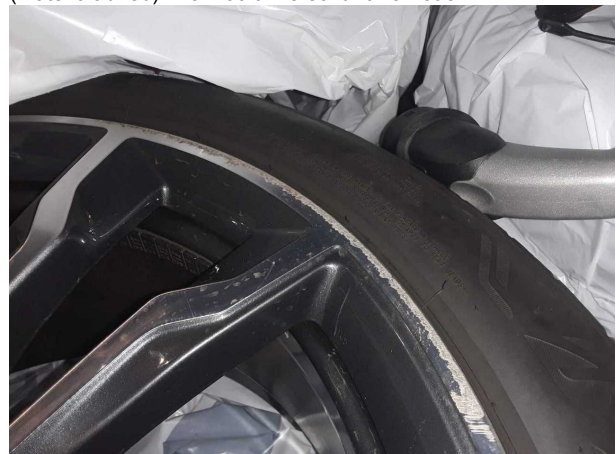
Beschädigung #2: 2.Radsatz: 1 Leichtmetallfelge (Materialabrieb) - verkratzt / verschürft - erneuern
