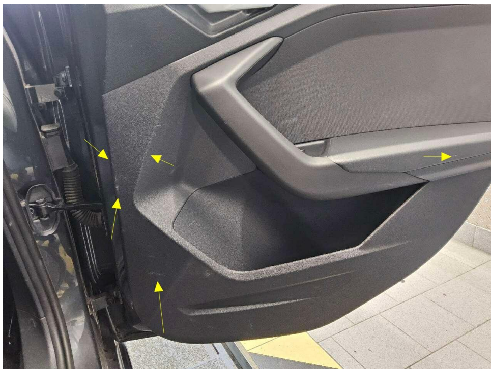
Bild 20 : Türverkleidung rechts verschrammt und eingerissen
