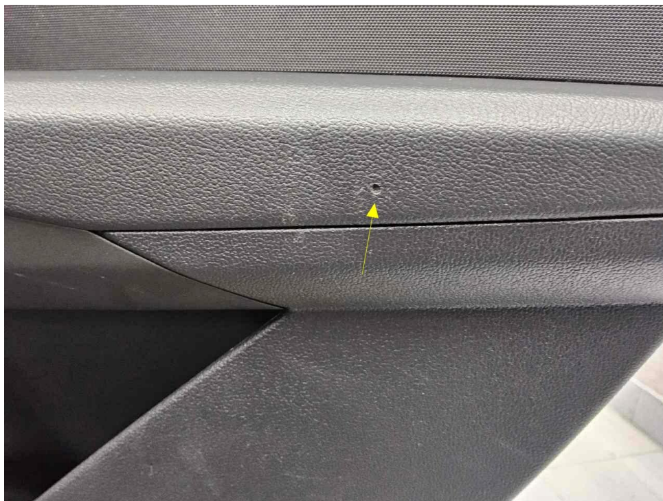
Bild 21 : Türverkleidung rechts verschrammt und eingerissen
