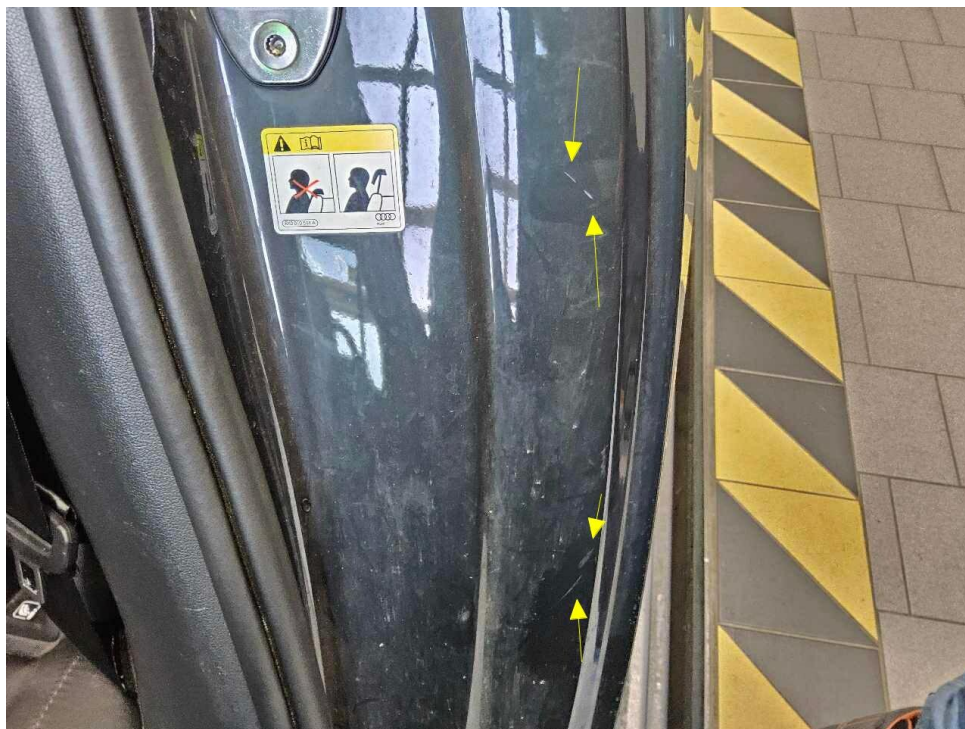
Bild 19 : Einstieg hinten links zerkratzt
