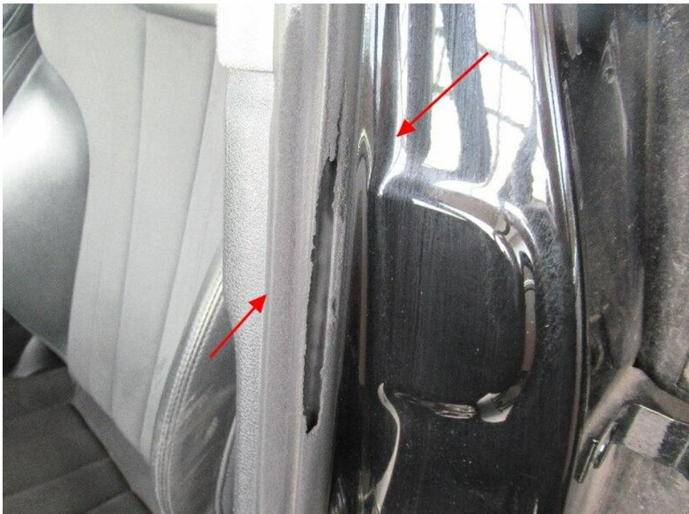
Bild 28 : Türdichtung vorne links beschädigt verschlissen eingerissen.
