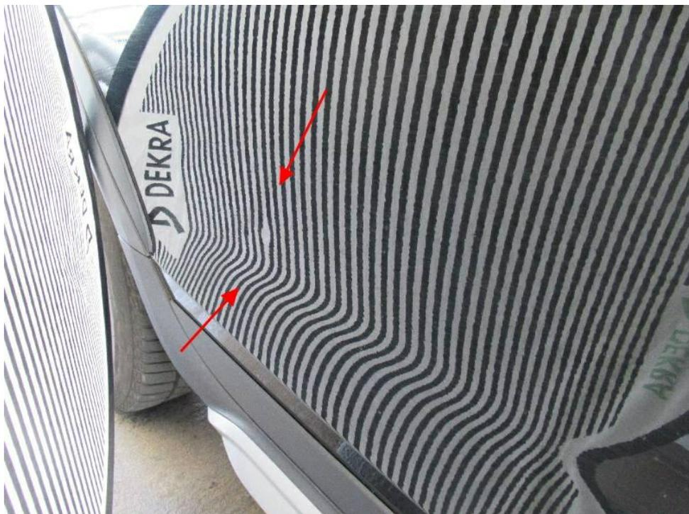
Bild 20 : Tür hinten rechts, deformiert, instandsetzen und lackieren mit Lackaufbau
