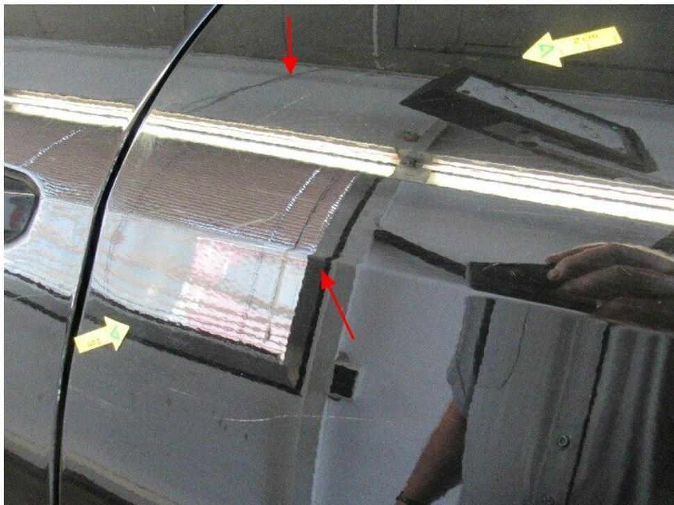
Bild 23 : Tür hinten links Lackierung, zerkratzt, Gebrauchsspur
