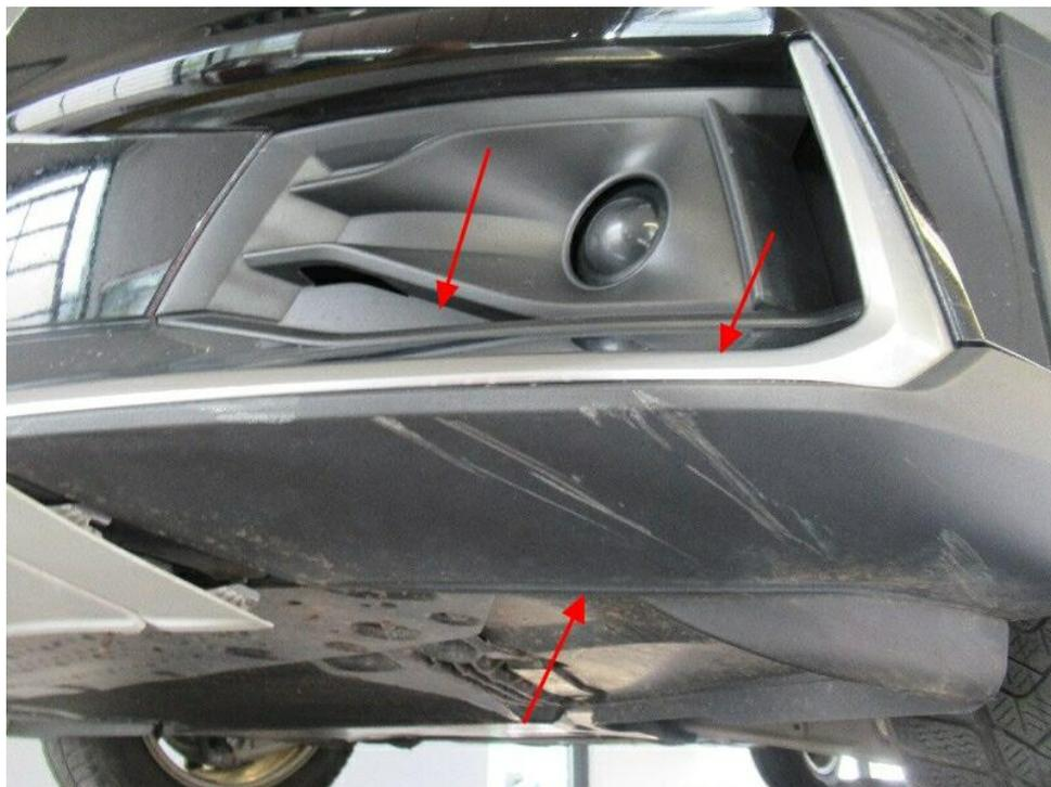
Bild 17 : Stoßfänger vorne: Spoilerleiste (Blende) links verkratzt.
