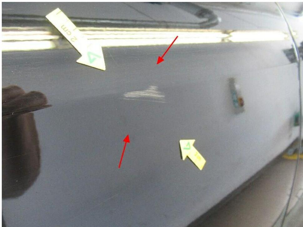
Bild 21 : Tür hinten rechts, deformiert, instandsetzen und lackieren mit Lackaufbau
