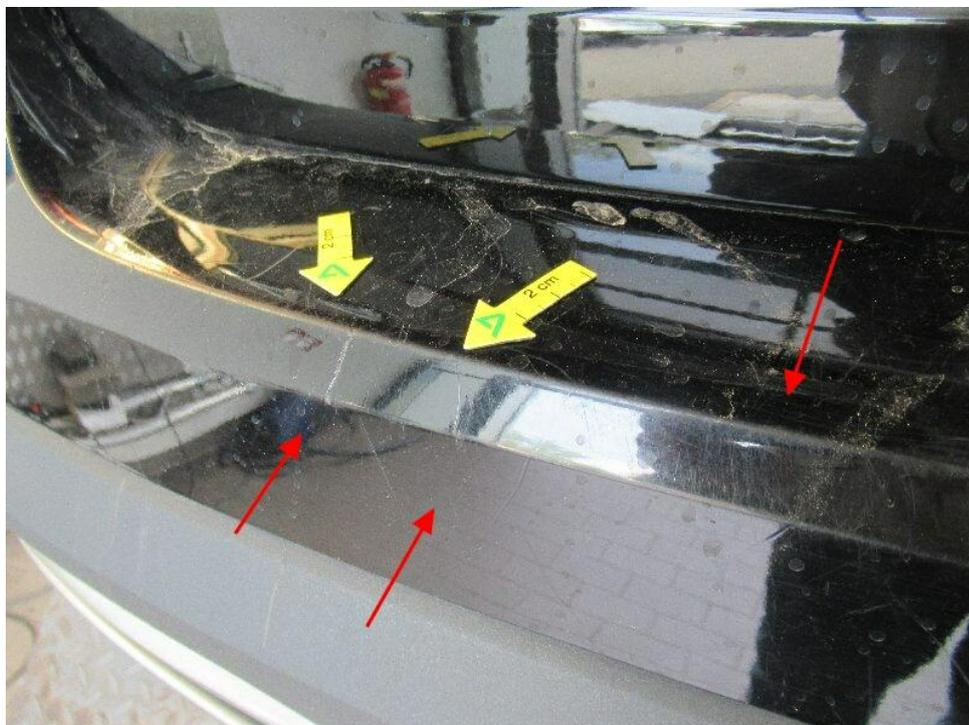
Bild 24 : Stoßfänger hinten Lackierung, zerkratzt, smart repair
