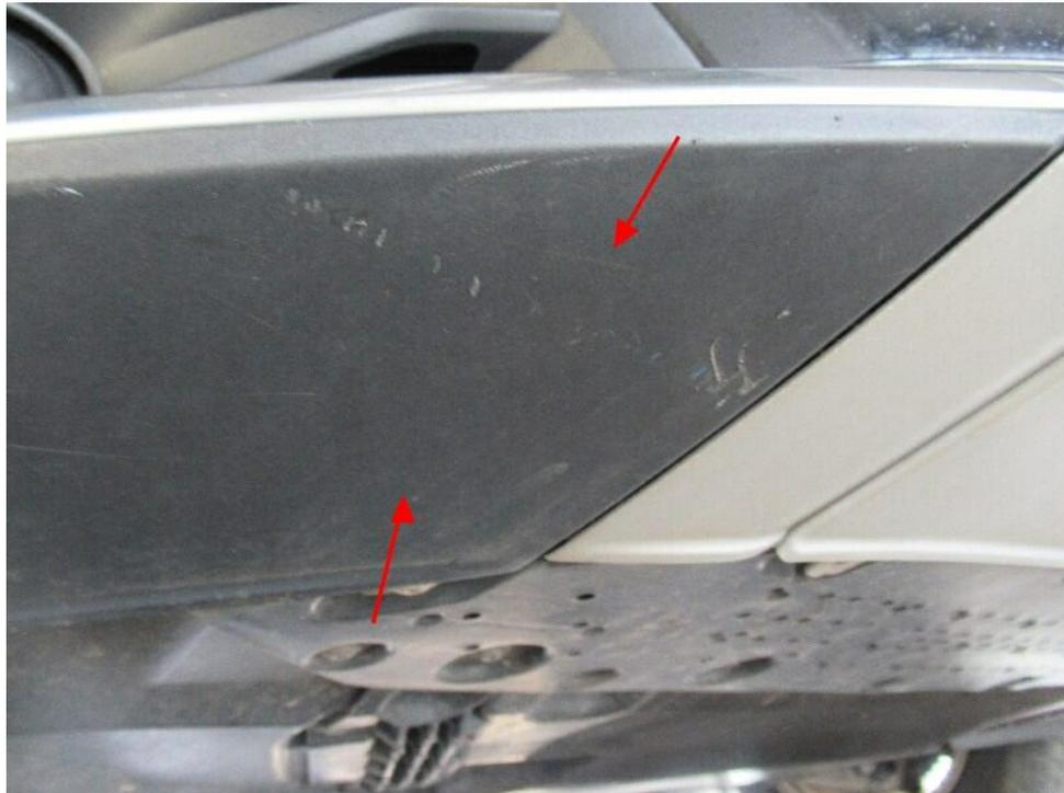
Bild 19 : Stoßfänger vorne: Spoilerleiste (Blende) rechts verkratzt.
