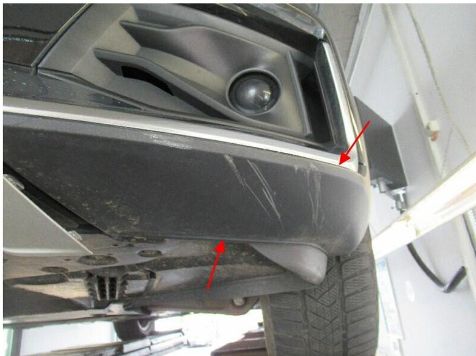
Bild 18 : Stoßfänger vorne: Spoilerleiste (Blende) links verkratzt.
