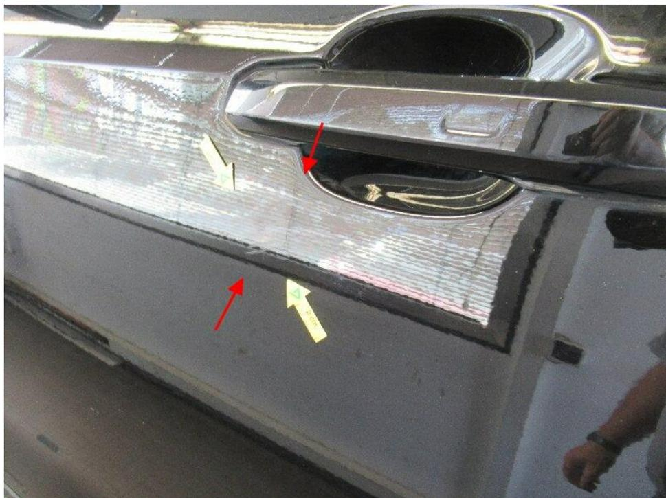
Bild 22 : Tür vorne links Lackierung, zerkratzt, Gebrauchsspur
