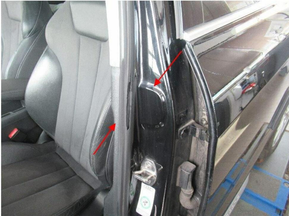
Bild 27 : Türdichtung vorne links beschädigt verschlissen eingerissen.
