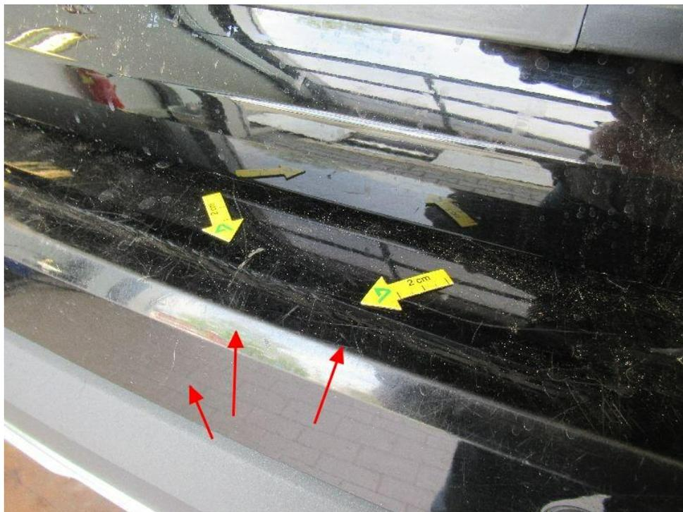
Bild 25 : Stoßfänger hinten Lackierung, zerkratzt, smart repair
