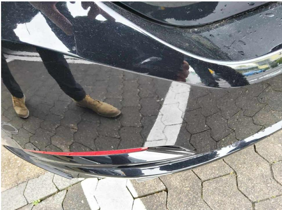
Bild 14 : Stoßfänger hinten Lackierung, zerkratzt, lackieren
