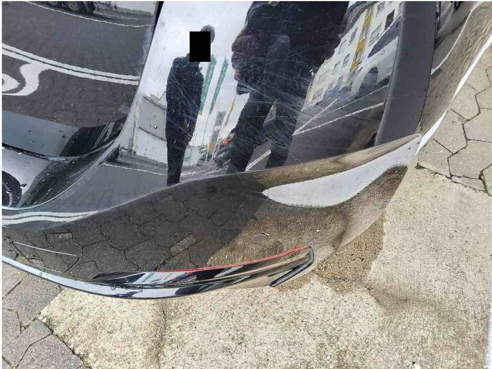
Bild 15 : Stoßfänger hinten Lackierung, zerkratzt, lackieren
