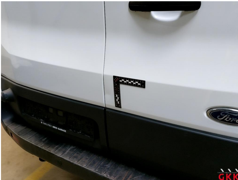
Bild 40 Hecktür rechts, beschädigt, Smartrepair
