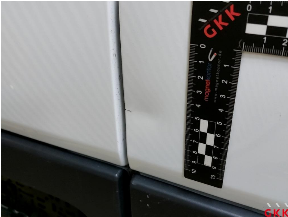
Bild 41 Hecktür rechts, beschädigt, Smartrepair
