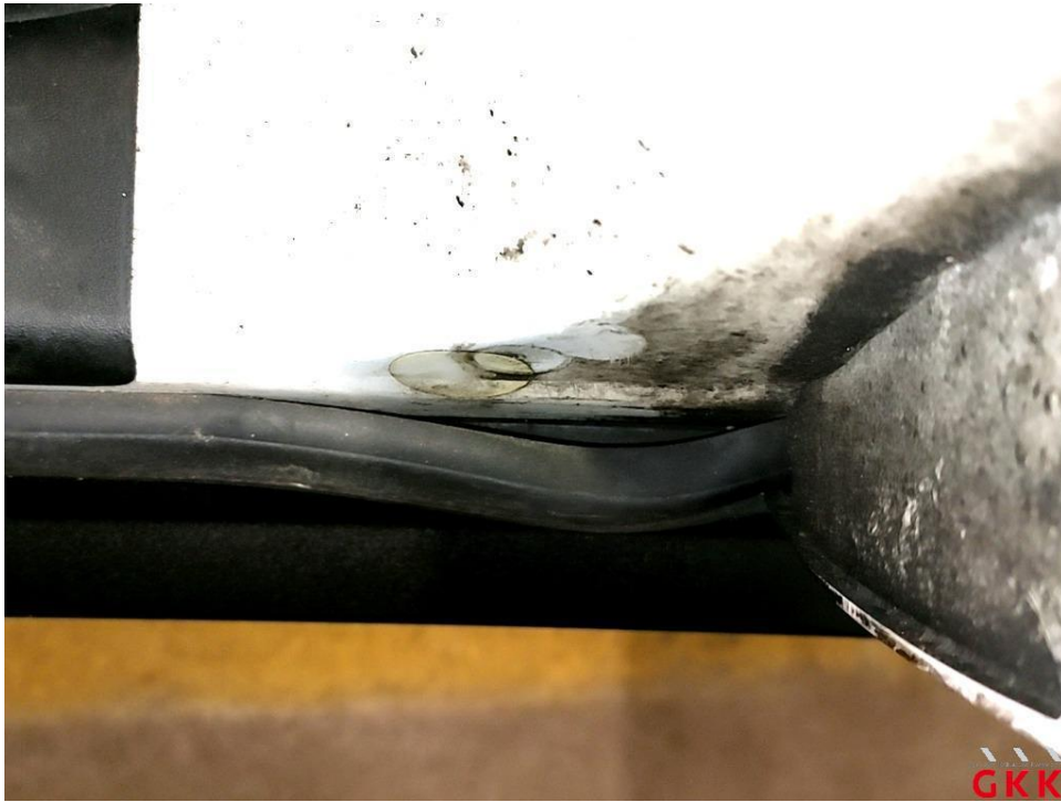
Bild 43 Tür vorne links, Dichtung -Einstieg-, lose, ersetzen
