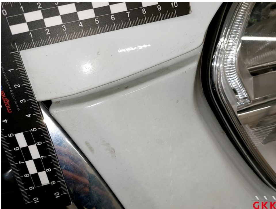
Bild 24 Fahrzeug, außen, Lackierung verwittert / matt, aufbereiten
