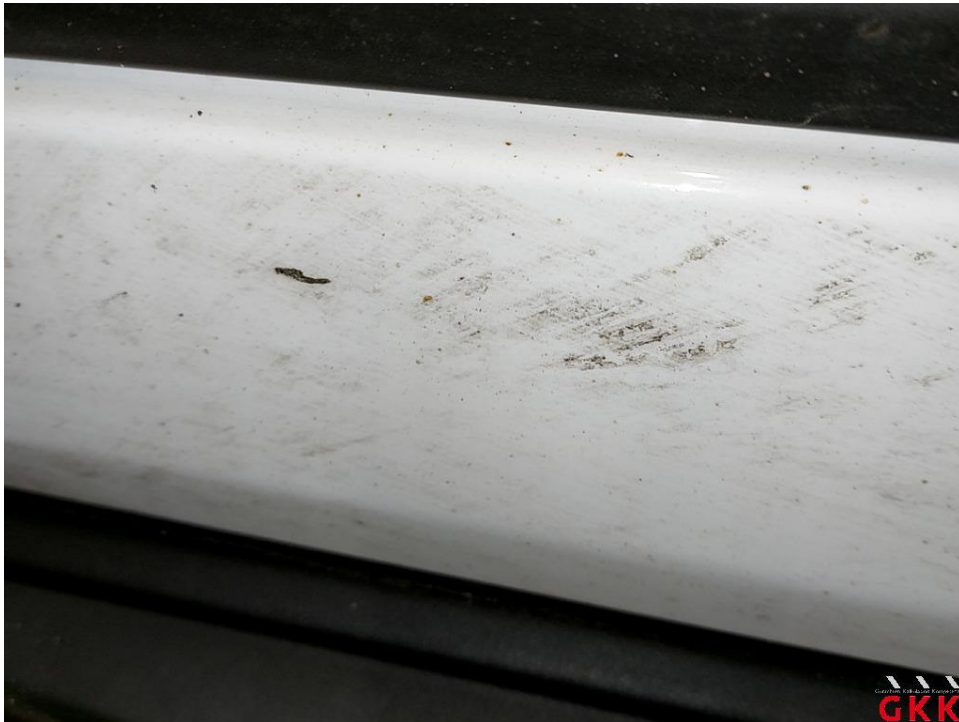
Bild 23 Fahrzeug, außen, Lackierung verwittert / matt, aufbereiten
