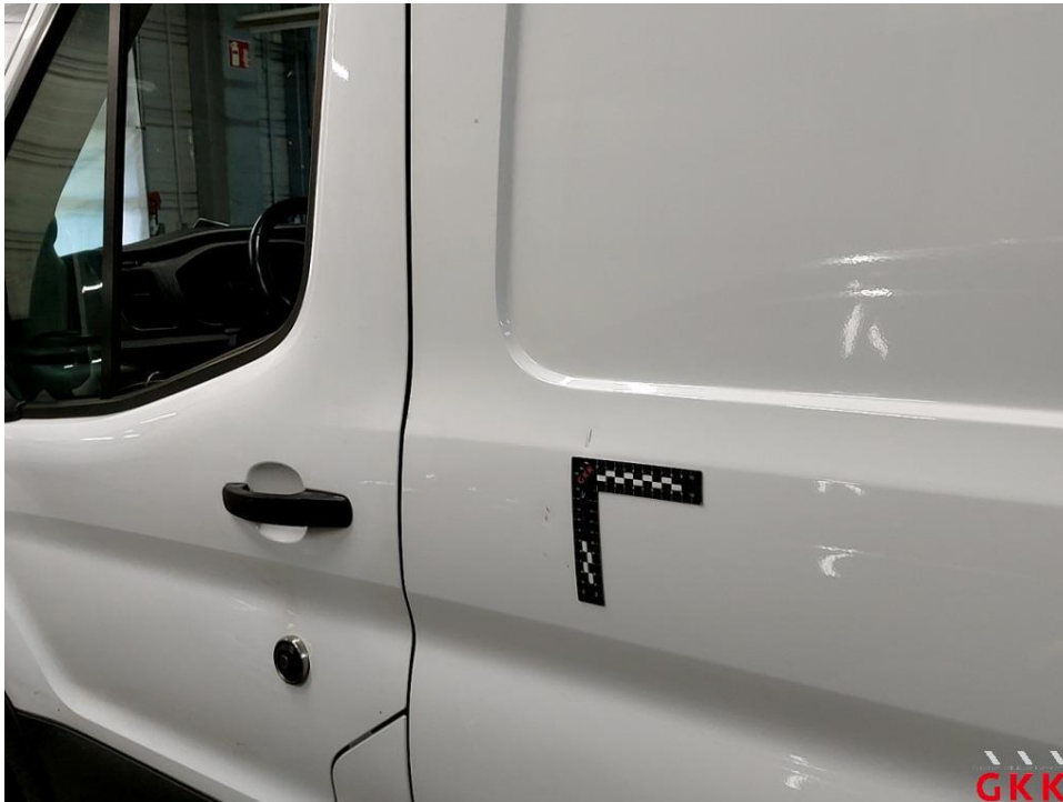
Bild 21 Seitenwand links, beschädigt, instand setzen - lackieren
