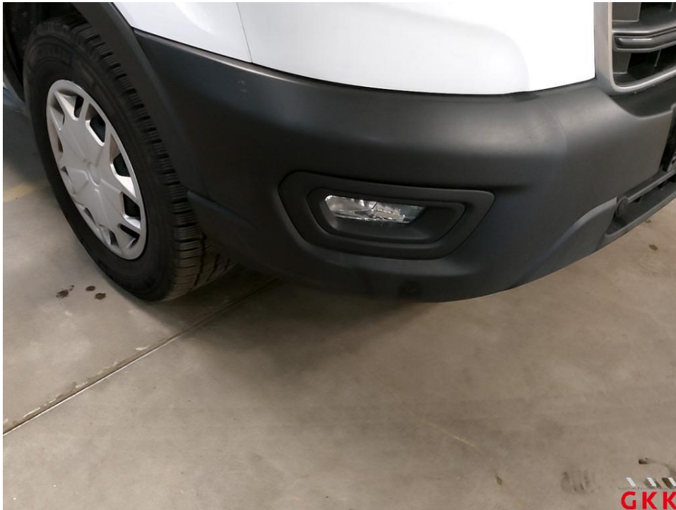
Bild 31 Stoßfänger vorne, Verkleidung -unlackiert-, verkratzt, ersetzen
