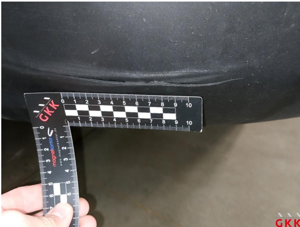
Bild 32 Stoßfänger vorne, Verkleidung -unlackiert-, verkratzt, ersetzen
