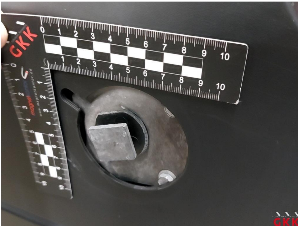
Bild 36 Anschlag / Hecktür links, fehlt, ersetzen
