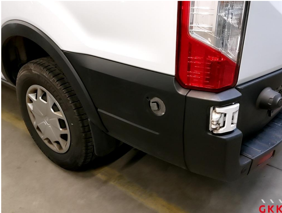
Bild 35 Anschlag / Hecktür links, fehlt, ersetzen
