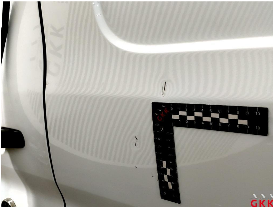
Bild 22 Seitenwand links, beschädigt, instand setzen - lackieren
